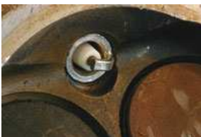
Безразличная, или «боковая», ориентация бокового электрода
