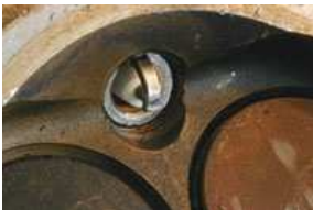
Искровой промежуток свечи открыт камере сгорания
