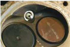
Боковой электрод свечи расположен открытой частью искрового зазора в сторону стенки камеры сгорания
