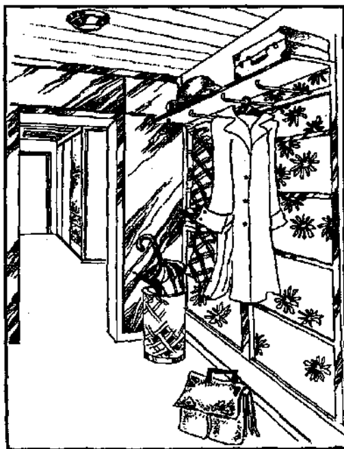
Рис. 82. Пример импровизированного проема, отделяющего прихожую от коридора, для устройства шкафов и антресолей
