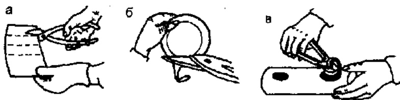
Рис. 44. Работа ножницами: а — положение руки на рукоятке при резании на полосы; б — вырезание левыми ножницами заготовки круглой формы; в — вырезание внутреннего криволинейного контура
