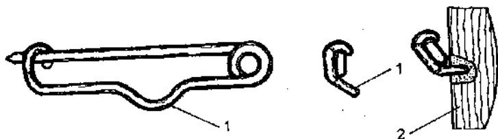
Рис. 176, Булавка для деревянной броши: 1 — выгиб; 2 — схема закрепления булавки
