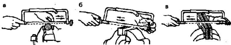
Рис. 46. Начало резки ножовкой круглого (а) и квадратного (б) металла; в ~ резка тонкого листа
