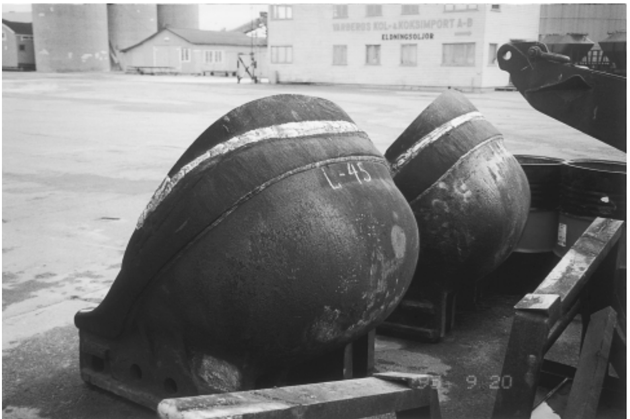
Многокофова драга. Съединяване на нов режещ ръб с ОК 68.82.
