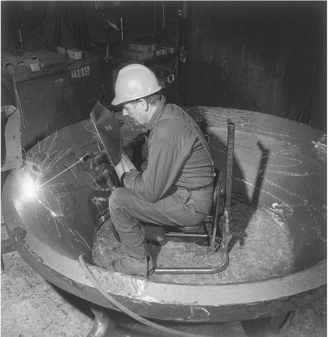
Ремонт на трошачка от 14% манганова стомана с ОК 86.08.
