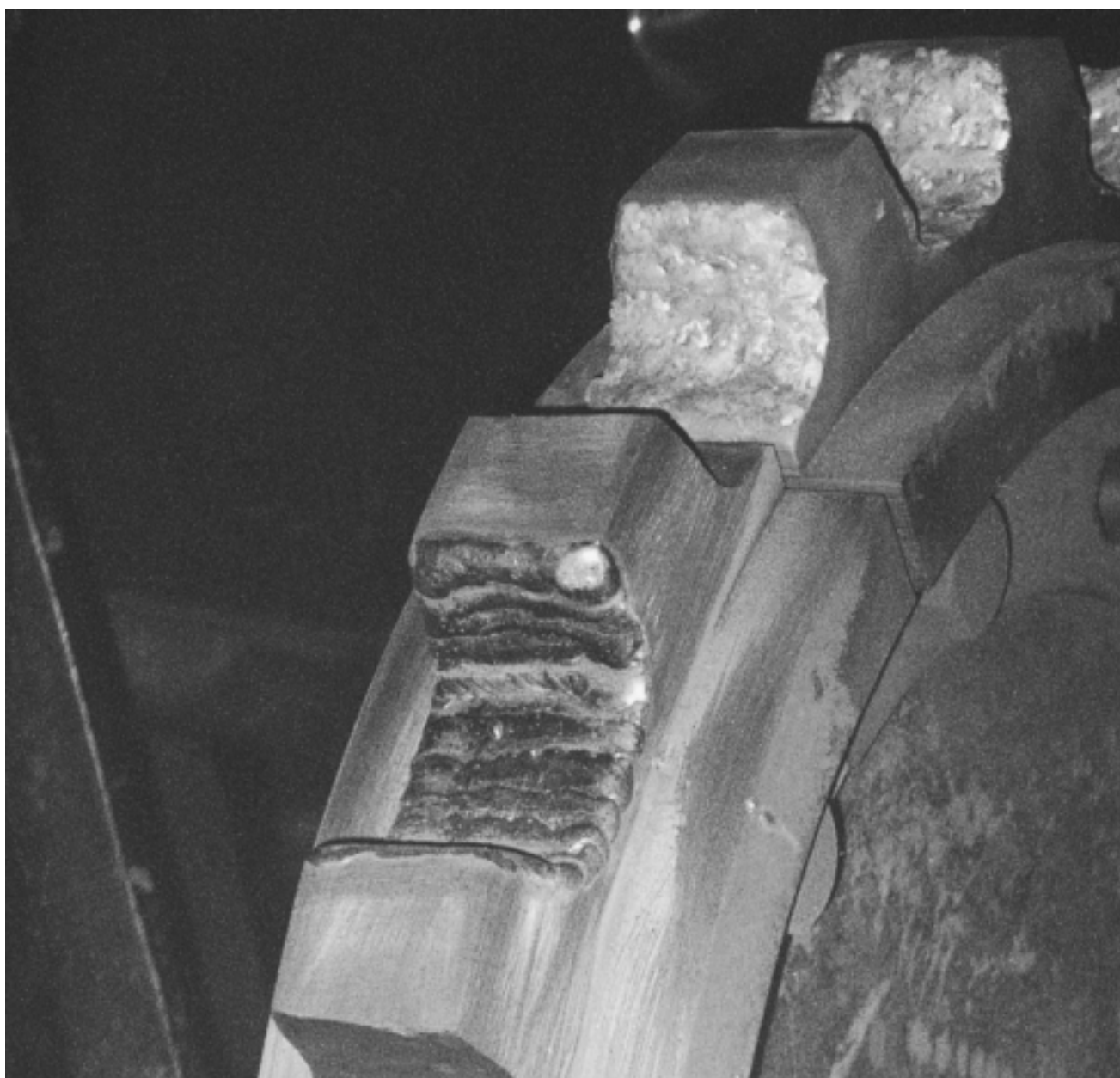
Задвижващо зъбно колело: превантивно наваряване с ОК 83.28.
