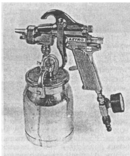
Для нанесения на поверхности материала клея отделочники часто используют пульверизаторы пистолетного типа. Обратите внимание — пульверизатор имеет манометр, что позволяет вам установить определенное давление. Если давление будет слишком высоким, клей станет выходить неровными струйками, напоминающими туман, а пузырями.
