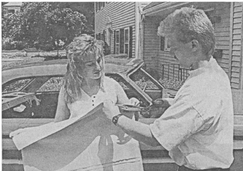
В то время как Келли держит сложенную пополам обивку потолка, Денни делает надрез спереди, это поможет ему не потерять среднюю линию в то время как он будет устанавливать обивку.
