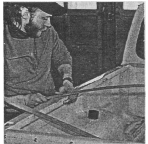
На глаз сделайте в планке изгиб примерно на 10 см. Для этого представьте прямую линию от одного края кузова до другого по верху. Затем согните дугу, чтобы она поднималась над воображаемой линией на 10 см. Сделайте отметку и отрежьте планку. Отрежьте вторую дугу такой же длины, чтобы обеспечить одинаковую высоту возвышения.
