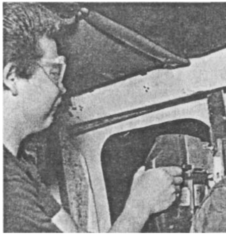
Окончательная подгонка внутри для планки боковины.
