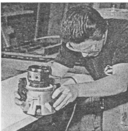
Быстрый проход по периметру набором для обработки ламината в роутере, и Барри обработал деталь за считанные секунды. Он закончит стачиванием острой кромки - ровно настолько, чтобы предотвратить опасность порезаться.
