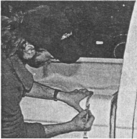
Джефф Прист установит застёжки в середине изгиба в верхней части кузова. Внутренний край кузова становится контрольной точкой. Таким образом результаты измерений остаются одинаковыми с обеих сторон.
