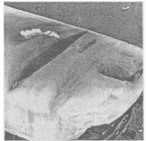
Нет, это не Большой каньон. Это всего лишь то, что происходит с поролоном, когда изнашивается обивка, а сиденье продолжает использоваться. Поролон нужно починить, иначе он будет торчать под новой обивкой.
