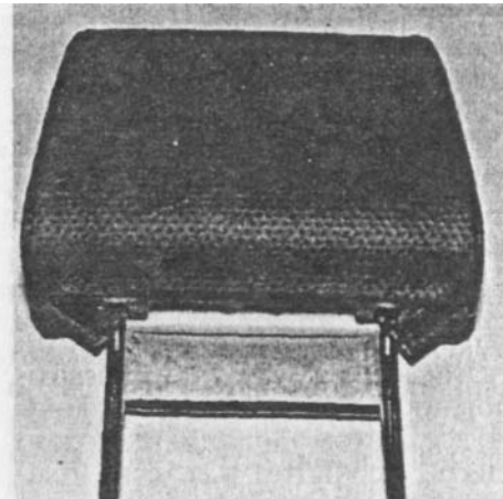
Сначала нам понадобится подголовник. Я начал снимать обивку, вытащив фиксатор из канавки.
