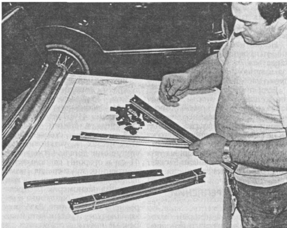
Не забудьте эти элементы жесткости для отверстий для шурупов. Без них будет слишком большое давление на прутья багажника и на листовую металл крышки багажника.
