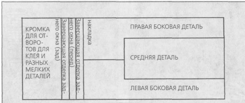
План раскладки, который Чарли использует для почти всех делаемых им псевдооткидных верхов: он немного необычен, но вы можете понять, насколько рационально используется материал.
