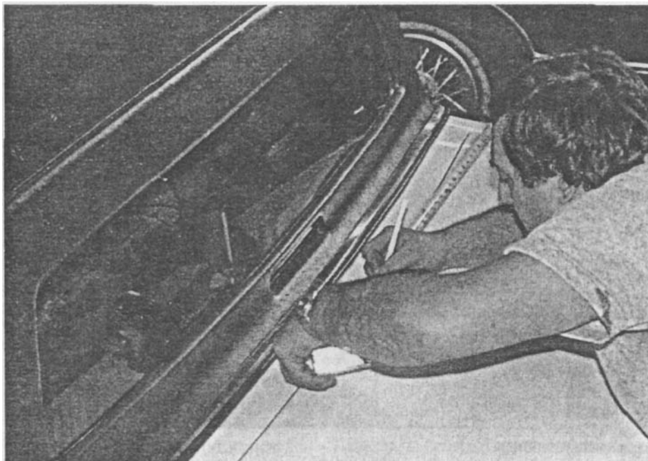
Почти каждый этап работы триммера начинается с определения средней линии. Установка багажника - не исключение.
