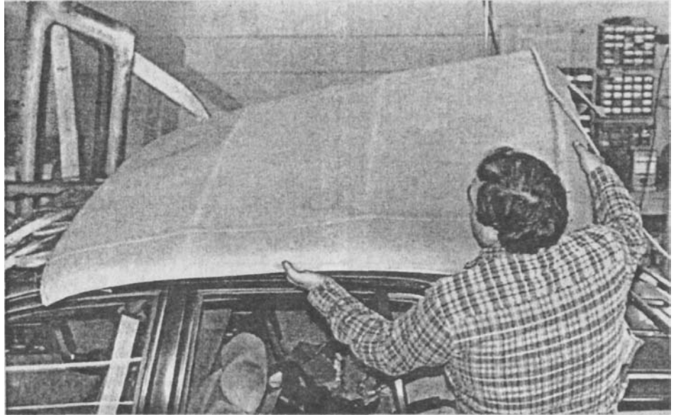
Когда все силиконовое соединение будет перерублено, верх с крыши сможет снять один человек.
