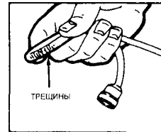
ПРОВОДА СВЕЧЕЙ ЗАЖИГАНИЯ МОГУТ БЫТЬ ОСМОТРЕНЫ ВИЗУАЛЬНО СКРУЧИВАЯ ИХ В ПЕТЛИ ВОКРУГ ПАЛЬЦЕВ ЭТО ОБНАРУЖИТ ТАКИЕ ДЕФЕКТЫ КАК ТРЕЩИНЫ, ПРОГАРЫ ИЛИ РАЗРУШЕНИЕ ИЗОЛЯЦИИ ЛЮБОЙ ПРОВОД С ПОВРЕЖДЕННОЙ ИЗОЛЯЦИЕЙ ДОЛЖЕН БЫТЬ ЗАМЕНЕН
