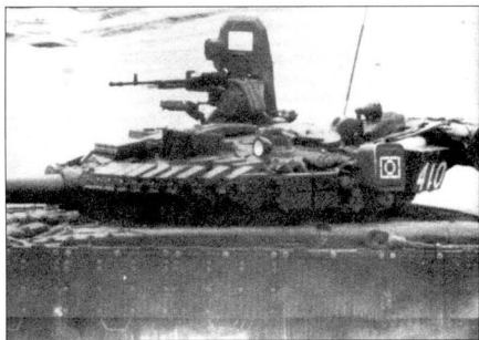
Башня Т-80БВ. Присмотревшись, можно заметить детали комплекса «Кобра».
