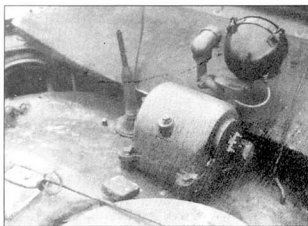
Анемометр и позиционный огонь за задней стеной башни. При стрельбе с помощью анемометра вносится поправка на ветер.
