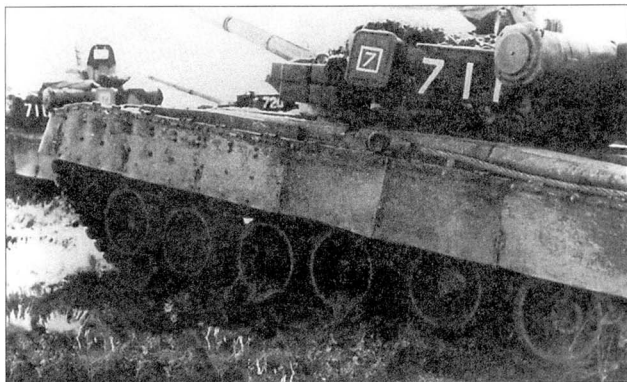
Взвод танков Т-80БВ на маневрах. Труба за башней - шноркель ОПВТ - неизменный атрибут советских танков.
