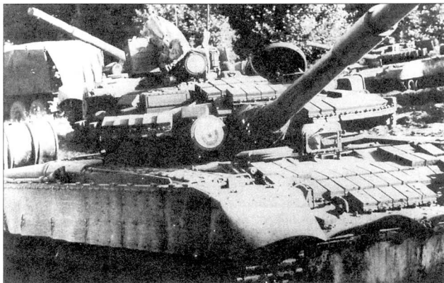
T-80BV. Обратите внимание, что элементы динамической защиты не наложены прямо на броню, но отстоят от нее на два сантиметра.
