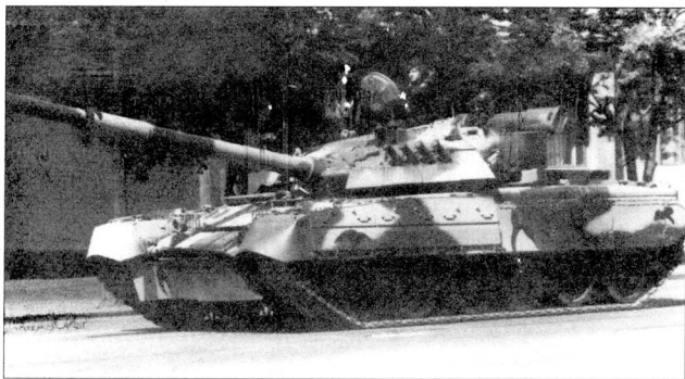
Т-80УД в московском пригороде. На бортах танка имеются небольшие скобы, облегчающие экипажу доступ к машине.
