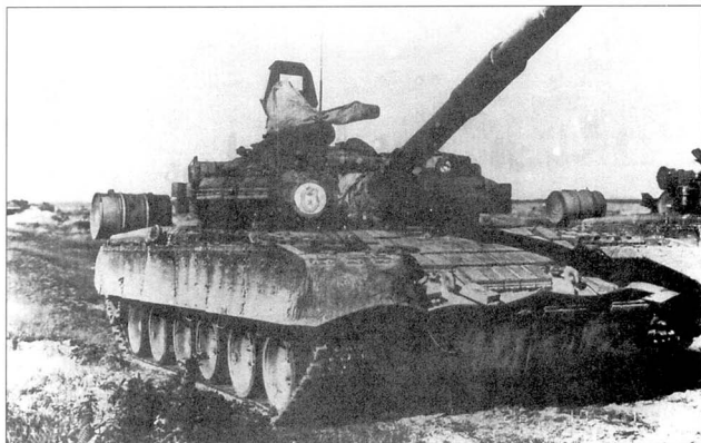
Танк Т-80БВ, оснащенный прожектором «Луна». В некоторых гвардейских танковых дивизиях тактические номера помещали на обратной стороне крышки прожектора.
