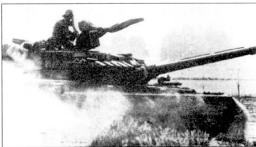
Т-80, движущийся на полной скорости. Место командира танка оборудовано щитком, защищающим от пыли и ветра.
