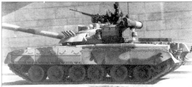
Снимок Т-80У во время парада. Эти танки не несут на башне крышки для воздухозаборников для шпиркельной установки ОПВТ, как это имело место у Т-80Б.
