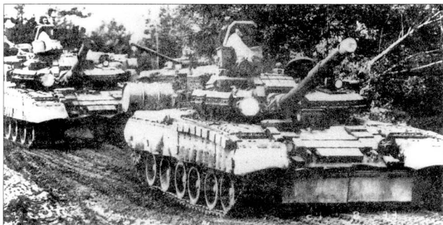
Рота танков Т-80БВ на марше. Борта переднего танка частично закрыты динамической защитой.
