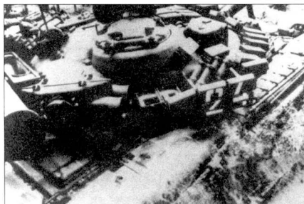
Вид сверху на T-80BV. Сразу позади башни крепятся две крышки на воздухозаборники. Эти крышки применяются при подводном вождении танка - к ним крепятся шпorkельные трубы.
