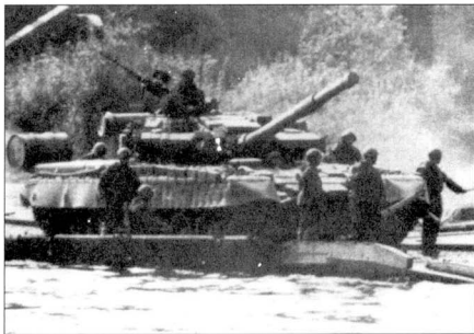
Т-80, оснащенный динамической защитой, обозначается как Т-80БВ.
