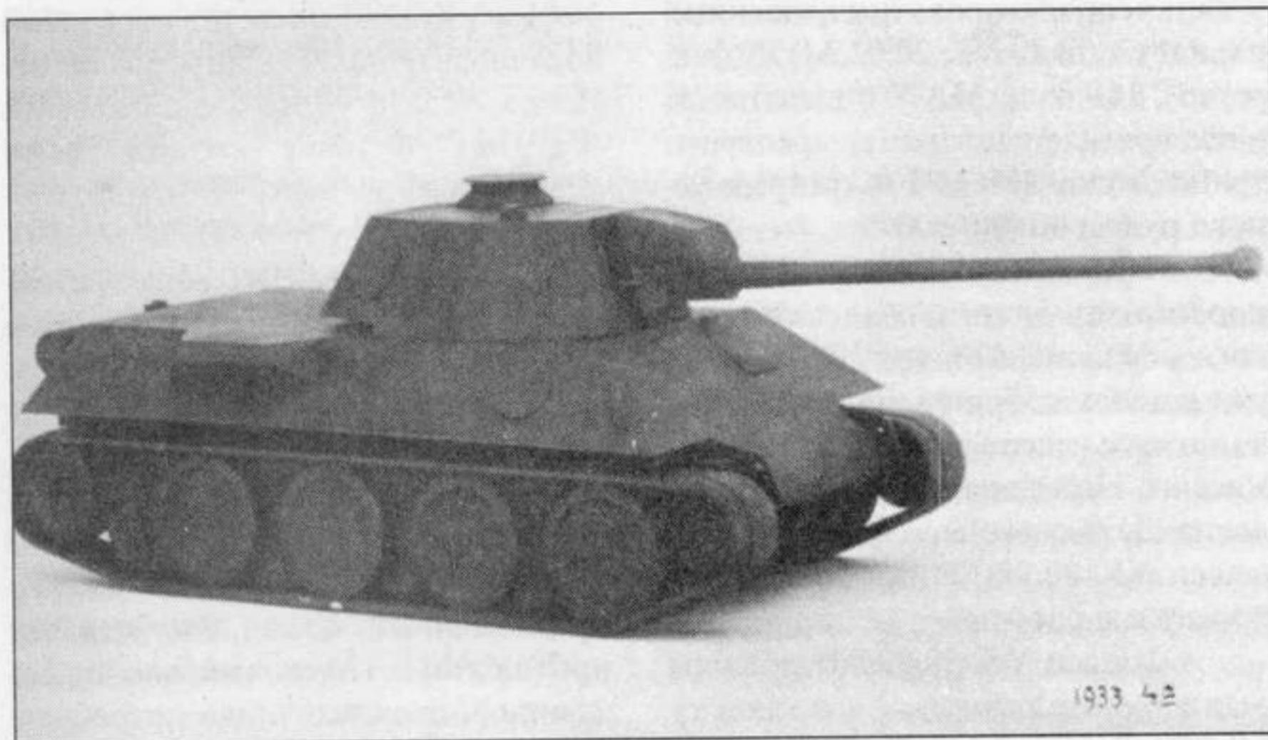
Танк VK 30.01(D), разработанный фирмой Daimler-Benz. Внешне танк представляет собой копию советского Т-34. Вооружен 75-мм пушкой 7,5 см KwK 42. На фото представлена деревянная модель, выполненная на фирме Daimler-Benz.
