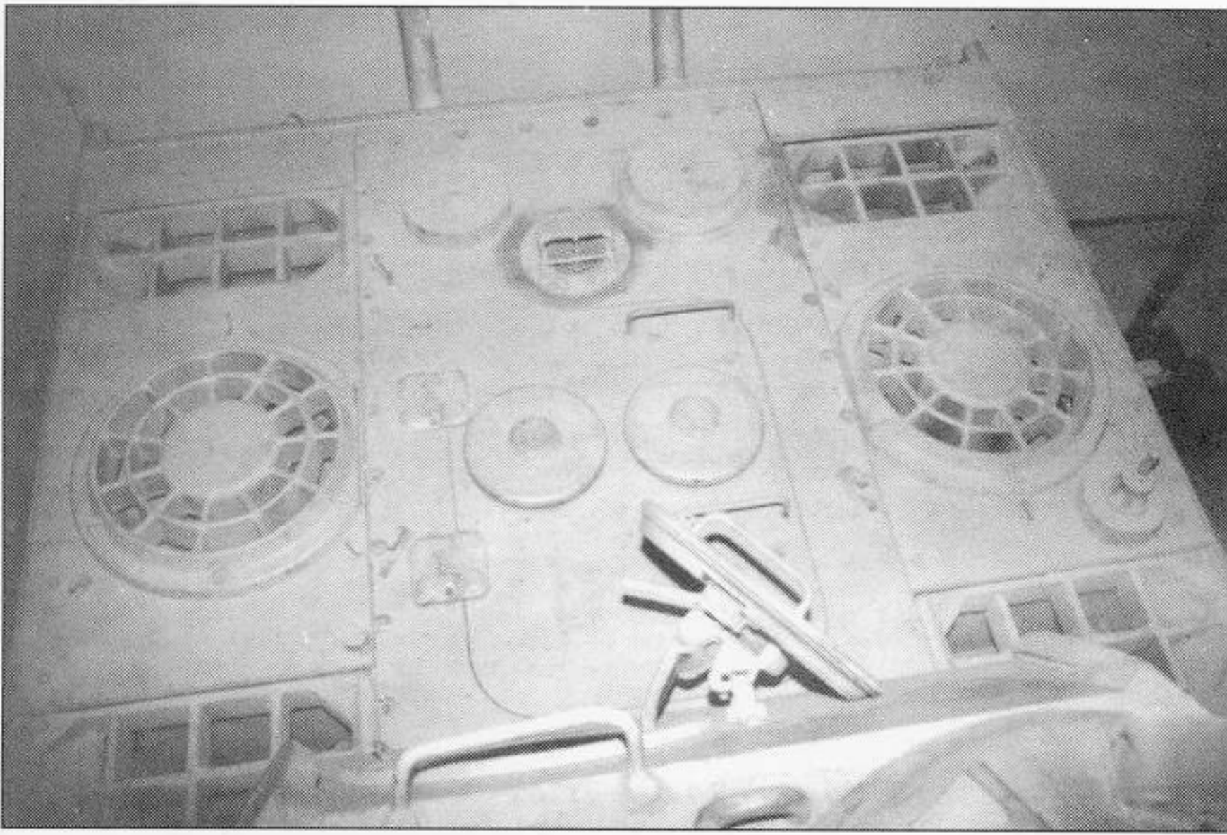
Надмоторная бронеплита. Видны воздухозаборники. Эту плиту спроектировали для Panther II, а позднее применили на танке Panther Ausf. G.
