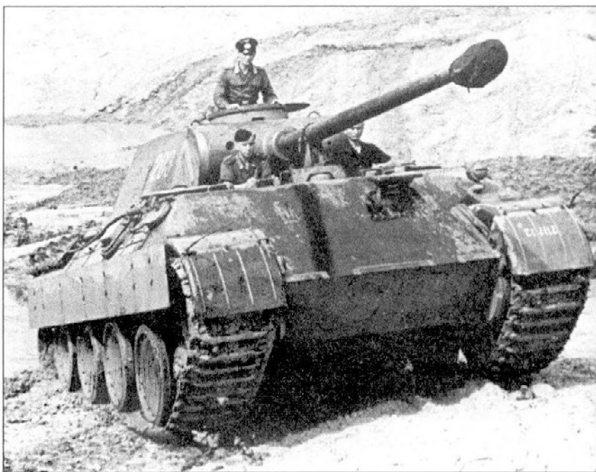
Panther Ausf. D (Fgst.Nr. 211213) тактический номер 203, выпущена фирмой Daimler-Benz в августе 1943 года. Танк имеет только левую фару, а к командирской башенке приварено кольцо для крепления зенитного пулемета.
