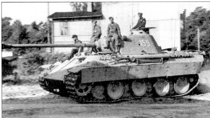
Befehls-Panther Ausf. D (тактический номер 155) представляет собой последний вариант танка Ausf. D. Танк покрыт циммеритом, опорные катки усилены и имеют 24 болта. Над отверстиями для объективов прицелов на маске пушки наварен отлив. Запасная антенна хранится в контейнере на левом борту, вместе с канистрой для банника.
