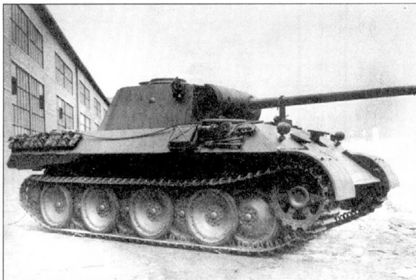
Одна из первых пяти Panther Ausf. D, собранных фирмой MAN в Нюринберге в январе-феврале 1943 года. Обратите внимание на характерное расположение на броне дополнительного оборудования, а также на отсутствие крепления для юбки (Schuerzen).
