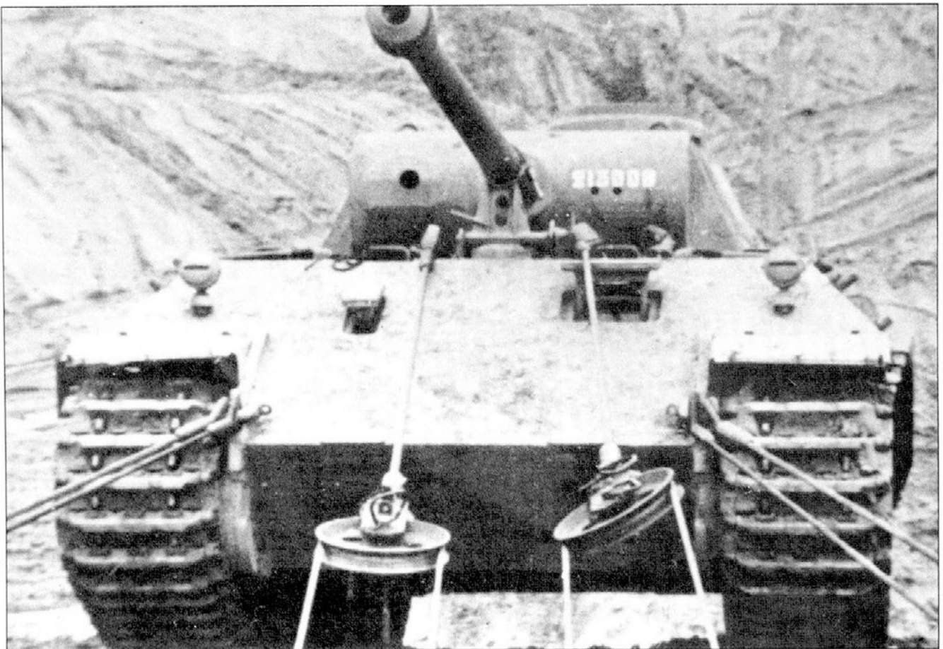
Три 18-ти тонных тягача буксируют «Пантеру» Ausf. D во время ходовых испытаний.
