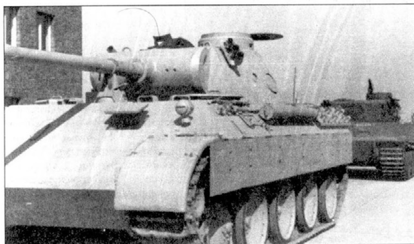
Эти Panther Ausf. D выпускались вместе с «Тиграми» фирмой Henschel в начале мая 1943 года. Эти танки еще оснащены дымовыми шашками. Бойницы в бортах башни сверху прикрыты отливами. Танк оснащен двигателем Maybach HL 210 P30.
