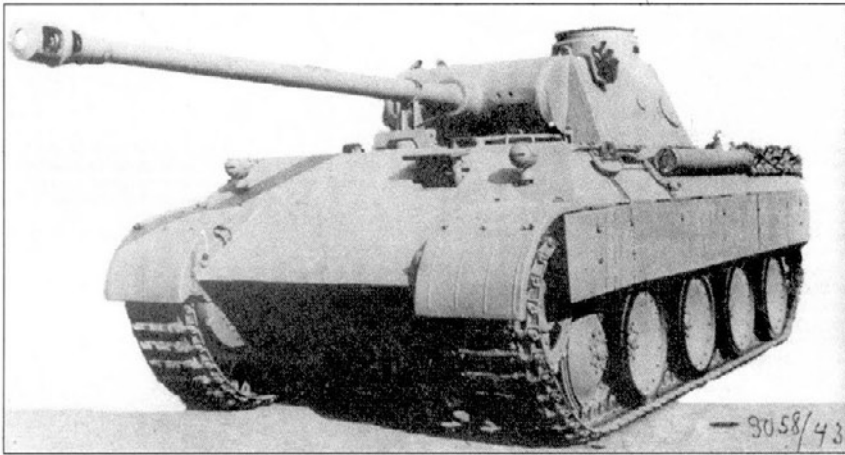
С апреля 1943 года вдоль бортов «Пантеры» стали навешивать юбку (Schuerzen). Листы юбки предназначались для защиты бортов от огня противотанковых ружей.
