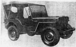
Фиг. 10. Легковой развлекательный командирский автомобиль американской фирмы Виллис, модель MB (4×4)
