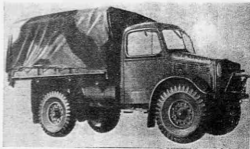
Фиг. 5. Армейский 1\frac{1}{2} -т грузовик английской фирмы Белфорда, модель OXD (4×2)
