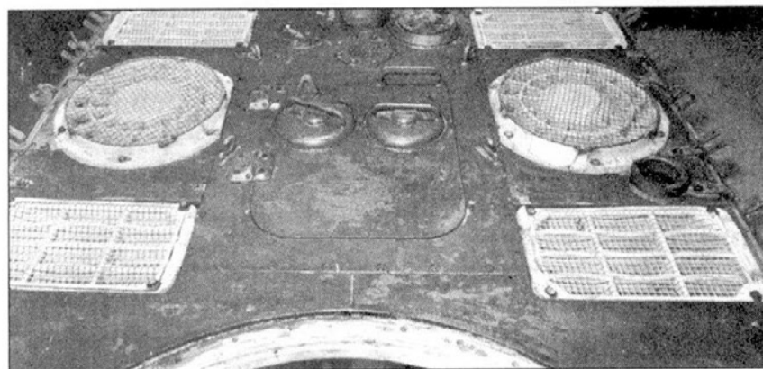
Надмоторная плита танка Panther Ausf. A (Fgst.Nr. 210651, собранного фирмой MAN в январе 1944 года. У левого воздухозаборника радиальный рисунок решетки, у правого - спиральный. Бронированный цилиндр, защищающий основание антенны радиостанции FuG 8 расположен посередине в задней части надмоторной плиты.
