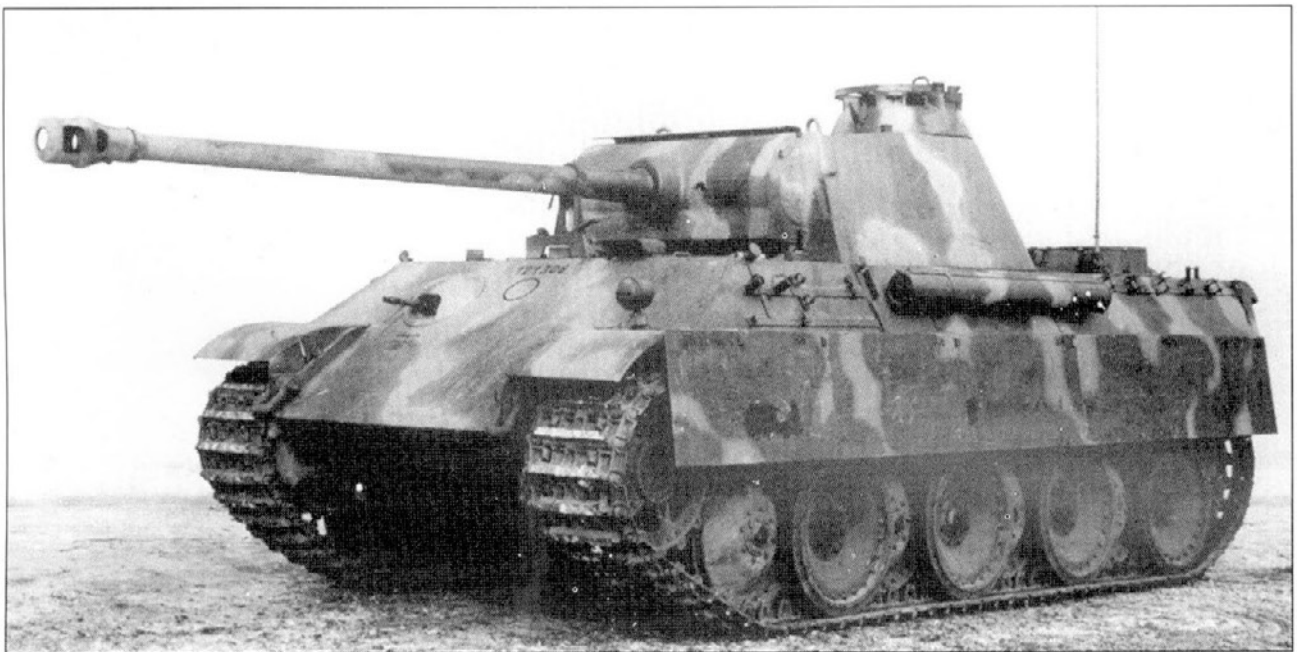
Танк Panther Ausf. G (Fgst.Nr.121306, собранный фирмой MAN 11 декабря 1944 года). Танк проходил испытания в WaPruef 6. Машина оснащена маской с «подбородком» и обогревателем боевого отделения (Kampfraumheizung). В цилиндрическом контейнере на борту хранится банник и запасные антенны.
