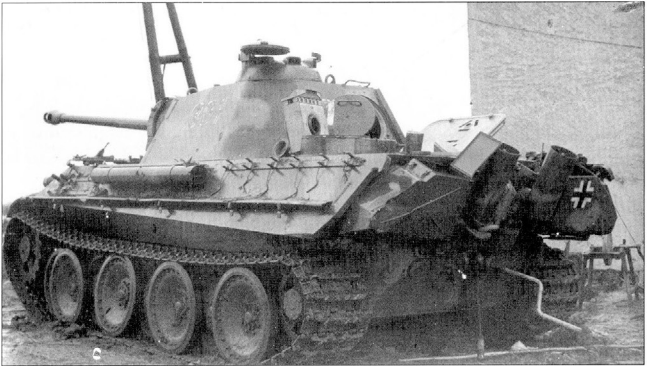
Танк Panther Ausf. G тактический номер 301. У танка маска пушки с «подбородком», нет циммеритового покрытия, выхлопные трубы оснащены пламегасителями, на надмоторной плите смонтировано устройство обогрева экипажа, направляющие колеса нового типа.
