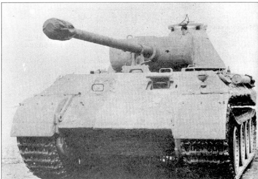
Танк Panther Ausf. A, собранный фирмой MAN в январе 1944 года. В бортах башни нет бойниц. В то же время отсутствует установка ближнего боя (Nahverteidigungswaffe), монтируемая в задней правой части башни.
