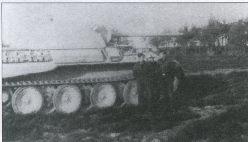
«Пантера» Ausf. D на полигоне Графенвёр, апрель 1943 года. Этот танк поступил в 51-й танковый батальон. В коробке на правом борту корпуса хранятся инструменты для ремонта гусениц. Такая коробка имела только на танках первой производственной серии. Номер 135 сделан белой краской и виден сразу за дымовым гранатометом.
