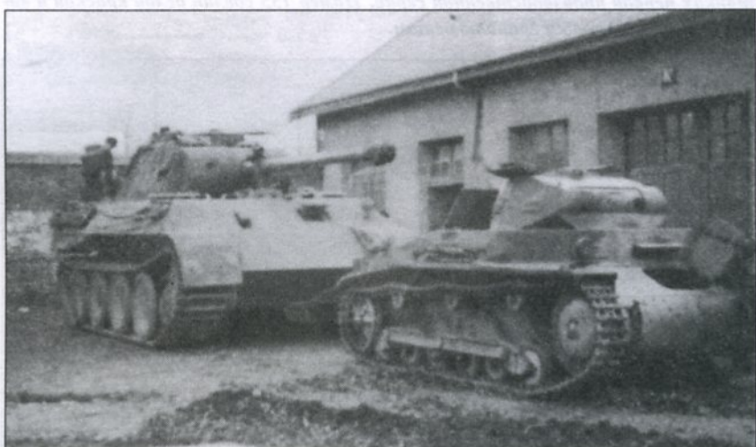
24-й танковый полк сформировали в 1943 году. После года на фронте полк отправили во Францию для пополнения. Фотография сделана вскоре после того, как полк прибыл на полигон Вуссер. «Пантера» на фотографии - Ausf. D поздних выпусков. Командирская башенка имеет кольцо для зенитного пулемета. Дымовые гранатометы сняты. На ствол пушки установлен имитатор орудийного огня.
