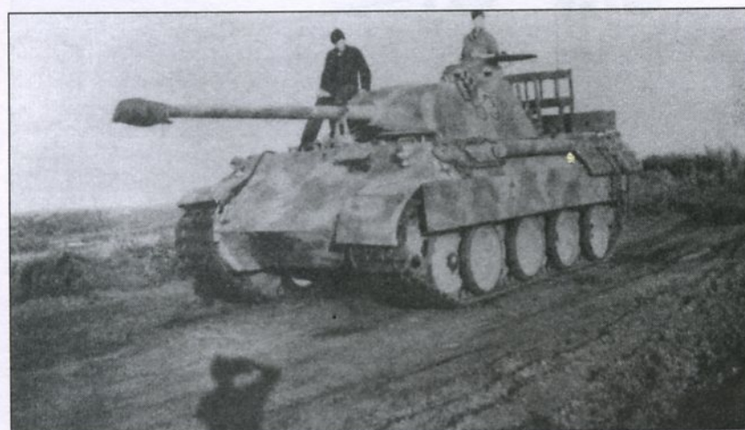
«Пантера» Ausf. D первой серии. Танк не имеет циммерита. Экипаж оснастил свою машину трапом и деревянным стеллажом. Танк имеет довольно сложный трехцветный камуфляж. Камуфляж на танк накладывали сами танкисты, руководствуясь условиями местности, в какой предполагалось эксплуатировать машину.
