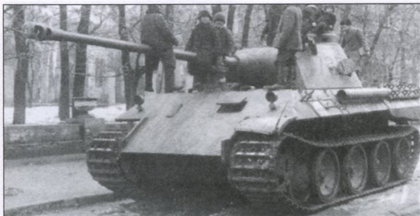
Советские ребята играют на брошенной «Пантере» Ausf. D № 735 из 52-го батальона. Внешне танк почти не поврежден. Смотровой прибор механика-водителя приоткрыт. Хотя обзор с места водителя был достаточно хорош, смотровой прибор ослаблял лобовую броню. Обратите внимание на то, что люк для переговоров на борту башни открыт.
