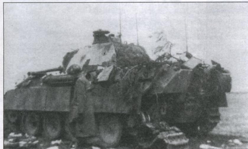
PzVfWg Panther Ausf. G, потерянная на Западном фронте. Видны три антенны. Один снаряд пробил борт башни, в результате чего с борта осыпался циммерит. Кроме того, танк потерял левую гусеницу.
