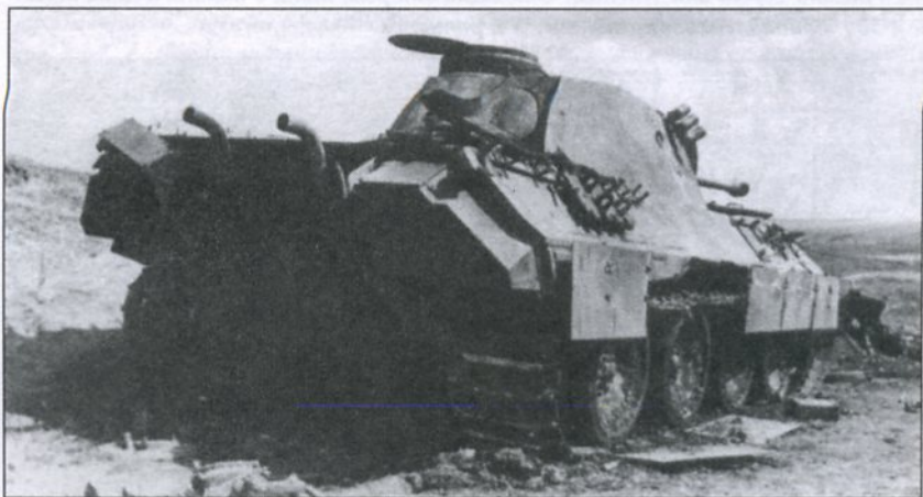
«Пантера» Ausf. D, потерянная в ходе операции «Цитадель». Два бортовых экрана отвалились.
