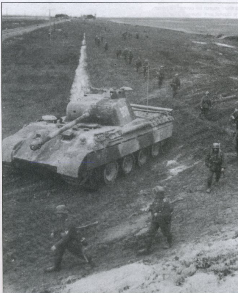
Эта «Пантера» Ausf. A из 5-й танковой дивизии СС «Викинг» оснащена монокулярным прицелом. Большинство «Пантер» Ausf. A получили циммеритовое покрытие уже на заводе. Танк камуфлирован большими зелеными и коричневыми пятнами поверх желтого основного цвета.
