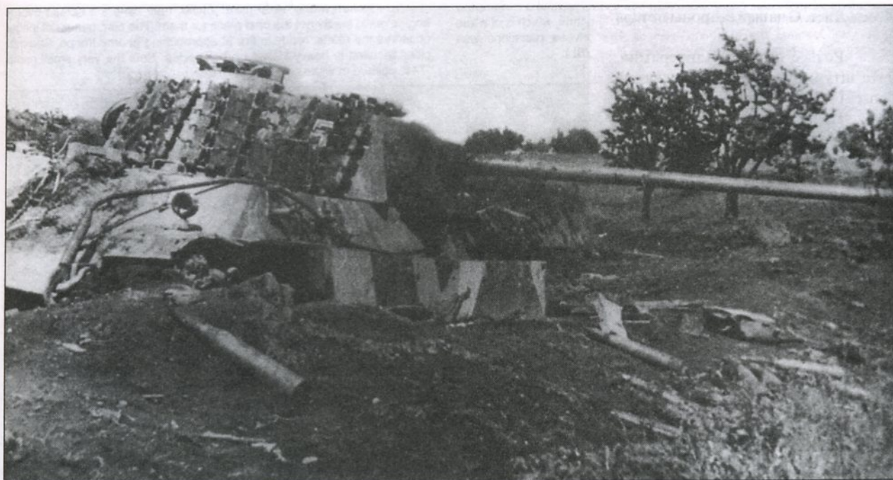
«Пантера» Ausf. G, подбитая под чехословацким городом Высков. Маска пушки с «подбородком». Номер «215» нанесен прямо поверх гусеничных траков, навешенных по бортам башины. Камуфляж диагонального типа.
