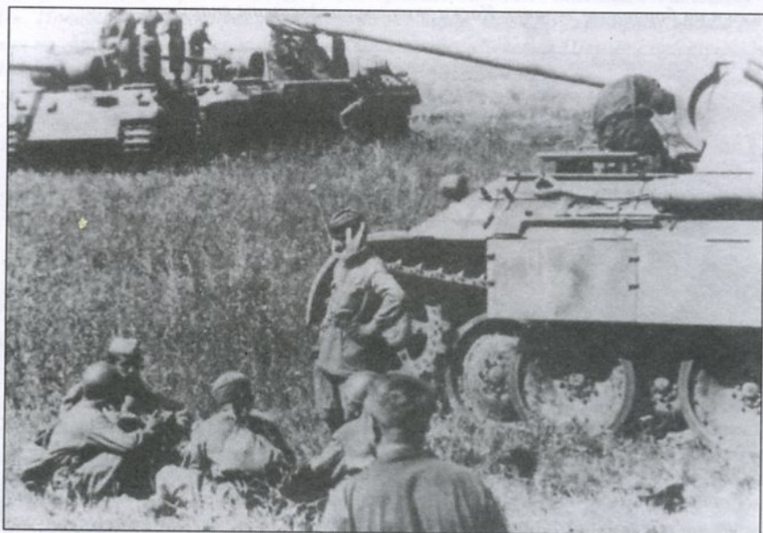
«Пантеры» Ausf. D после боя. Видны дымовые гранатометы, хотя некоторое дополнительное оборудование отсутствует. Слева на земле сидят несколько военнопленных.
