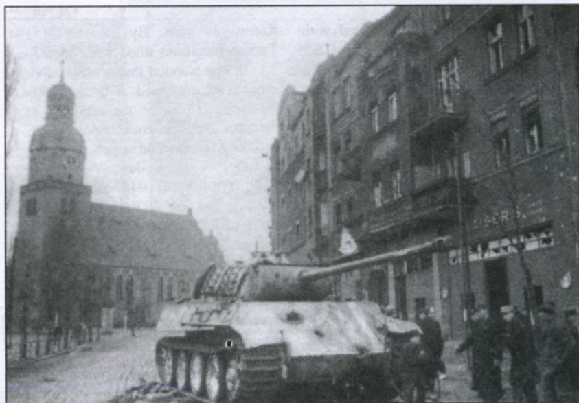
«Пантера» Ausf. G, подбитая на улицах Познани. Две пробоины на лобовой броне, вероятно, сделаны 85-мм пушкой. Оба снаряда, скорее всего, засели в коробке передач. Башня «Пантеры» обвешена гусеничными траками и запасными опорными катками. Танк несет зимний камуфляж.
