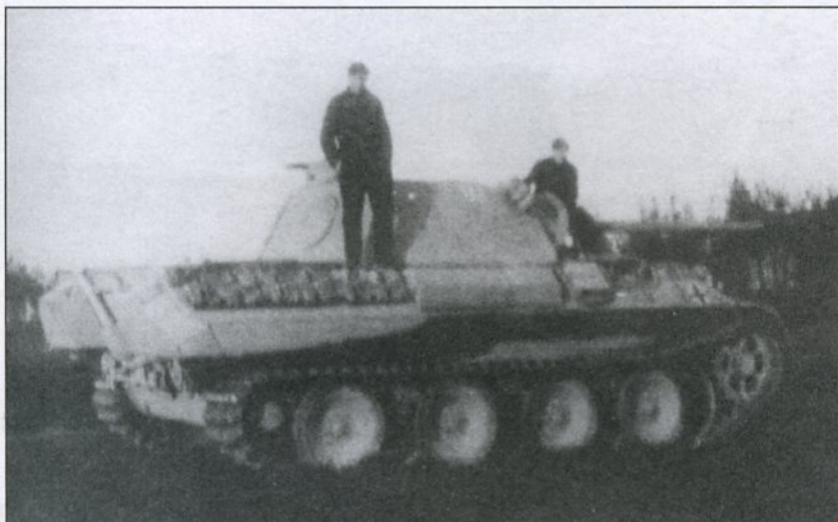
«Пантера» Ausf. D на полигоне Графенвёр, апрель 1943 года. Этот танк поступил в 51-й танковый батальон. В коробке на правом борту корпуса хранятся инструменты для ремонта гусениц. Такая коробка имела только на танках первой производственной серии. Номер 135 сделан белой краской и виден сразу за дымовым гранатометом.
