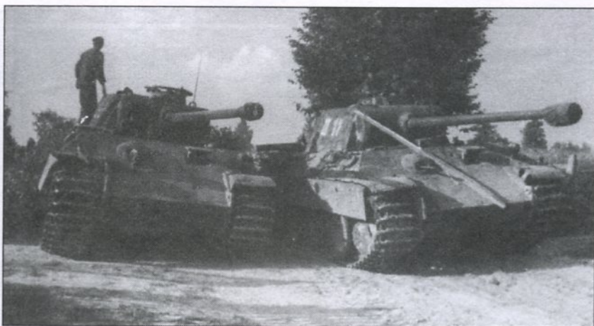
Штабная «Пантера» Ausf. A IIII проходит мимо стоящего танка. У стоящего танка под смотровым прибором механика-водителя видна отчетливая вмятина, оставленная 76,2-мм снарядом. Снаряд не пробил брони, но по какой-то причине лопнуло несколько торсионов на левом борту. От удара снаряда весь циммерит с лобовой брони осыпался.
