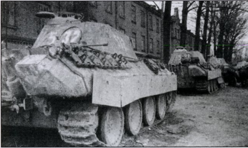
«Пантеры» 5-й роты (скорее всего дивизии «Викинг») стоят во дворе. У ближайшего танка (Ausf. A) домкрат уложен горизонтально. Неровный камуфляж представляет собой темно-зеленые и темно-коричневые пятна и полосы. Слой грязи и пыли делает камуфляж почти идеальным.
