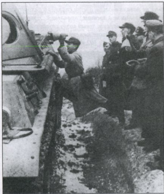
Ополченец тренируется в установке кумулятивной магнитной мины, прикрепляя ее к башне «Пантеры». В ополченцы «фольксштурма» призывали людей, негодных к строевой службе - очевидный признак агонии III Рейха. С фары снят светомаскировочный экран.
