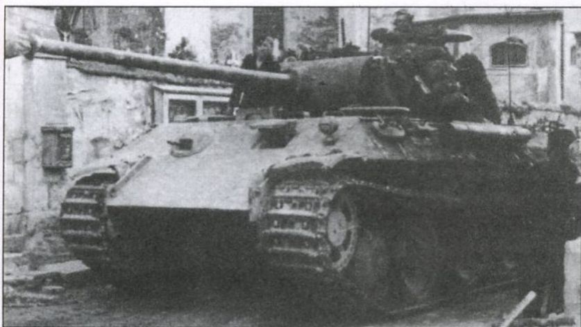
Командирская «Пантера» Ausf. A, Франция. Штыревая антенна установлена на крыше башни, а звездообразная антенна вставлена в стандартное основание позади башни. Вероятно, штатное основание для звездообразной антенны повреждено.
