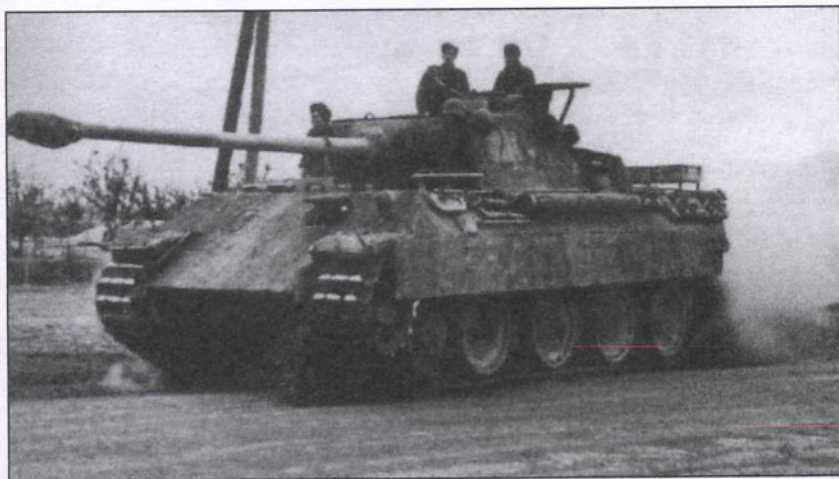
«Пантера» № 232 движется на высокой скорости по шоссе. Люк командирской башенки подперт снизу. Обратите внимание на то, что циммерит наложен и на бортовые экраны. Каски экипажа подвешены снаружи.
