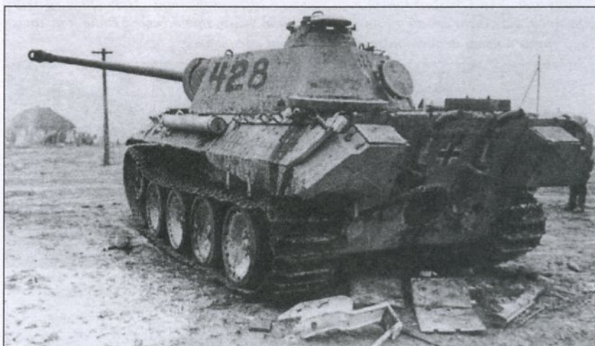
«Пантера» № 428 покрыта зимним камуфляжем. Номер на бортах и задней стенке довольно грубо выполнены малярной кистью. Между выхлопными трубами виден балочный крест. Циммерит, вероятно, наложен в полевых условиях. Обратите внимание на то, что люк механизма натяжения левой гусеницы открыт и в него вставлена рукоятка.
