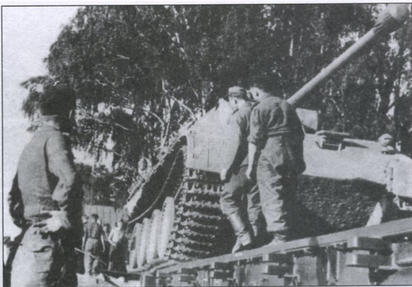
«Пантера» погружена на железнодорожную платформу. Бортовые экраны временно сняты. Циммерит наложен очень грубо, вероятно, в условиях полевой мастерской.
