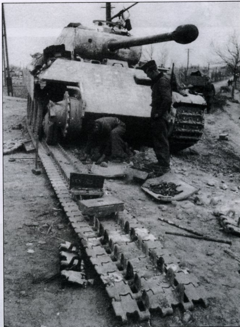
Ремонт ходовой части «Пантеры» Ausf. А. Механик-водитель меняет шкворни гусеницы. Поскольку танк оснащен монокулярным прицелом и перископом заряжающего, можно сделать предположение, что это один из первых танков Ausf. А. Фотография сделана в начале 1944 года - видны остатки зимнего камуфляжа. Обратите внимание на зенитный пулемет, установленный на командирской башенке.
