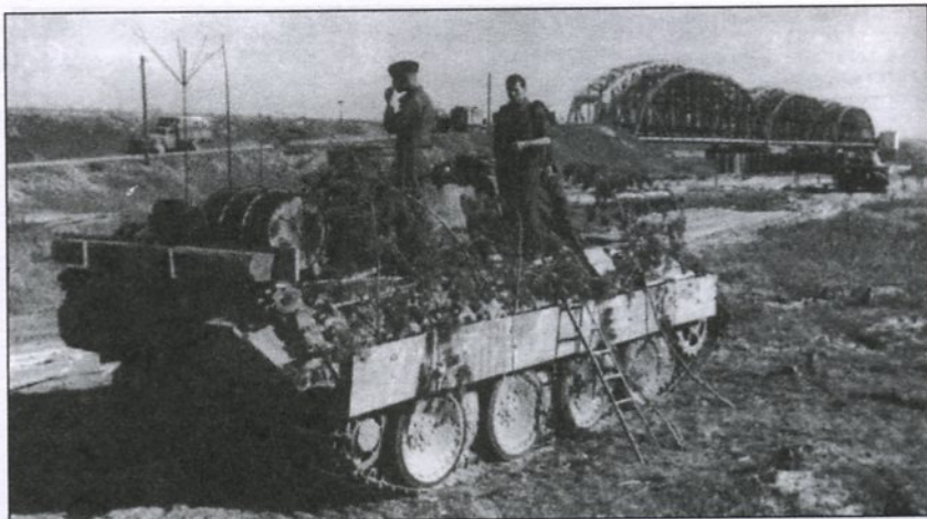
PzVFWg V Panther Ausf. D позднего выпуска держит под прицелом железнодорожный мост. Обратите внимание на то, что обе антенны установлены в гнездах на крыше двигательного отделения. Таким образом, можно заключить, что антенны могли устанавливаться в любой комбинации. На надмоторной бронеплите лежат запасы экипажа.
