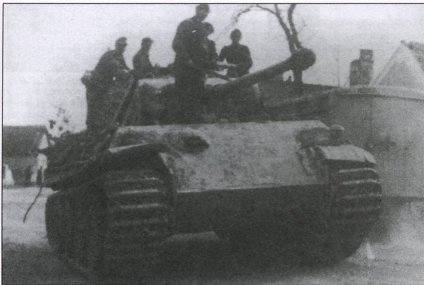
«Пантера» готовится к бою, Франция. У машины Ausf. G отсутствовал смотровой прибор механика-водителя на лобовой броне. Как обычно, башня дополнительно защищена запасными гусеничными траками.
