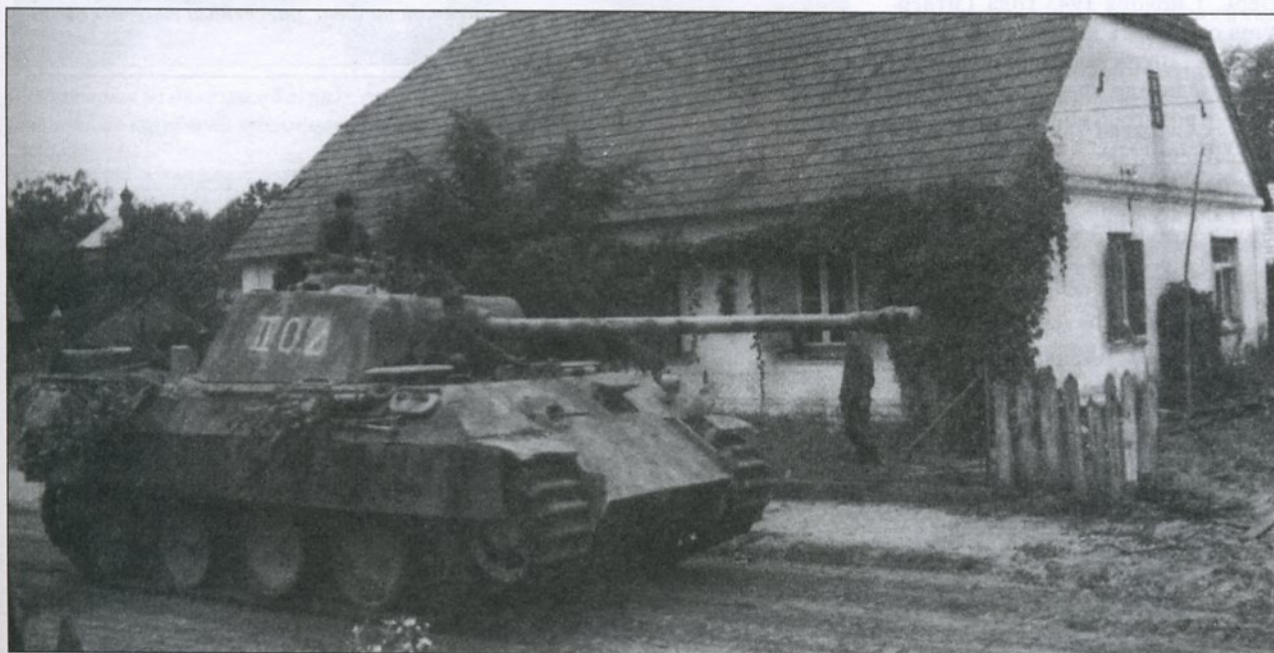
Еще одна «Пантера» № 1102 из штаба 2-го батальона. Камуфляж стандартный, сделанный пульверизатором. Этот танк не оснащен дополнительной радиостанцией, хотя и принадлежит штабу батальона.
