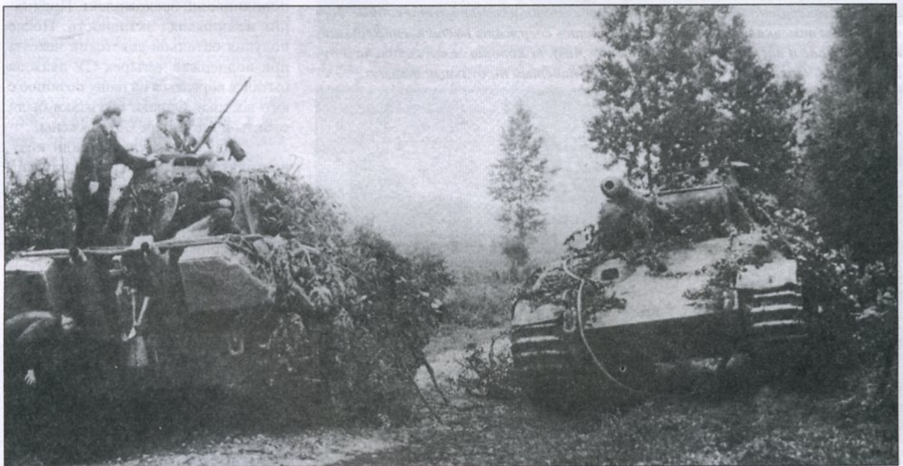
Две замаскированные «Пантеры» развезжают на дороге. Левая «Пантера» несет зенитный пулемет на командирской башенке (Fliegerbeschussgeraet). Выхлопные трубы закрыты тепловыми экранами из листового железа. У правой «Пантеры» буксирный трос едва держится на броне.
