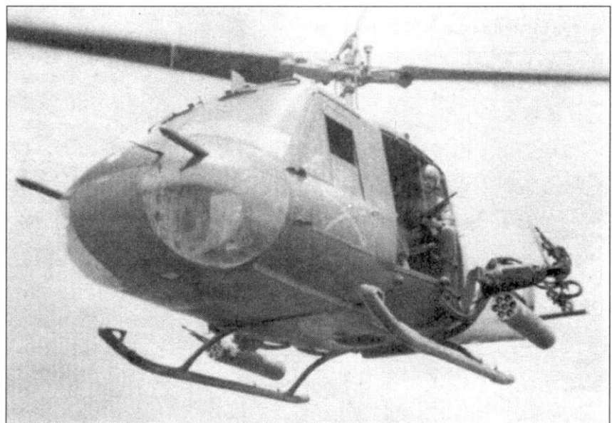
UH-1B из взвода «Playboys» 197-й авиароты, оснащенный системой XM-16. Стрелок обслуживает пулемет M-60, подвешенный на «Bungeecord».
