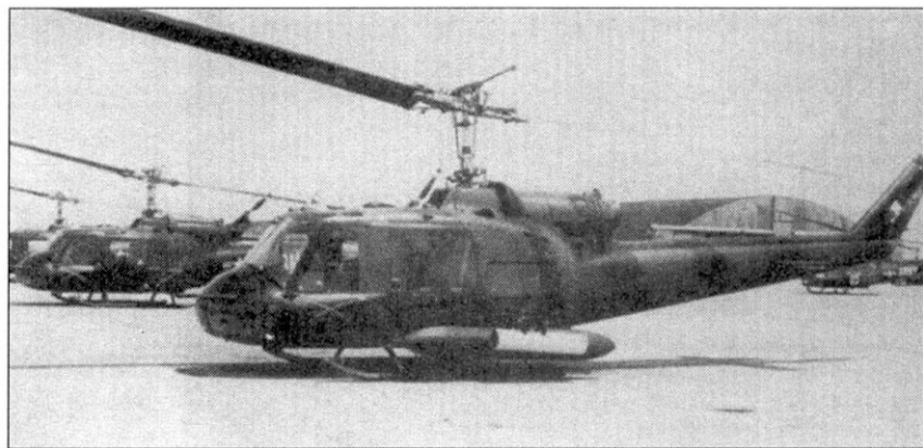
Bell UH-1B (62-1877) из УННТСО, оснащенный системой ХМ-14, лето 1964 года. С середины 1963 года вертолеты этой части носили трехцветный камуфляж.
