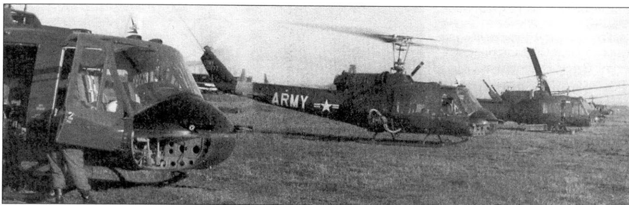
В ноябре 1962 года УТТНСО получила новенькие UH-1B. На фотографии новые машины оснащены системой XM-6. На заднем плане старый UH-1A.
