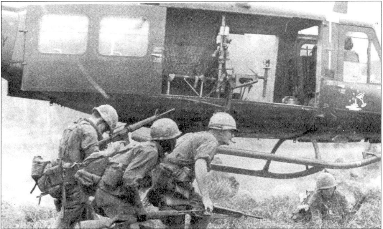
UH-1D из «Champagne Flight» 1-го авиабатальона взлетает, высадив десант. Виден станок «Sagami» для пулемета M-60.
