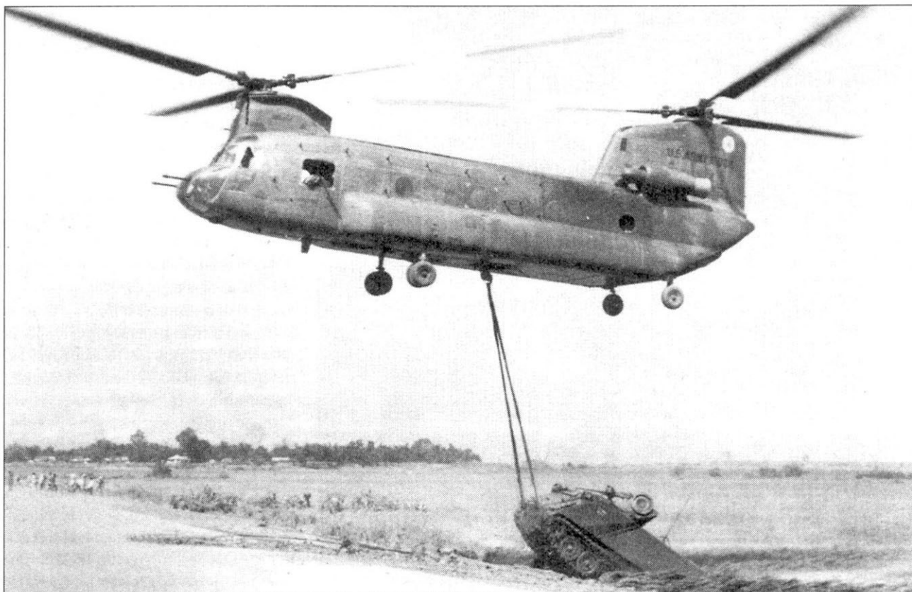
CH-47 «Chinook» (66-19055) из 242 МНС вытаскивает увязший на рисовом поле бронетранспортер М-113 из 3/4 Cavalry Squadron.
