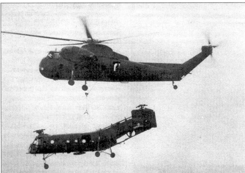
Появление тяжелых СН-53 «Можаве» позволило эвакуировать по воздуху сбитые вертолеты. На фотографии SP-37 (55-0626) эвакуирует сбитый СН-21 (52-8617) из 121-й авиароты, 14 сентября 1963 года.
