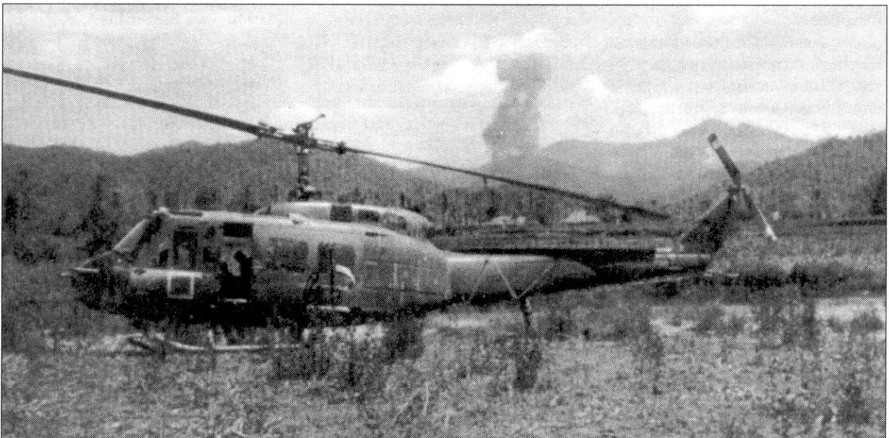
Вертолет UH-1D приземлился на поляне. На хвостовой балке видны растяжки антенны радиостанции HF, устанавливаемой на командирские машины.
