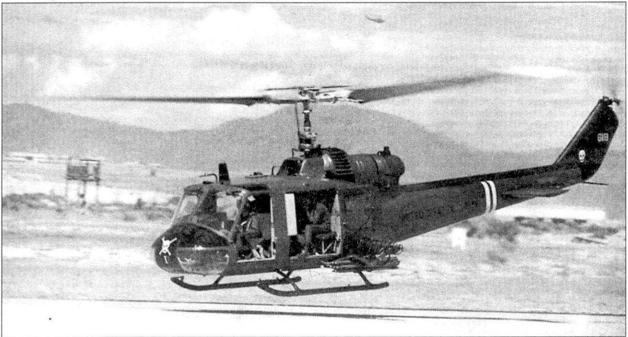
Несмотря на широкое распространение «Кобр» во многих частях до конца войны использовали в качестве штурмовиков старые UH-1C. На фотографии вертолет 66-0618 из взвода «Muskets» 176 АНС, Чулай, 1971 год. Бело-красно-белый пояс на хвостовой балке был знаком быстрой идентификации машин 14-го авиабатальона. Вооружение: «Minigun» XM-21 и пусковая установка XM-158.
