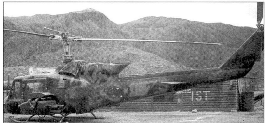
Один из двух оснащенных ракетами TOW XM-26 вертолетов NUH-1B (62-12554) на базе Ансон, июль 1972 года. Машина несет необычный двухцветный камуфляж и оснащена патрубком, отводящим выхлоп вверх. Такие патрубки начали устанавливать в 1972 году, чтобы снизить потери от советских зенитных ракет «Стрела».
