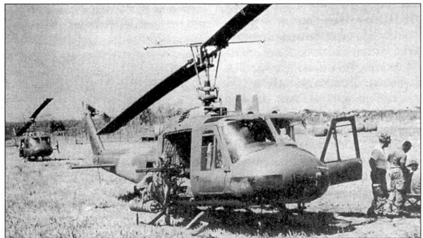
Bell UH-1H «Gunship» из 20 SOS на полевом аэродроме. Вертолет вооружен двумя пусковыми ракетными установками и парой «миниганов». В нижних иллюминаторах видны дополнительные бронелисты.
