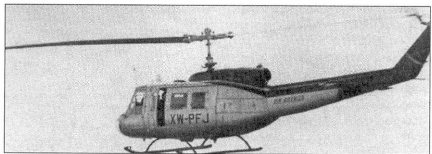
Вертолеты Bell 204B и 205 (на фото) были основными вертолетами авиакомпании Air America. Bell 205 несет фальшивый лаосский регистрационный номер XW-FPJ. Над кабиной видна дополнительная антенна ВЧ-радиостанции, предназначенной для связи с землей.
