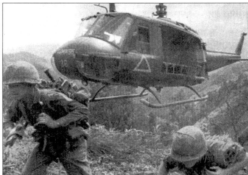
«Headhunter 38» UH-1H из A Troop 1/9 Cavalry высадил разведывательную группу на крутом косогоре. Виден пулемет M-60 XM-23 и нестандартное расположение скамеек в десантном отделении.
