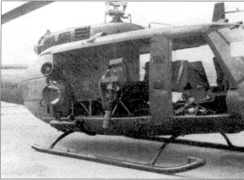
«Ночной охотник» - UH-1D из D Troop 1/1 Cavalry, Чулай, 1971 год. Машина оснащена ксеноновым прожектором AN/VSS-3 с танка M-551 «Sheridan» и усилителем AN/TVS-4. Вооружение состоит из двух подвижных «миниганов» M-134. Чтобы улучшить обзор и облегчить эвакуацию экипажа в случае необходимости, с вертолета сняты все двери - обычная для Вьетнама практика.
