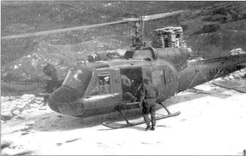
Bell UH-1E «Slick» поздней производственной серии (трубка Пито на крыше кабины) готовится к взлету на базе в районе Маттрз-Ридж. На крыше кабины также видна лебедка - главное внешнее отличие «Ниеу» морской пехоты от армейских машин.
