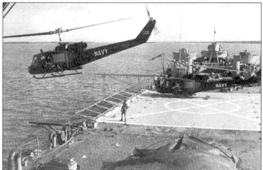
Пара «Нюеу» из Det. 5 HAL-3 на борту USS «Harnett County». Вертолет, стоящий на палубе оснащен пусковой установкой XM-158 и сдвоенные пулеметы Browning калибра 7,62 мм на станке «Sagami».
