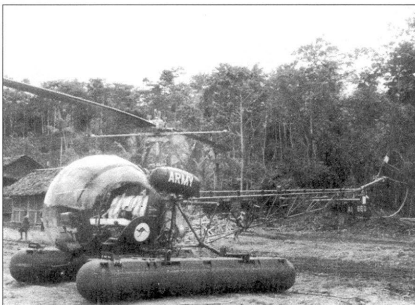
Оснащенный поплавками Bell OH-13 «Sioux» (AI-660) из 161-й эскадрильи на аэродроме в гуще джунглей.
