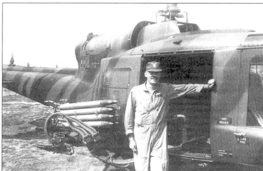
Билл Макджи в казармах Кемп-Гольдберг и на фоне своего штурмового UH-1B из 117-й авиароты. Камуфляж вертолета довольно необычен. Вертолет оснащен системой XM-6 и ранней моделью пусковой установки.
