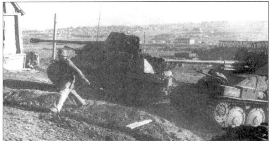
Типичная картина на дороге где-то на Восточном фронте. Колонна истребителей танков Sd.Kfz. 139 меняет позицию. В прицепах перевозилось имущество членов экипажа и дополнительный запас топлива.
