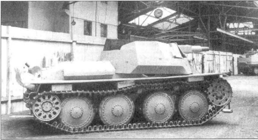
Прототип разведывательного танка с макетом башни, вооруженной короткоствольной 75-мм пушкой KwK 51, снимок сделан в сентябре 1943 г.
