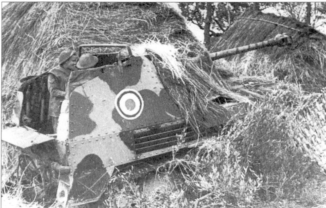
Британские солдаты в рубке трофейного «Мардера» III, Франция, 1944 г. Хорошо видно, что на модификации М этого истребителя танков экипаж был полностью прикрыт броней - в рубке можно было стоять в полный рост - только каски торчат. На предыдущей модификации Н танкисты были вынуждены работать пригнувшись.
