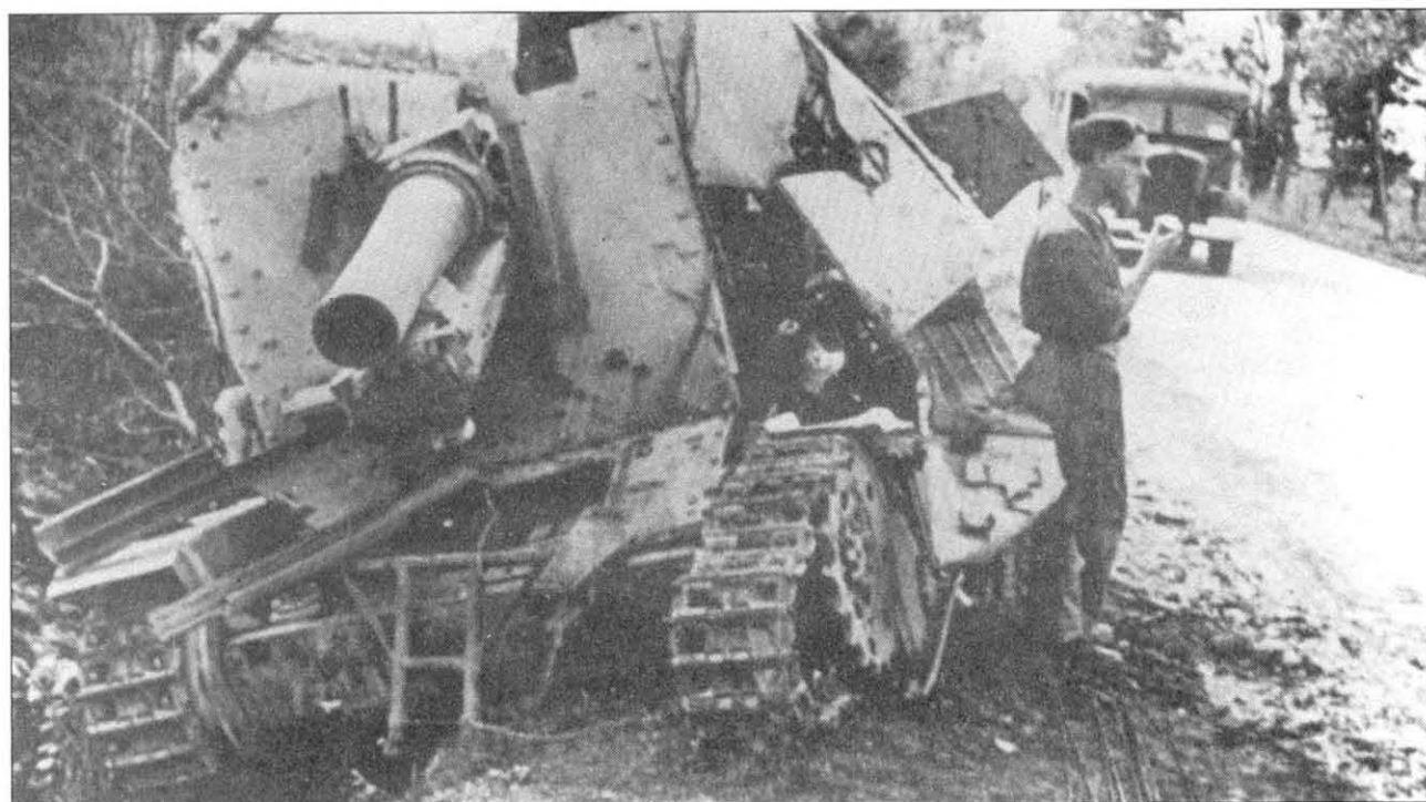
Разбитая САУ «Грилле» на обочине дороги, Италия, 1944 г. Для этих легкобронированных машин представляли опасность все противотанковые средства союзников, даже бронебойные пули и «базуки». Авиация тоже вносила существенную лепту в уничтожение немецких бронированных машин. Особенно этому способствовала открытая сверху рубка.
