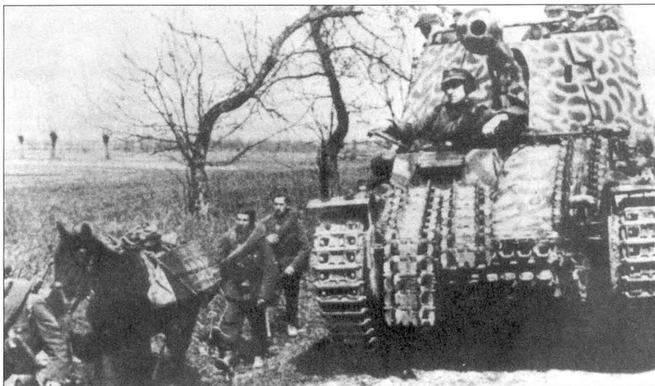
Некоторые схемы камуфляжа были весьма своеобразными. В данном случае неизвестный «мастер» расписал боевую машину полумесяцами зеленого цвета по базовой желтой окраске. Художник не пощадил даже дульный тормоз.
