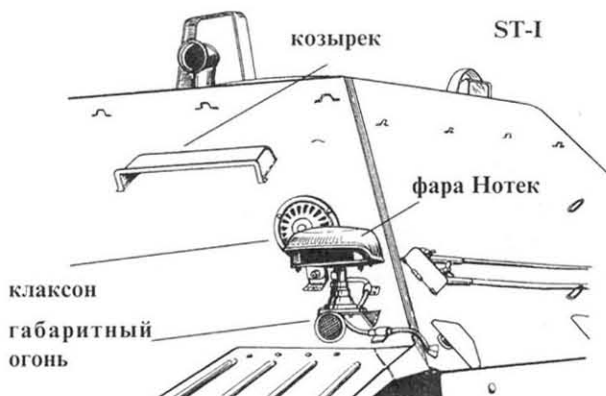
Истребители танков ST-I, в отличие от «Хетцеров», комплектовались дополнительными фарами; было также изменено расположение инструмента и оборудования на внешних стенках корпуса. На снимке - первый серийный ST-I.
