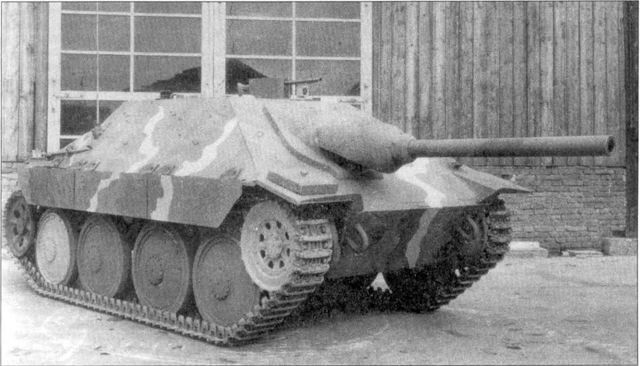
На самоходке «Старр» установлены ведущие колеса нового типа, машина также окрашена по новой камуфляжной схеме, введенной для «Хетцеров» в конце 1944 г.
