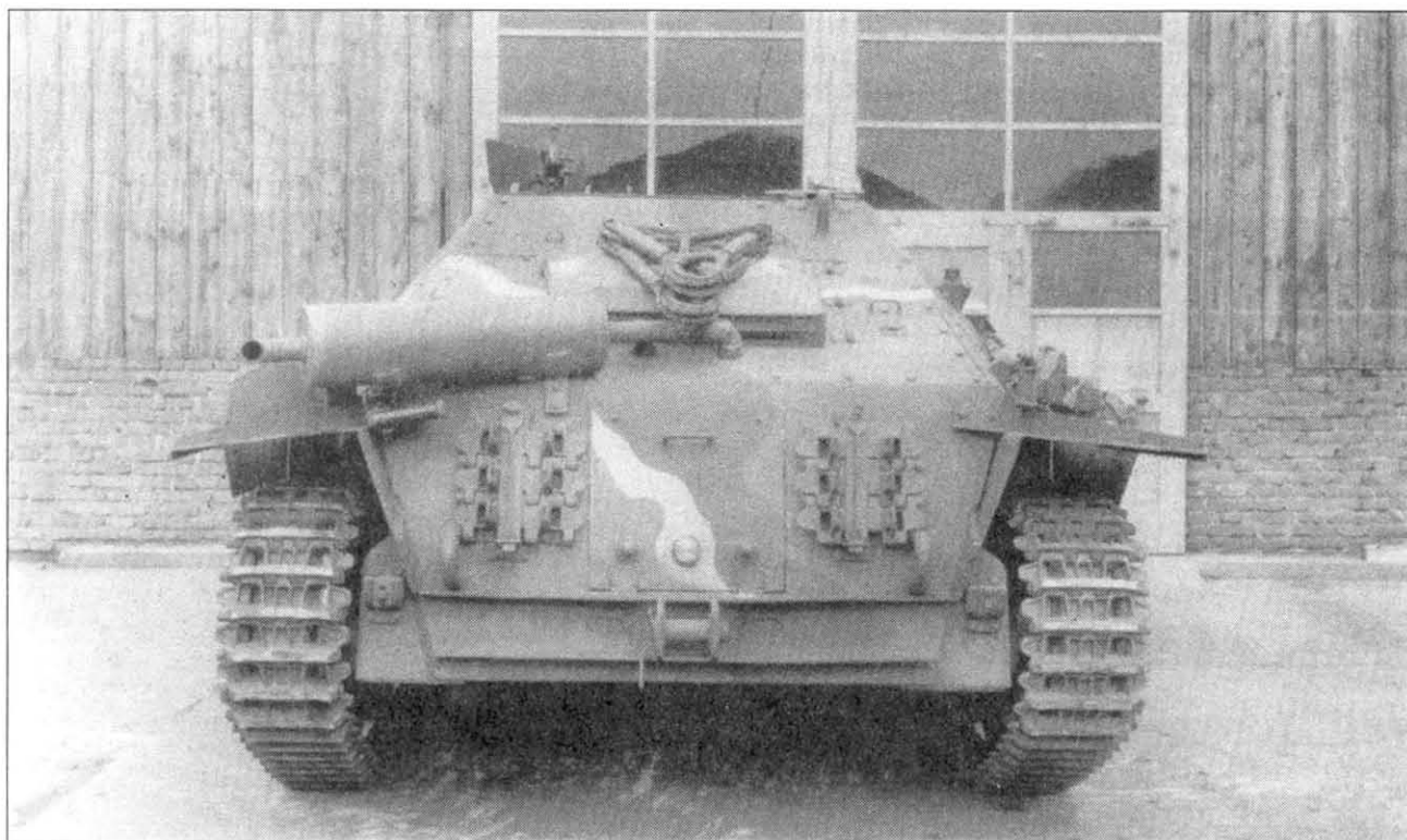
На этом снимке хорошо видно насколько корма истребителя танков «Старр» отличалась от кормы обычного «Хетцера».
