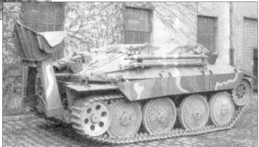
Вид сверху на боевое отделение БРЭМ, справа установлена лебедка фирмы Баумгартен. Обратите внимание на кронштейн с срезом под опору козлового двухтонного крана. Поперек боевого отделения установлены трубчатые дуги для тента.
