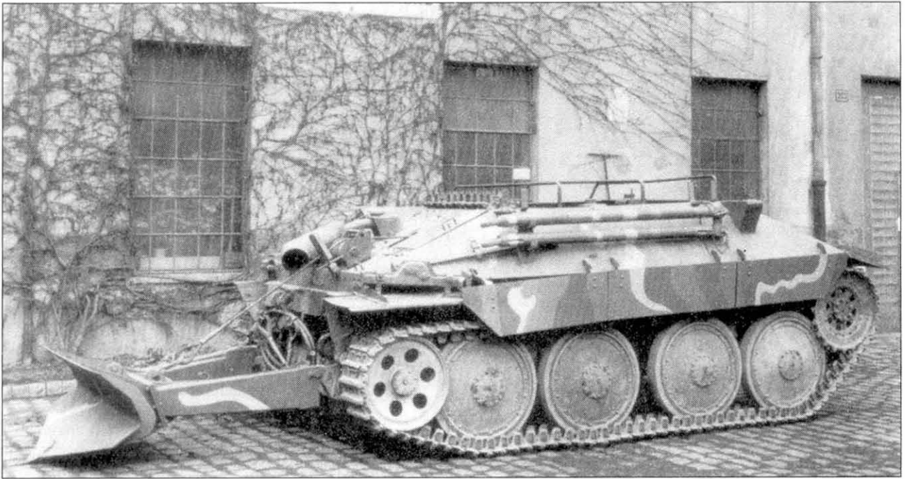
БРЭМ Bergepanzer-38 с опущенной дополнительной опорой, опора поднималась и опускалась при помощи лебедки и троса.
