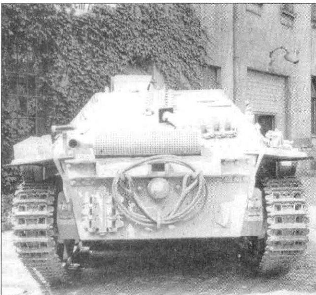
На снимках видны различия кормовых частей двух истребителей танков первой и последней серий.
