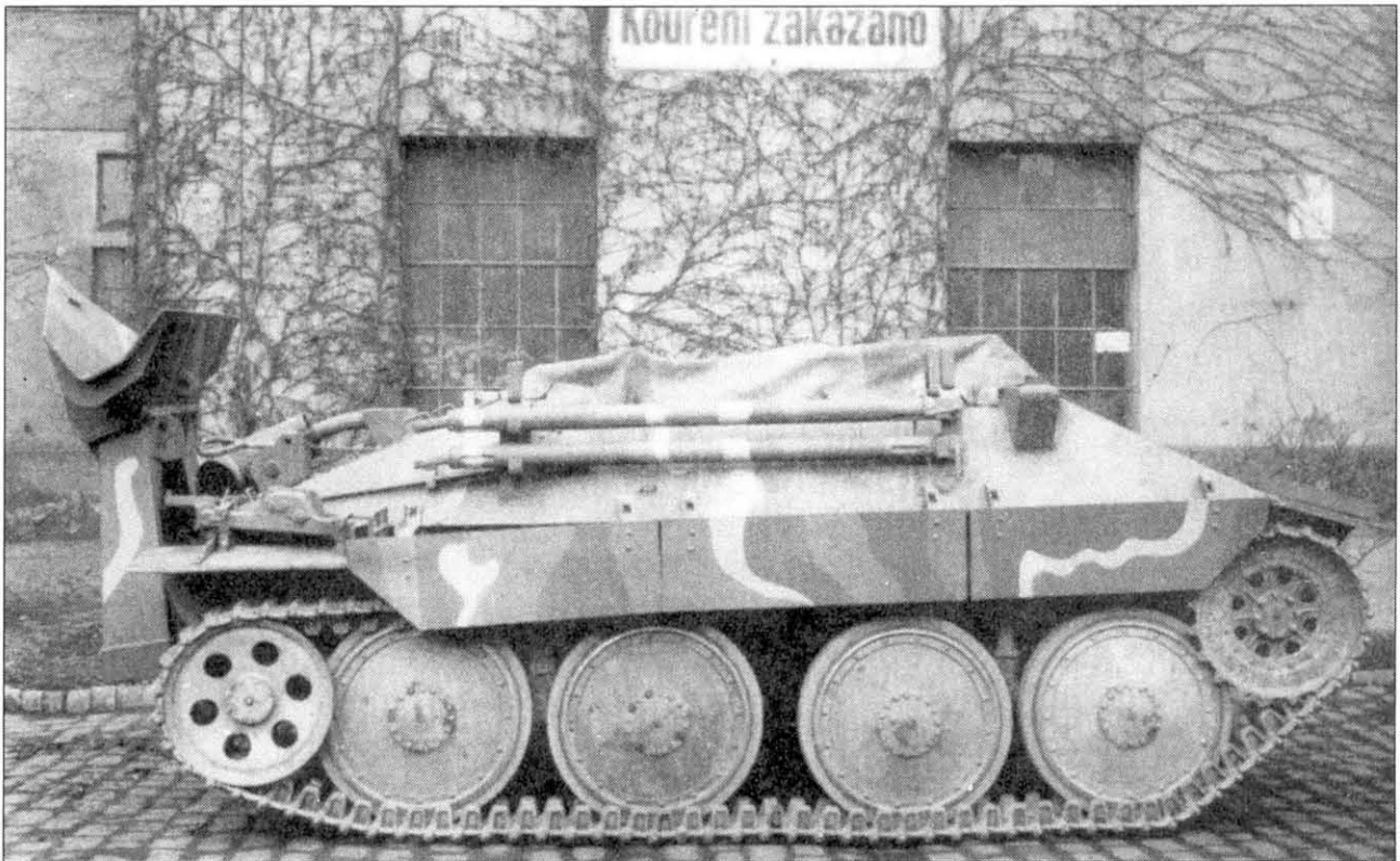
Вид справа на прототип БРЭМ Bergepanzer-38 с опорой, поднятой в транспортное положение. Обратите внимание на штампованное направляющее колеса с шестью отверстиями.
