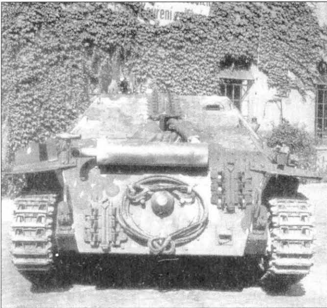
В бронекорпусах машин поздних выпусков уменьшилось по сравнению с самоходками первых партий количество съемных панелей. На этом снимке видно, что в нижнем правом углу кормового бронелиста отсутствует небольшая правая панель, имевшаяся на первых серийных истребителях танков.
