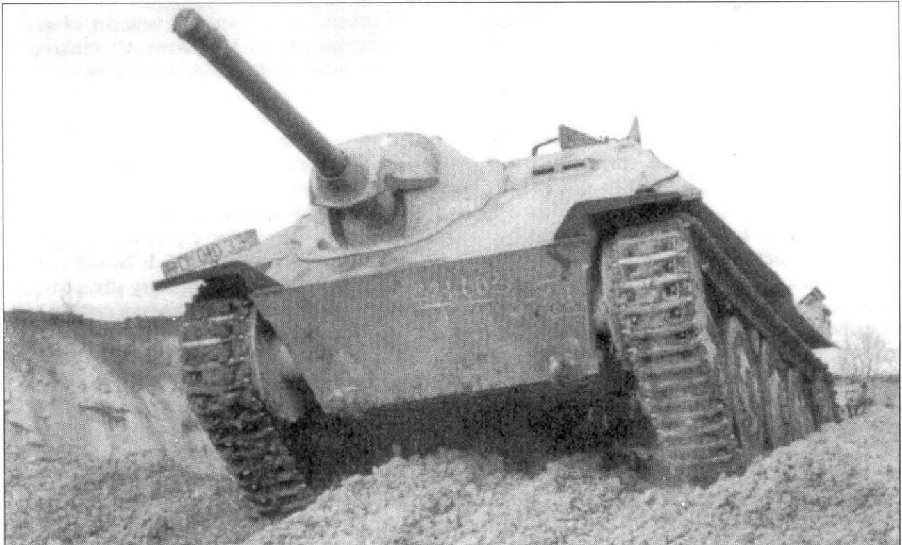
Испытания третьего прототипа истребителя танков Jagdpanzer -38 на проходимость по тяжелому грунту. Обратите внимание - в нижней части лобового бронелиста машины наварены буксировочные крюки старого типа.
