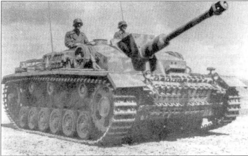
Типичным представителем немецкой бронированной машины непосредственной поддержки пехоты являлось штурмовое орудие StuG III, вооруженное эффективной 75-мм пушкой, установленной в лобовой части неподвижной бронерубки.
