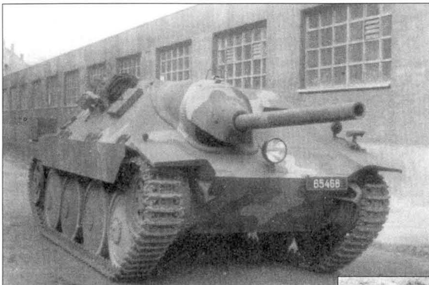
Истребители танков ST-I, в отличие от «Хетцеров», комплектовались дополнительными фарами; было также изменено расположение инструмента и оборудования на внешних стенках корпуса. На снимке - первый серийный ST-I.
