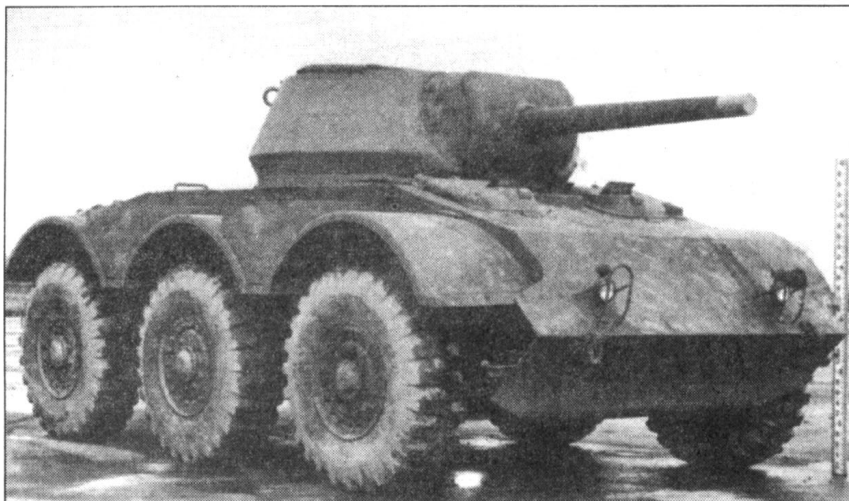
Бронеавтомобиль T19E1 стал ответом на требования противотанкового командования к вооруженному 75-мм пушкой колесному истребителю танков. Пушка установлена в открытой сверху башне кругового вращения. Новая машина получила обозначение «75-мм самоходный артиллерийский носитель T66».
