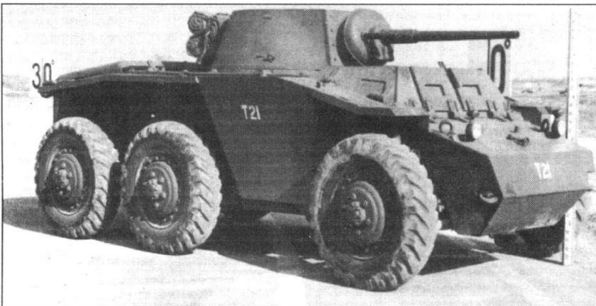
К середине 1941 г. управление вооружения приняло решение начать работы по созданию трех типов броневых автомобилей - легкого, среднего и тяжелого. Только машины легкого класса использовались армией США в годы Второй мировой войны. В программе разработки легких броневых автомобилей приняло участие три фирмы: компания Студебеккер предложила машину T21, Форд - T22, Крайслер - T23. Броневым автомобилем T21 был разработан фирмой Студебеккер с инициативном порядке.
