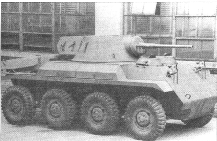
Бронеавтомобиль T27 разрабатывался в соответствии с требованиями, выработанными управлением по вооружению в начале 1943 г. Фирма Студебеккер использовала восьмиколесную ходовую часть (шесть колес - ведущие). Вооружение - 37-мм пушка и спаренный с ней пулемет винтовочного калибра. Орудие калибра 37 мм уже не имело возможности эффективно бороться с бронетехникой противника, кроме того - установка относительно слабой пушки не вписывалось в концепцию тяжелого бронеавтомобиля; 57-мм пушка представлялась гораздо более логичным вариантом вооружения подобной машины.
