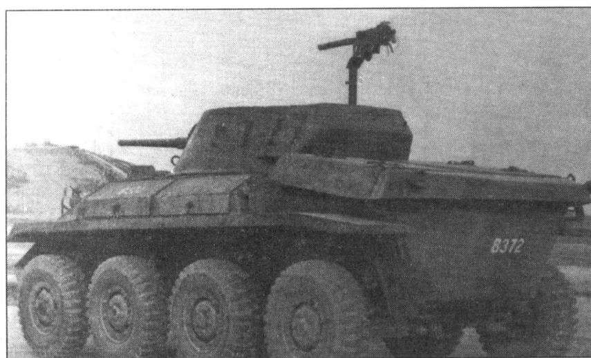
Особенностью конструкции ходовой части броневедомобиля Т27 являлось равномерное распределение колес по базе - в мире до сих пор не так уж много восьмиколесных броневедомобилей с равномерным разнесением колес. Масса машины превышала 7 т, в целом конструкторам удалось достигнуть оптимального соотношения между внутренним объемом и массой машины. Броневедомобиль не имел курсового пулемета в корпусе, однако, сохранялась возможность установки на башне зенитного пулемета.
