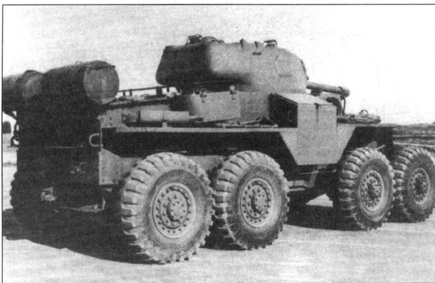
Как и «Стэгхаунд», «Бэрхаунд» оснащался сбрасываемыми топливными баками, однако они монтировались не по бортам, а в задней части корпуса машины. Удобный доступ в машину обеспечивали бортовые и верхние люки отделения управления и два люка в крыше башни. Несмотря на то, что бронев автомобиль имел толстую броню и мощное вооружение, англичане использовали его только для испытаний и в январе 1944 г. объявили устаревшим. Единственный уцелевший бронев автомобиль «Бэрхаунд» демонстрируется в экспозиции британского танкового музея в Бовингтоне.
