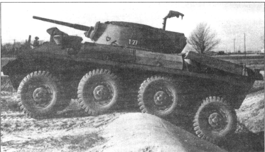
Бронеавтомобиль T27 разрабатывался в соответствии с требованиями, выработанными управлением по вооружению в начале 1943 г. Фирма Студебеккер использовала восьмиколесную ходовую часть (шесть колес - ведущие). Вооружение - 37-мм пушка и спаренный с ней пулемет винтовочного калибра. Орудие калибра 37 мм уже не имело возможности эффективно бороться с бронетехникой противника, кроме того - установка относительно слабой пушки не вписывалось в концепцию тяжелого бронеавтомобиля; 57-мм пушка представлялась гораздо более логичным вариантом вооружения подобной машины.
