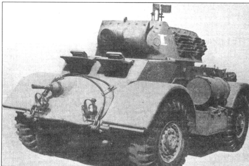
Время полного оборота башни составляло семь секунд, скорострельность пулеметов - 600 выстрелов в минуту. Поскольку башенные пулеметы могли бороться как с воздушными, так и с наземными целями, пулемет из лобовой части корпуса на зенитной машине был демонтирован. Экипаж броневомобиля ПВО сокращен до трех человек, а высвободившийся объем был использован для установки радиооборудования и размещения боекомплекта.
