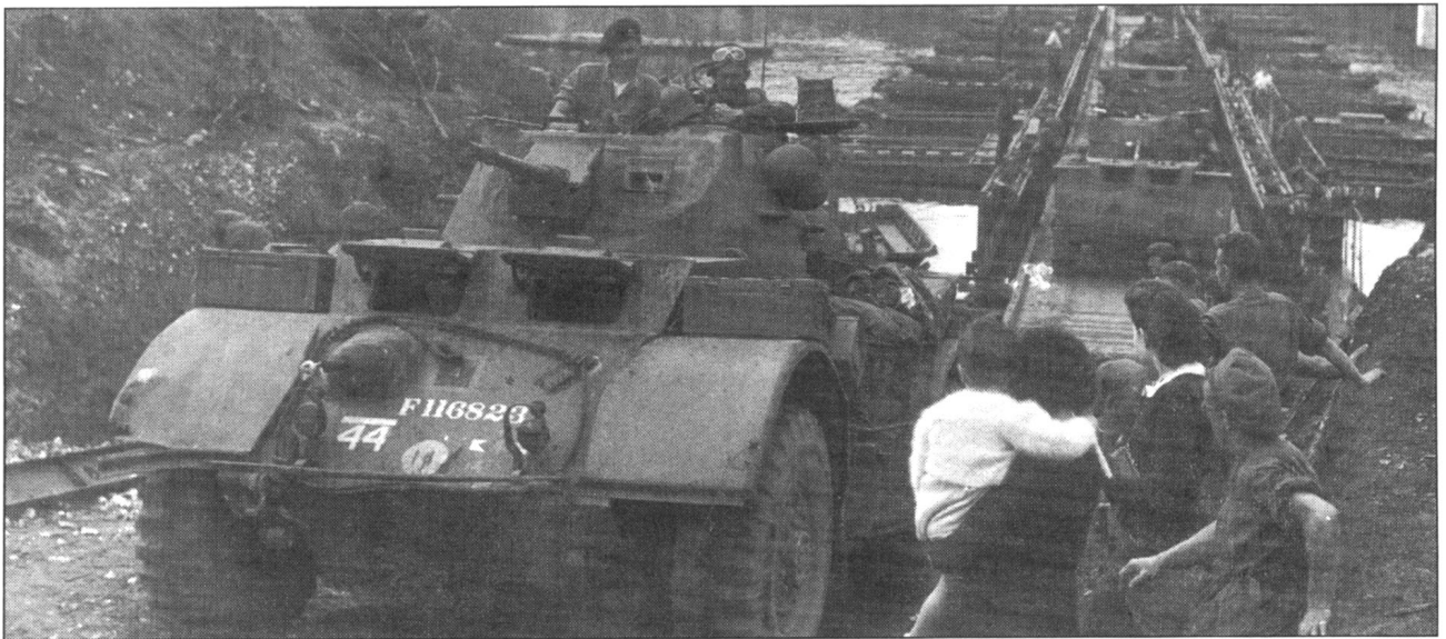
Группа бронеевтомобилей «Стэгхаунд» из 4-й канадской бронетанковой дивизии пересекает реку Сена по наведенным саперами поитонному мосту, конец лета 1944 г. Обратите внимание - на передних крыльях головной машины смонтированы дополнительные ящики.
