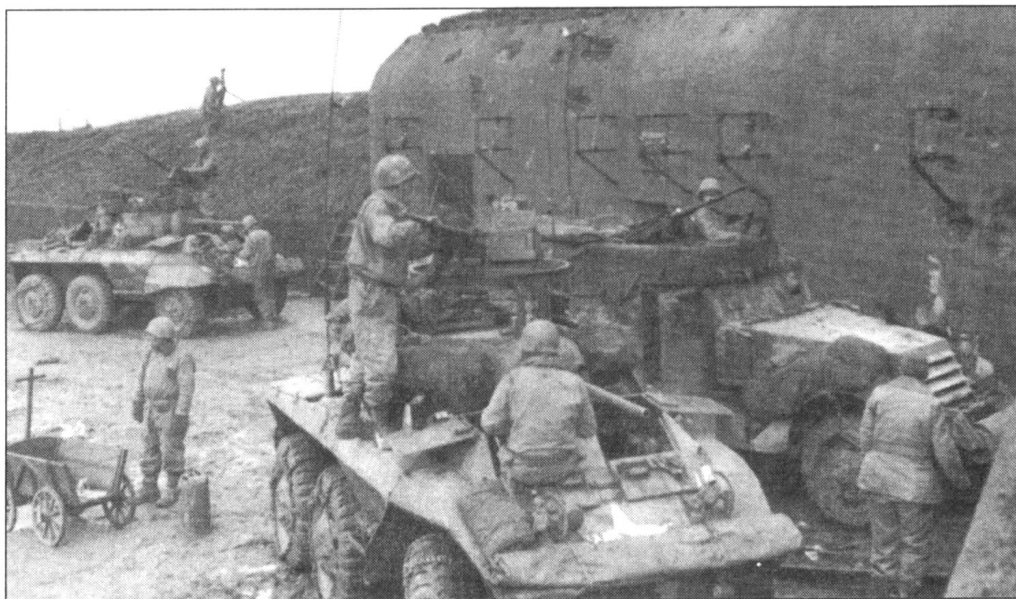
Личный состав 92-го кавалерийского эскадрона готовится к атаке под прикрытием фортификационных сооружений линии Мажино. Обратите внимание - с броневладельцев демонтированы щиты-экраны, а колеса для лучшей проходимости обмотаны цепями.
