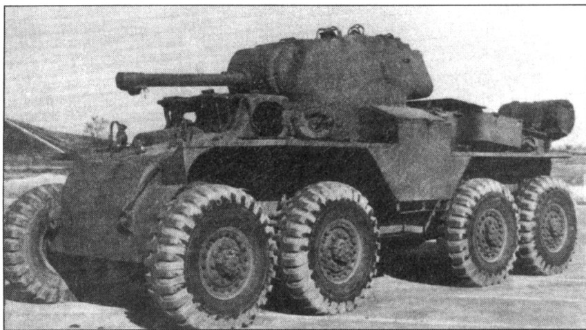
Т18Е2 стал крупнейшим бронев автомобилем, построенным в США в годы Второй мировой войны. Он имел новую, полностью закрытую башню, вооруженную 57-мм пушкой. Всего было построено тридцать бронемашин Т18Е2 - все они переданы англичанам. В Британии машина получила наименование «Бэрхаунд».
