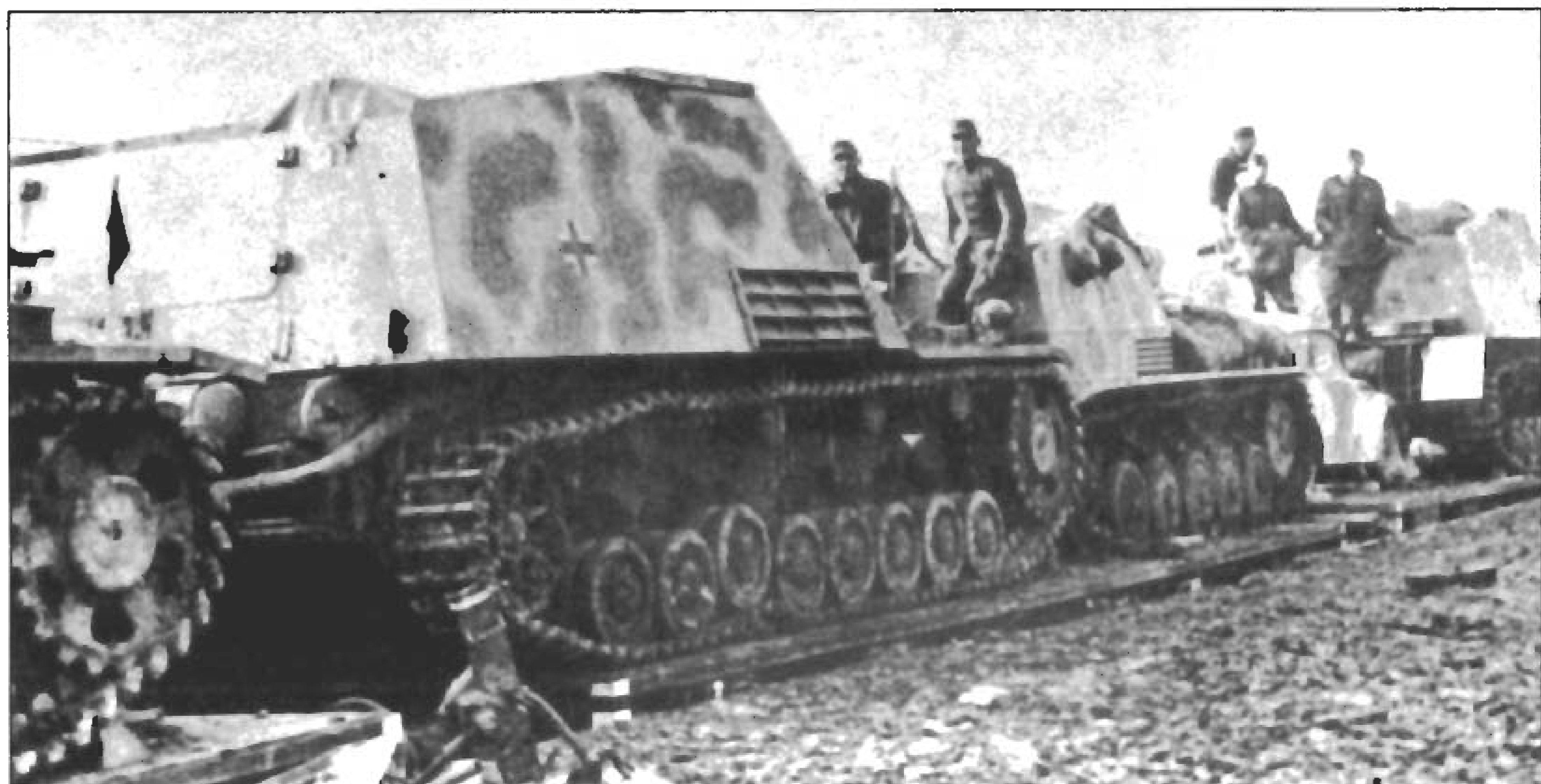
В центре фотографии - транспортер боеприпасов на базе «Хуммеля». Машина ранних серий - это видно по цилиндрическому глушителю.
