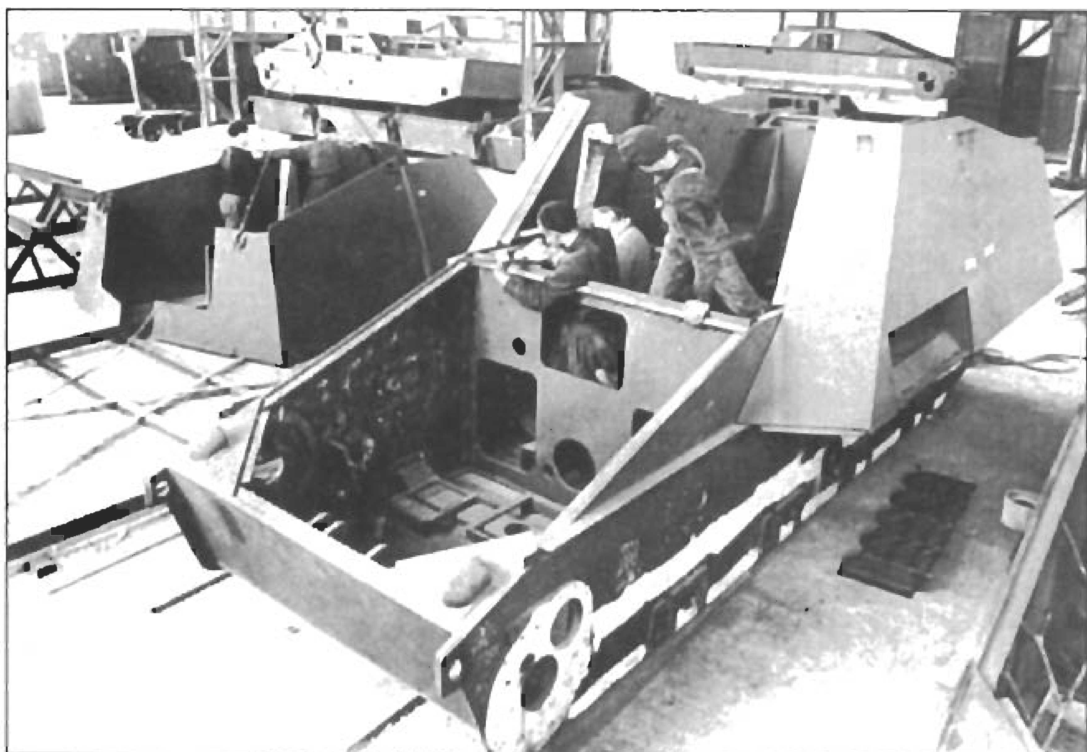
Сборка САУ «Хуммель». Обратите внимание на узлы навески ведущего колеса и четырех тележек опорных катков.
