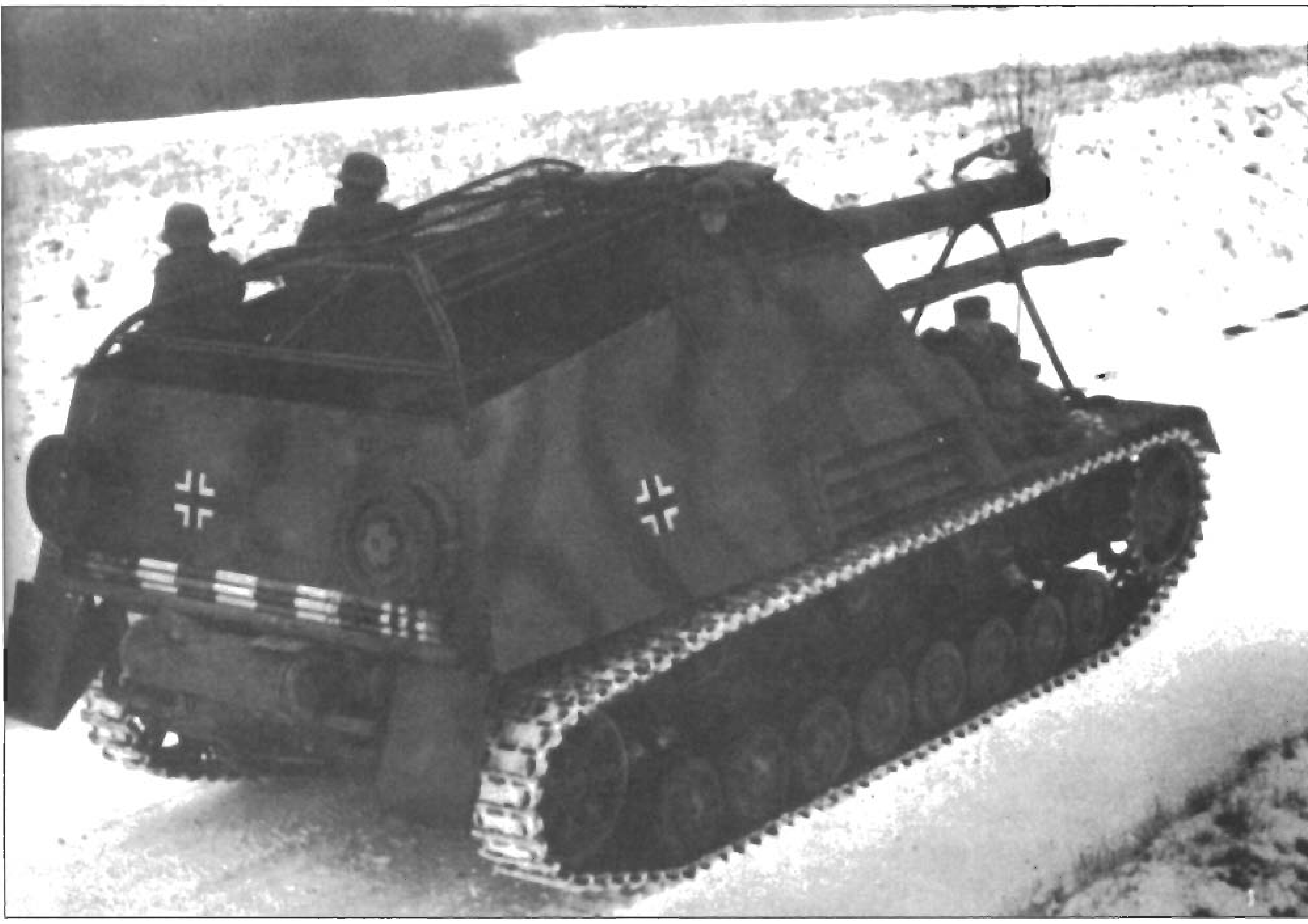
«Хуммель» раннего типа одной из частей СС. Сетчатая крыша боевого отделения по-видимому является полевой модификацией. Машина окрашена в серый цвет, поверх него нанесены зеленые полосы.
