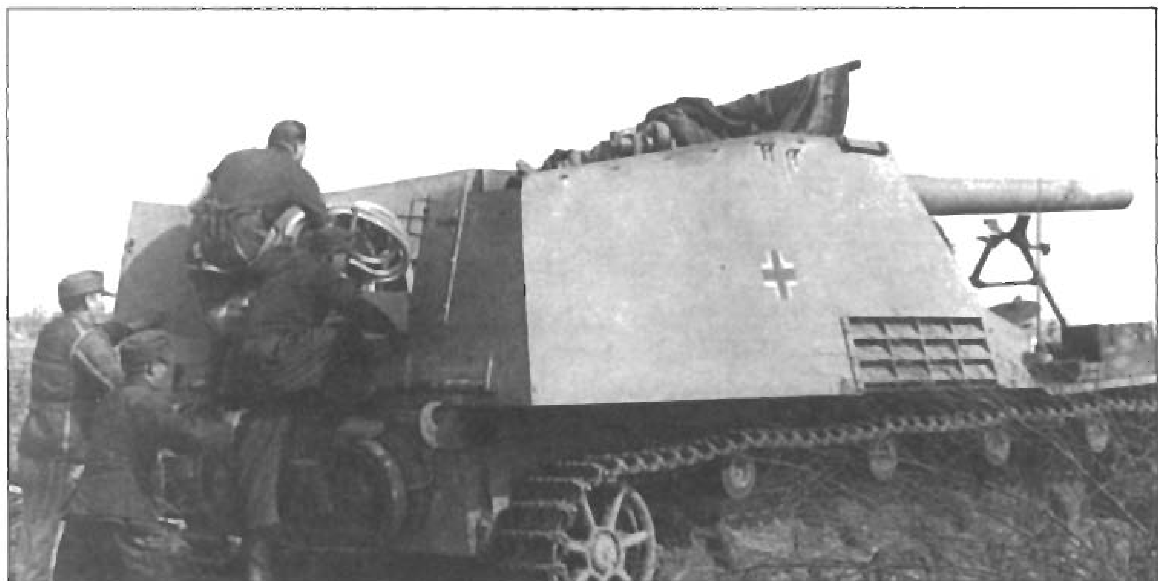
Экипаж перед боем занимает свои места в самоходке, на внутренней стенке рубки виден шланг, предназначенный для заливки рабочей жидкости в рекуператор и противоткатное устройство пушки.
