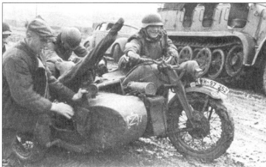
Экипаж мотоцикла Zundapp KS750 из 13-й танковой дивизии выталкивает свою машину из грязи. На коляске тактический значок 2-й роты разведывательного батальона. Желтая дивизионная эмблема в виде разделенного на четыре части круга нарисована на переднем крыле. Обратите внимание на зачехленный пулемет MG 34, укрепленный на коляске.
