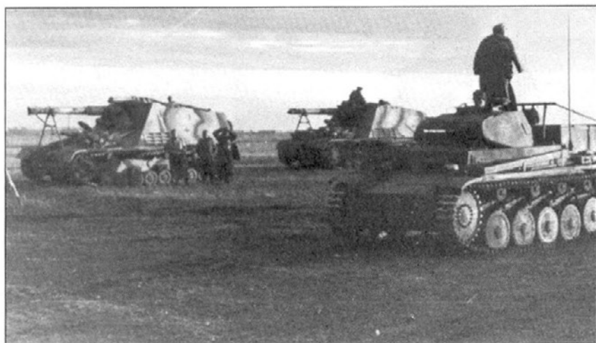
Самоходные орудия Mittel , сфотографированные в России, с буквенно-цифровыми обозначениями позднего образца. «A32» означает 1-й батальон, 3-ю батарею, 2-е орудие. В то время в обычном артиллерийском полку немецкой танковой дивизии третья батарея комплектовалась Mittel , а первая и вторая Wespe .
