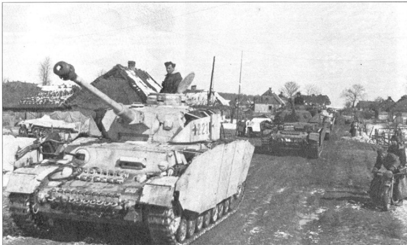
Средний танк PzKpfw IV Ausf H в зимней камуфляжной окраске из состава 3-й танковой дивизии, снимок сделан в России. Нанесенные на нем обозначения выглядят несколько непривычно из-за большего контраста с белой краской. Номер «221» желтого цвета, центральная часть креста грязно-серого (тускло-черного) цвета, полковая эмблема (скрытая дверцей на навесной броне) - черная, медведь стоящий на задних лапах - красный. Следующие за ним два танка окрашены в темно-желтый цвет, четвертый танк - белый.
