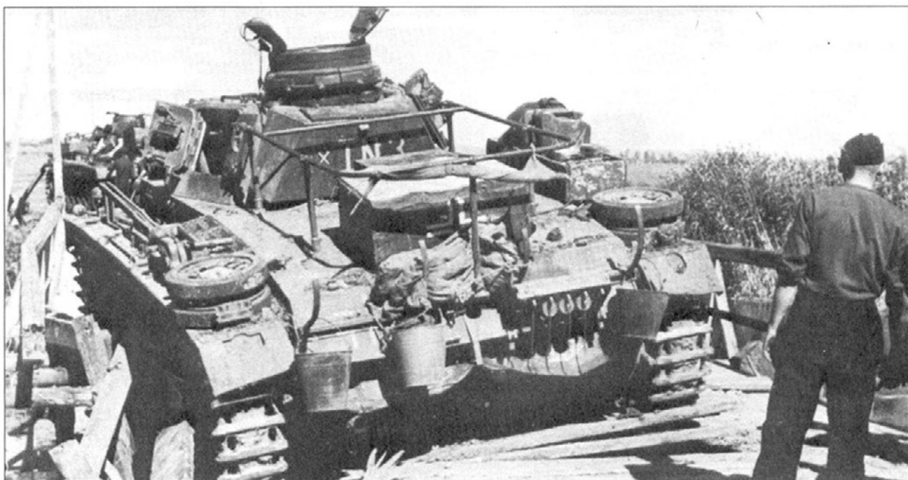
Командирский танк Befehlspanzer III из взвода связи 1-го батальона 5-й танковой дивизии. Новый значок дивизии - один желтый «X» - нарисован перед номером танка. Обратите внимание на толстый слой пыли, покрывающий верхние поверхности танка.
