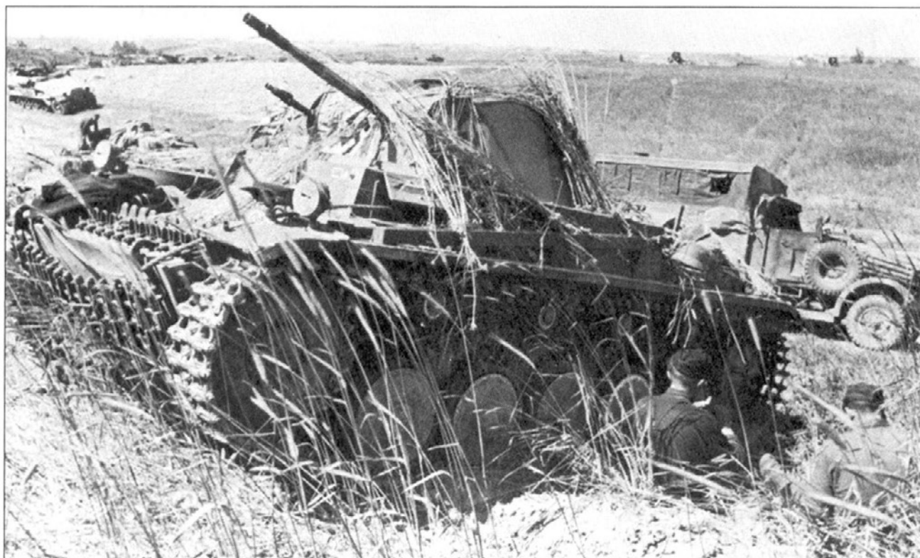
Легкий танк PzKpfw II из разведывательного взвода штабной роты 4-го танкового полка (PzRgt 4) 13-й танковой дивизии. Ромб и «R» белого цвета, дивизионная эмблема - желтого. На башне желтый номер «R13».
