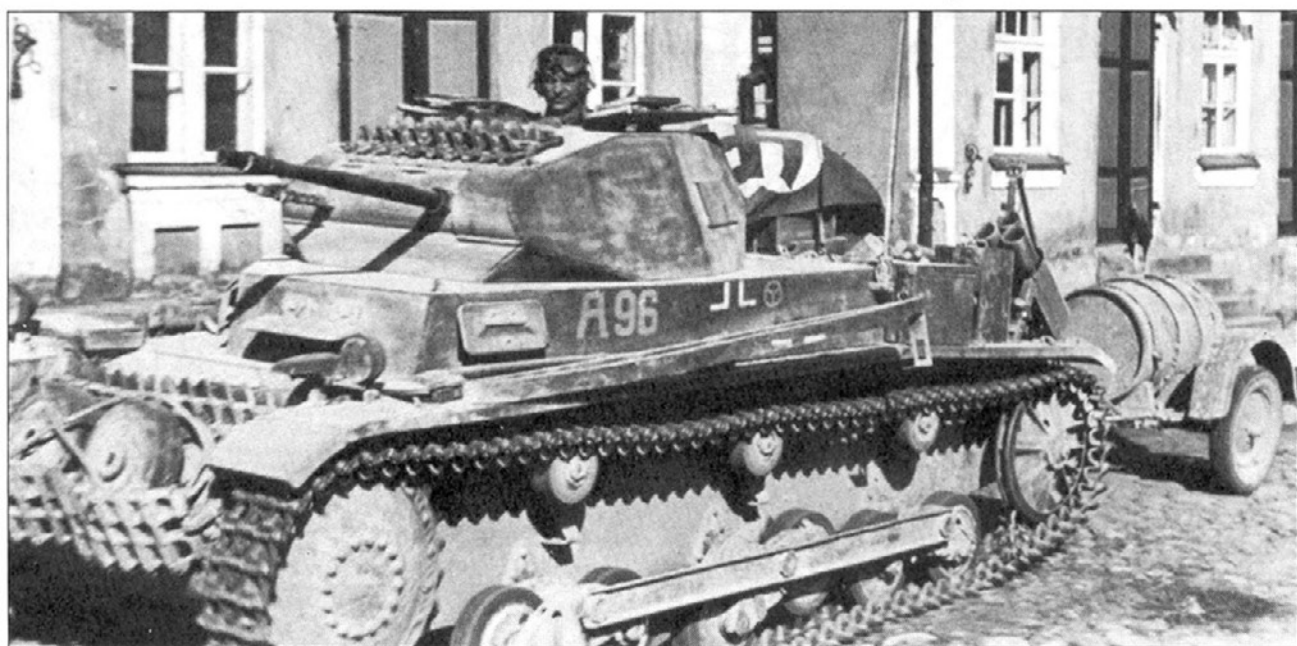
Легкий танк PzKpfw II раннего выпуска из 12-й танковой дивизии в России, 1941 год. Дивизионная эмблема и номер «A96» желтого цвета. «A96» расшифровывается как, разведывательный батальон (Aufklarungs), 9-я рота, 6-я машина.
