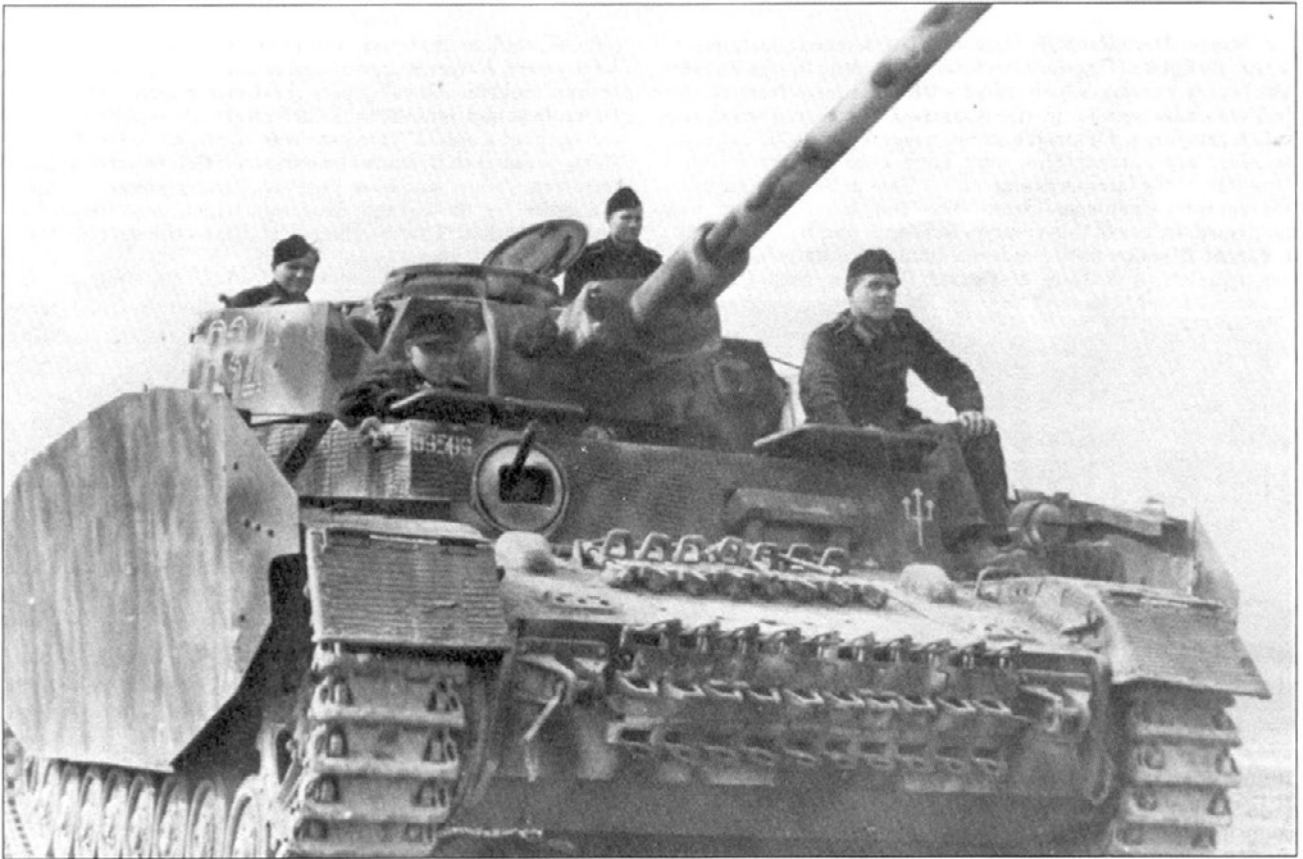
Фотография передней части среднего танка PzKpfw IV Ausf H на которой хорошо видны стандартные обозначения (все белого цвета): трезубец, номер шасси танка и башенный тактический номер, цифры которого нарисованы белой обводкой. Многие танки 2-й танковой дивизии несли подобную маркировку.
