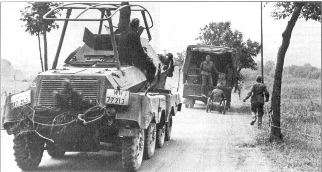
Тяжелая бронемашина SdKfz 263 из разведывательного батальона 6-й танковой дивизии во Франции. Желтая дивизионная эмблема виднеется над правым номерным знаком. На левой задней части корпуса - значок разведывательного батальона.
