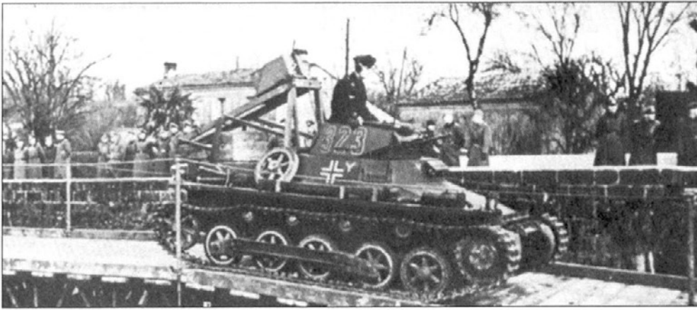
Ladungsleger I с установленным над крышей моторного отделения оборудованием из саперного батальона (Pz Pi Abt) 7-й танковой дивизии. На машине белый углоковый крест и новая эмблема 7-й танковой дивизии, введенная в конце 1940 года.
