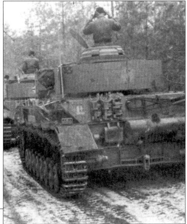
Колонна средних танков Pz Krfw IV. На заднем броневом листе последней машины видна выцветшая дивизионная эмблема. Танки окрашены полностью в темно-желтый цвет. Обратите внимание, что задний экран на баши танка покрыт цинмеритовой обмазкой.
