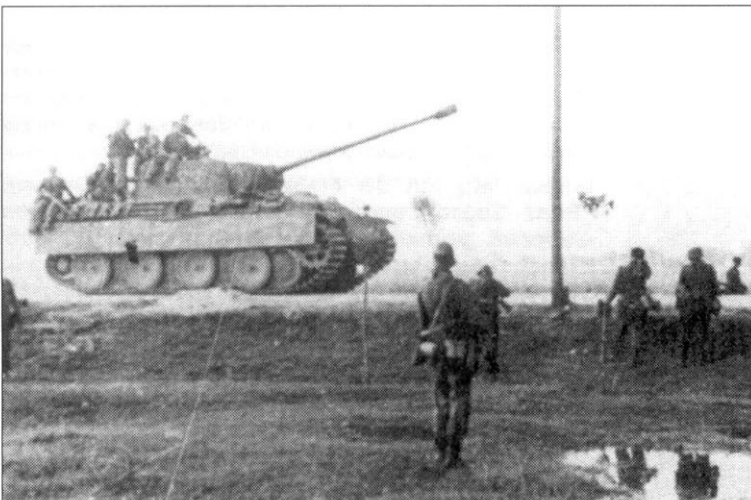
Пантеры из первой роты имели более аккуратный рисунок нанесенных распылителем на темно-желтую базовую окраску пятен красно-коричневого цвета. Различия в такой окраске обычно были вызваны тем, что каждый экипаж перекрашивал свою машину самостоятельно. Башенный номер почти стерт и очевидно нарисован от руки.
