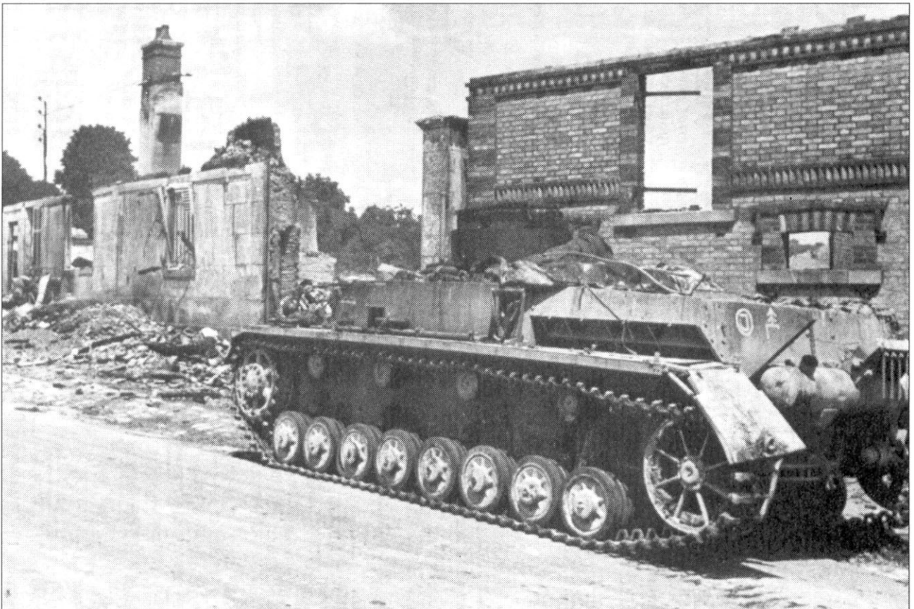
Необычного вида машина на фотографии - это PzKpfw IV Ausf D либо E - танковый мостукладчик из саперного батальона (PzPi Abt), переданный ремонтно-технической роте танкового полка после того, как он уложил мостовую конструкцию. Задняя опора мостовой конструкции частично закрывает тактический знак саперов. Немецкая буква «I» в круге обозначает ремонтно-техническое подразделение.
