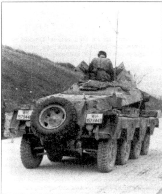
Тяжелая бронемашина SdKfz 232 из 15-й панцер-гренадерской дивизии движется по дороге в Сицилии, сопровождая солдат из дивизии «Герман Геринг». Она имеет мачтовую антенну, которая начала устанавливаться на таких машинах позднего выпуска, взамен старой антенны рамочной конструкции. Бронемашина покрыта пятнами оливково-зеленого и красно-коричневого цвета.
