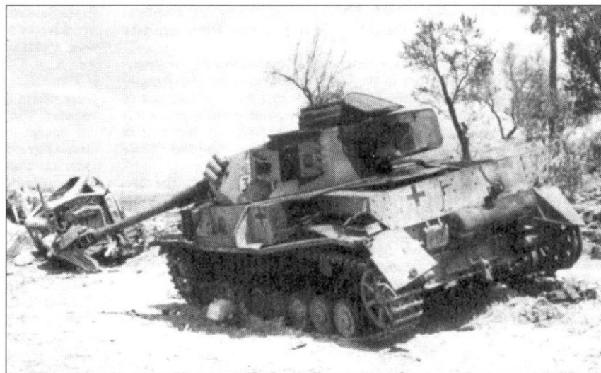
Подбитый средний немецкий танк PzKpfw IV Ausf G из 15-й панцер-гренадерской дивизии имеет эмблему дивизии - белую звезду на кормовом броневом листе с командирским значком в центре. Номер роты (3-я рота) нанесен черной краской на изображении белого щита. Щит имеет обводку красного цвета, над ним голова рыцаря, также красная.
