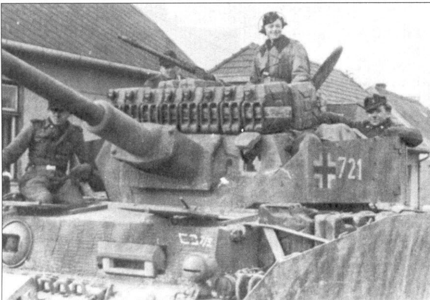
Средний танк PzKpfw III Ausf H из 7-й роты 2-го батальона «Panzer Lehr Division», сфотографированный в марте 1944 года. Обратите внимание на стандартный номер на башне и на ротный тактический значок, в котором использована буква «L» - дивизионная эмблема.
