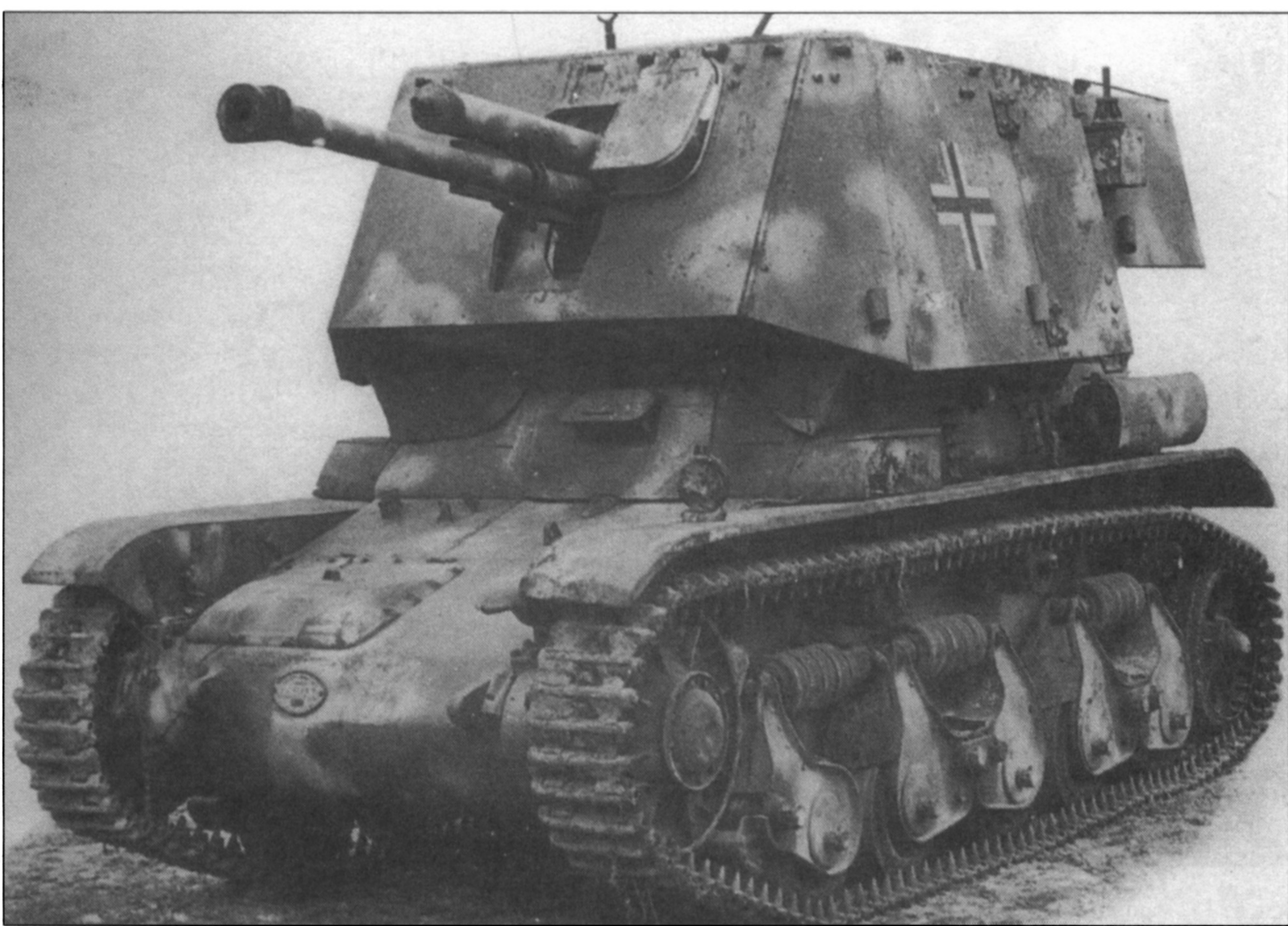
Захваченный союзниками самоходный истребитель танков 4,7 см Pak(t) auf PzKpfw 35R(f) ohne Turm.
