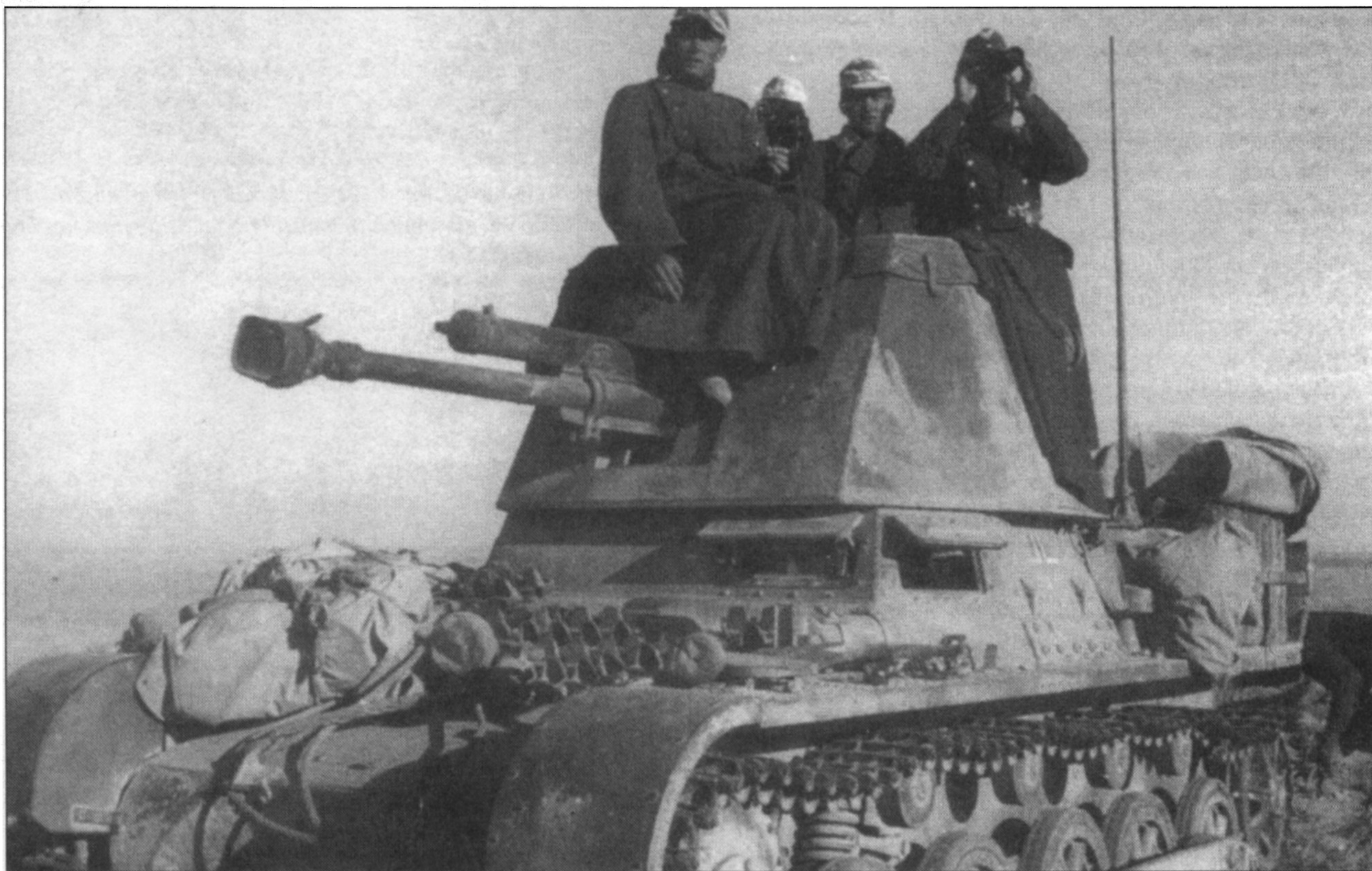
4,7 cm Pak(t) auf PzKpfw I Ausf. B SdKfz 101 ohne Turm из 605-го дивизиона истребителей танков, Ливия, 1941 год. Машина тоже увешана имуществом, боевое отделение закрыто брезентом, на дульном тормозе - чехол. Отсутствие свободного места заставляло экипажи самоходок сдавать в обоз почти все личные вещи.
