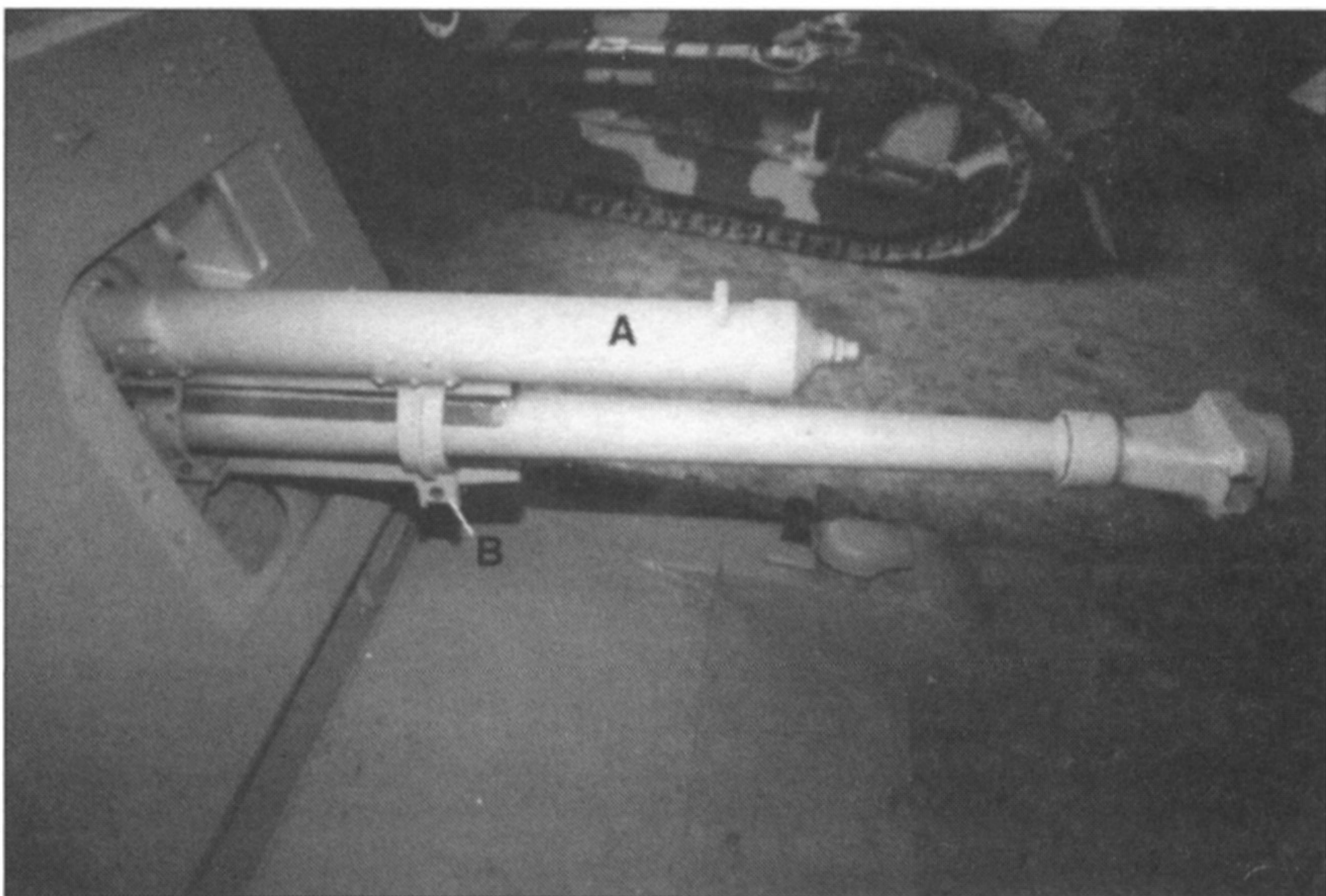
А. Ствол, противооткатный механизм и люлька. В. Скоба, соединяющая люльку с противооткатным механизмом имеет отверстие. С помощью этого отверстия планировалось установить подпорку под ствол.
