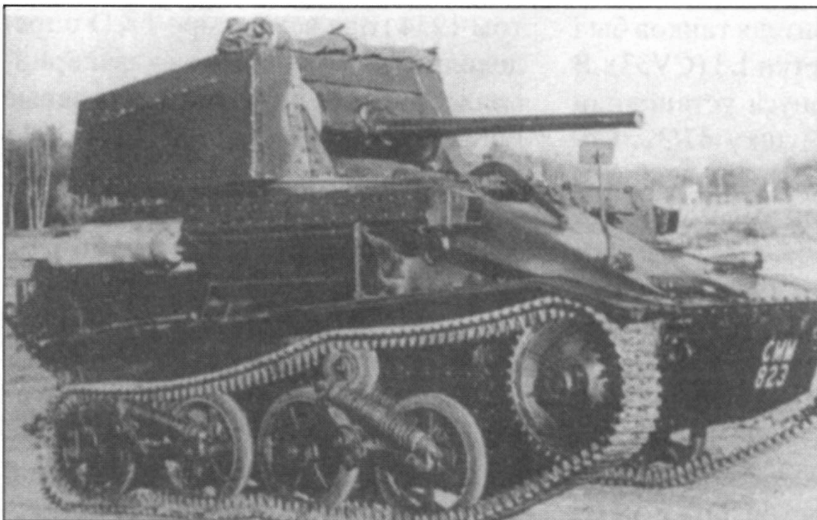
Прототип британского самоходного истребителя танков на шасси Mk VI.
