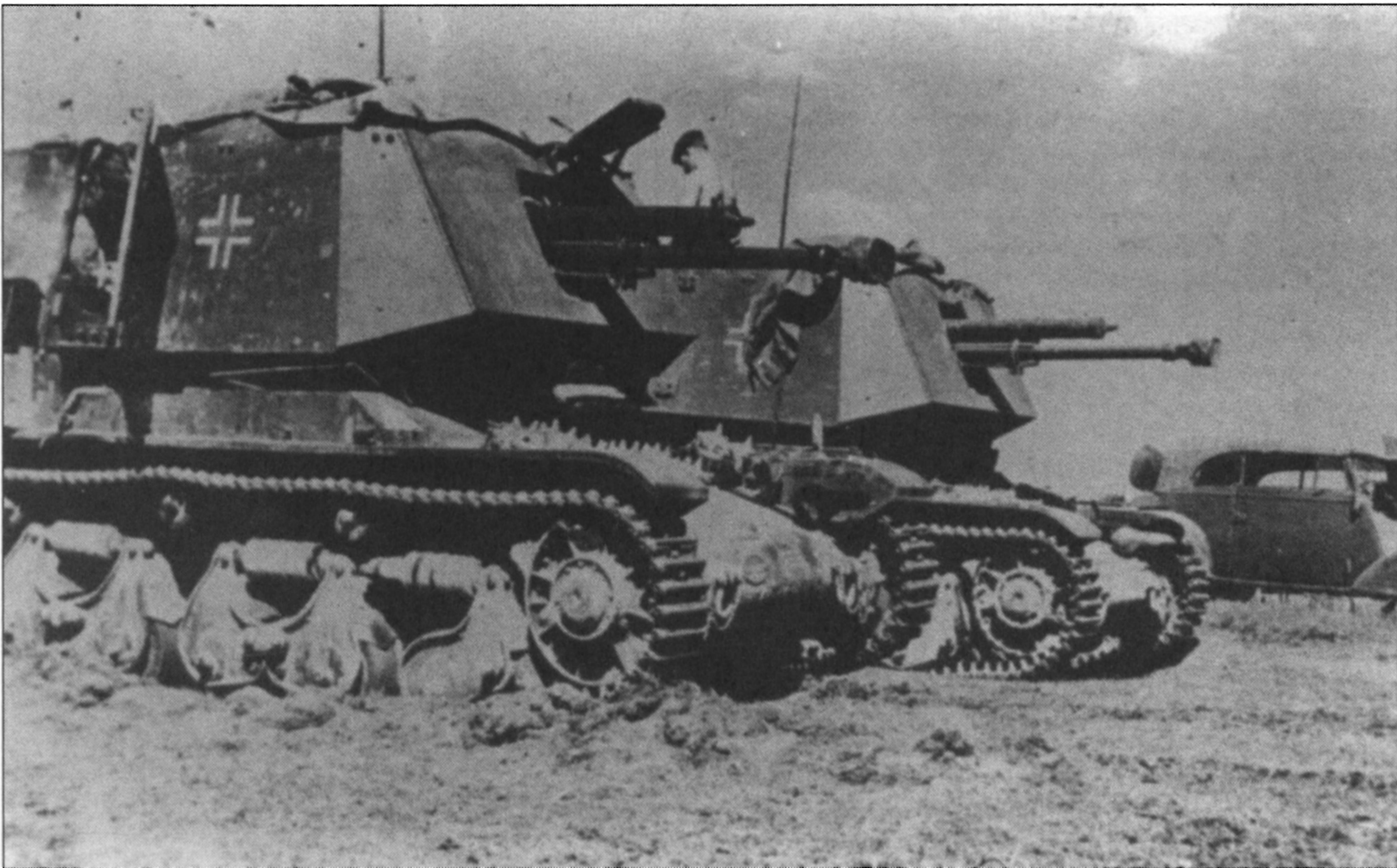
Истребители танков 4,7 см Pak(t) auf PzKpfw 35R(f) ohne Turm, неизвестная часть, 1941 год.
