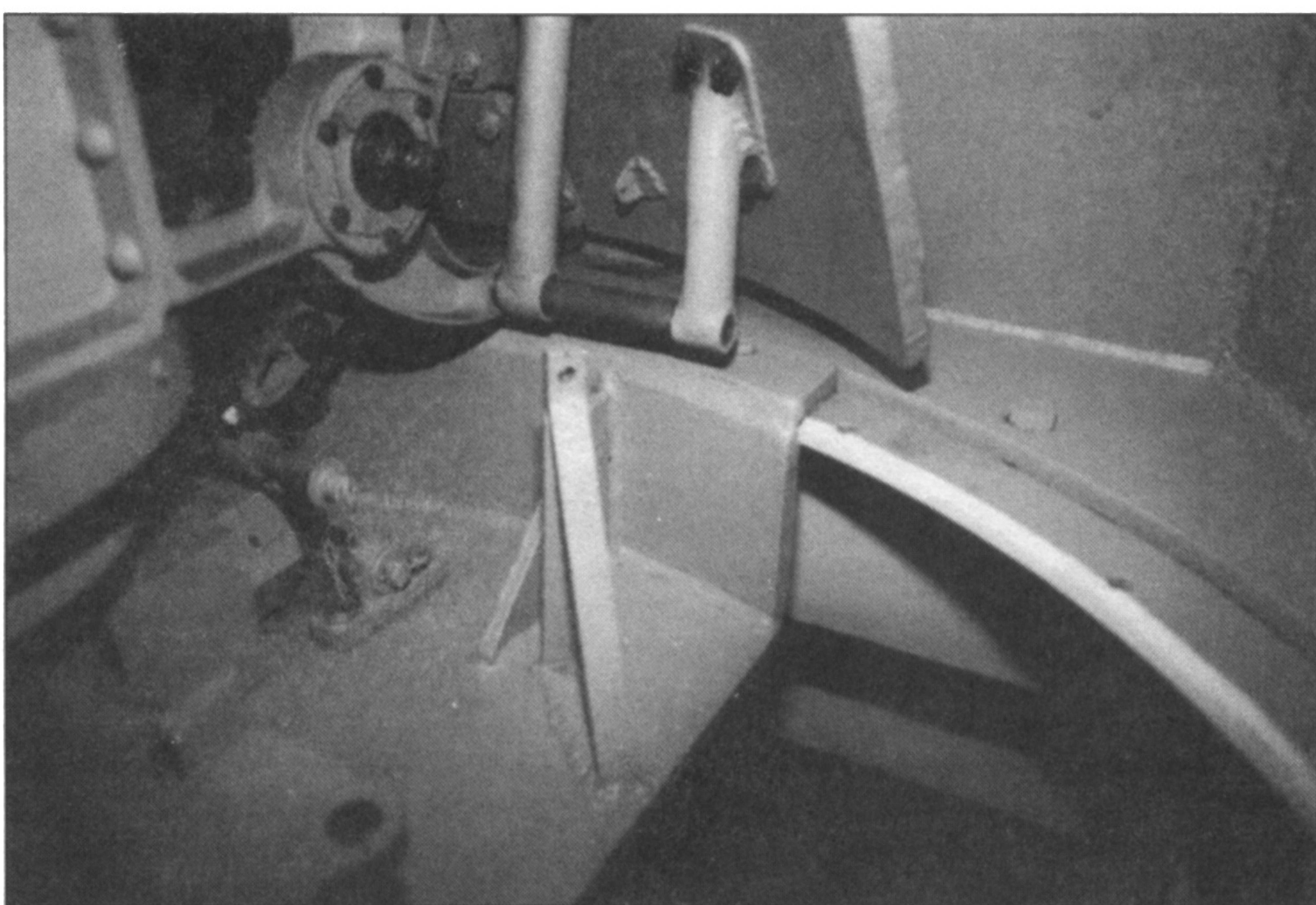
Основание лафета и сектор механизма вертикальной наводки.
