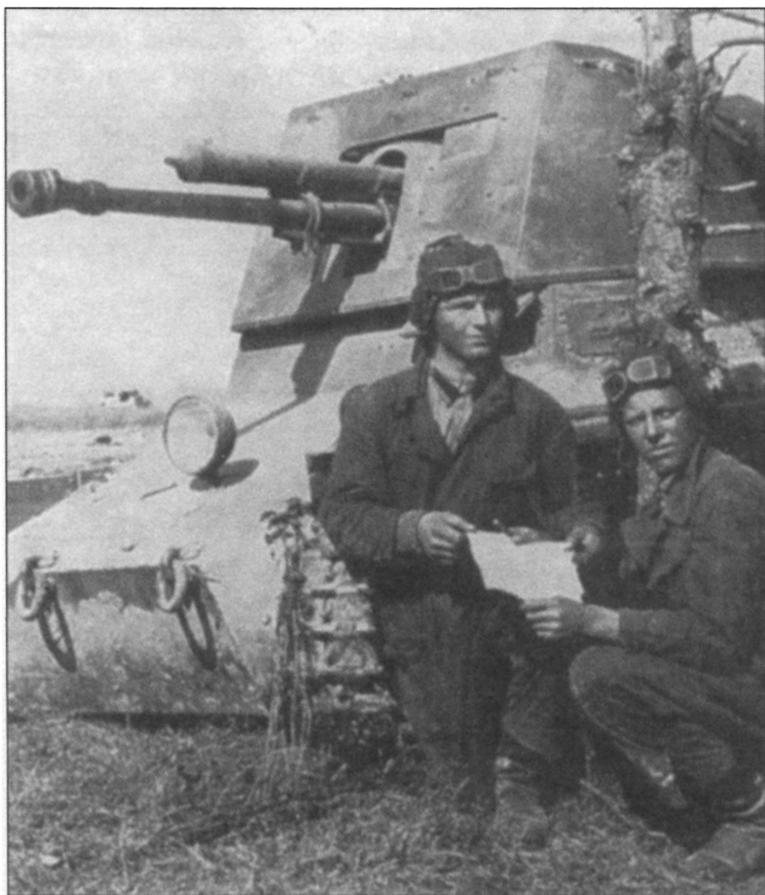
Советский трофейный 4,7 cm Pak (t) auf PzKpfw I Ausf. B SdKfz 101 ohne Turm из танкового батальона 31-й армии, Западный Фронт, 1942 год.
