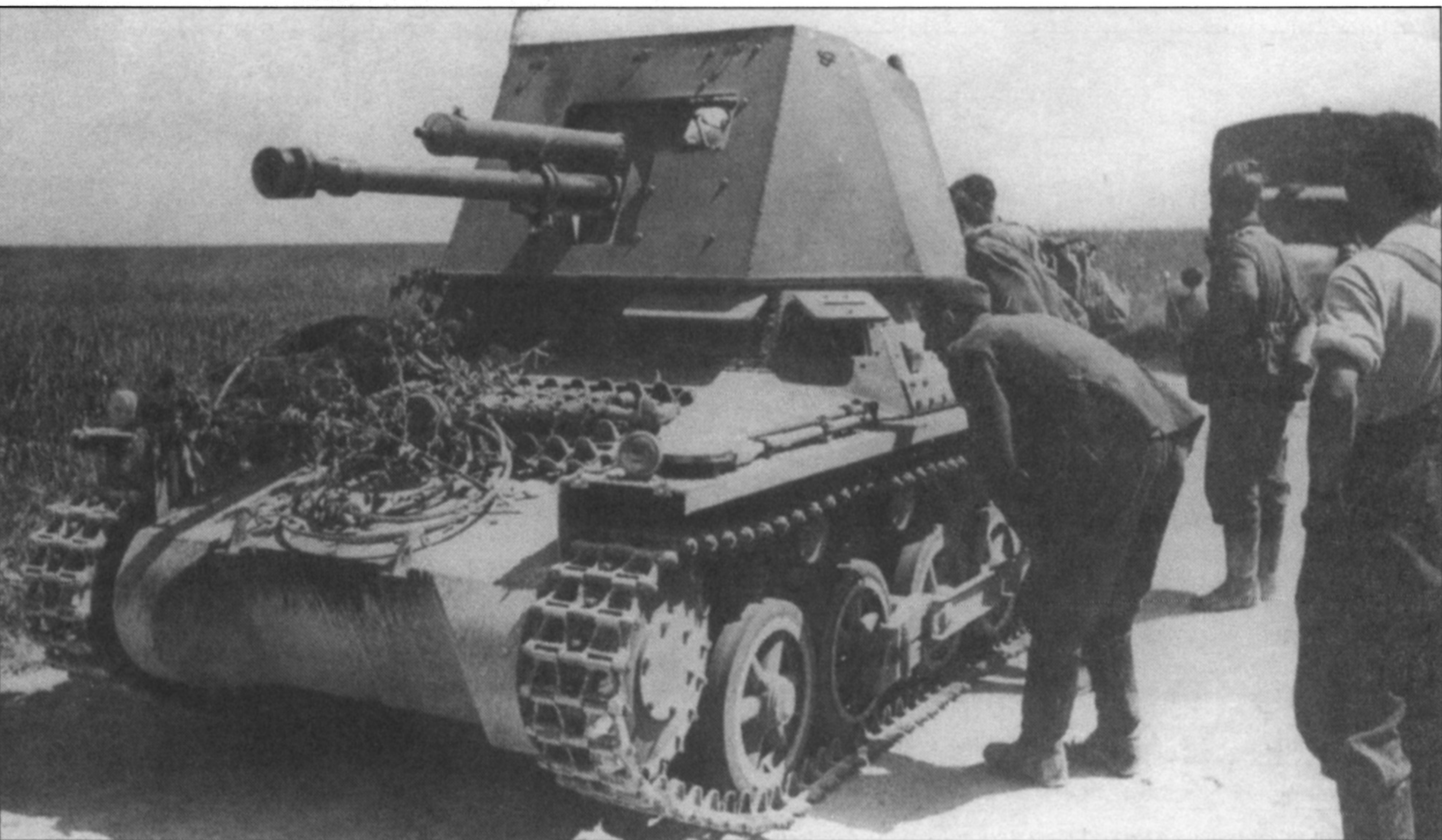
4,7 cm Pak(t) auf PzKpfw I Ausf. B SdKfz 101 ohne Turm из 670-го дивизиона истребителей танков, Франция, май 1940 года.
