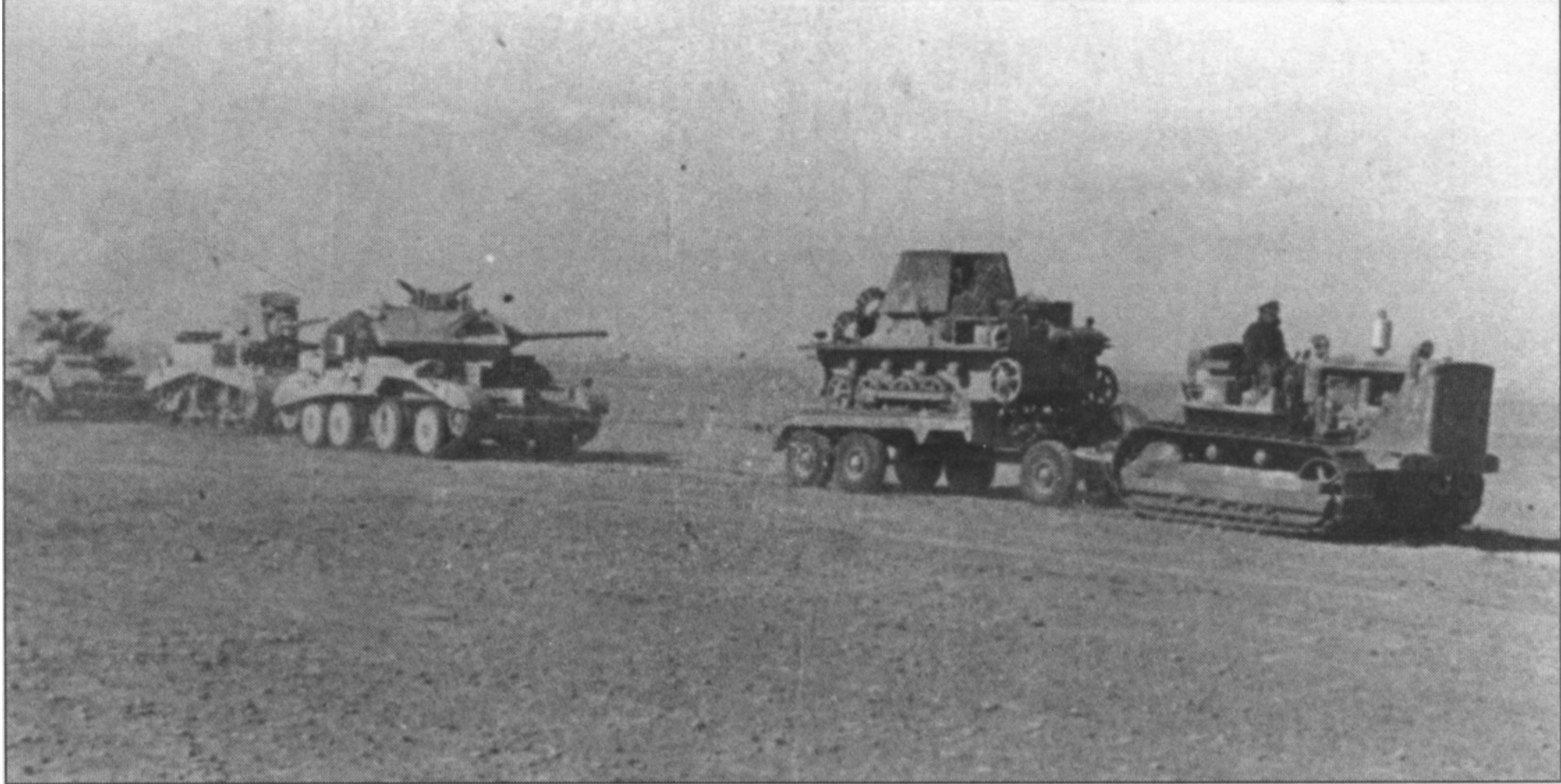
Трофейный поврежденный 4,7 см Pak(t) auf PzKpfw I Ausf. B SdKfz 101 ohne Turm из 605-го дивизиона истребителей танков погружен на трейлер, Африка, 1942 год.
