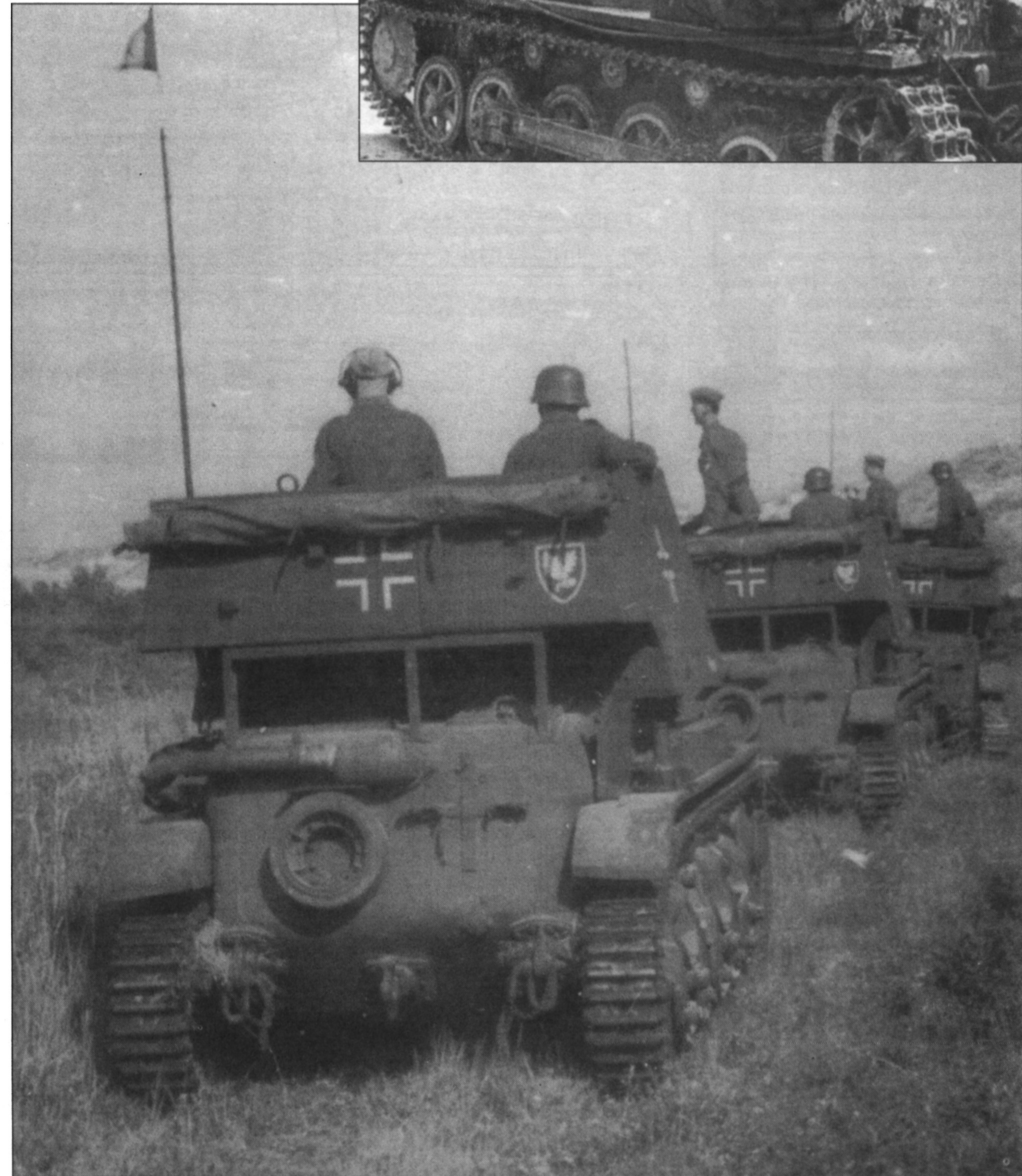
Самоходные истребители танков 4,7 см Pak (t) auf PzKpfw 35R (f) ohne Turm. Видны детали кормы корпуса и особенности кормовой ниши рубки. Машины вероятно принадлежат 559-му дивизиону истребителей танков.
