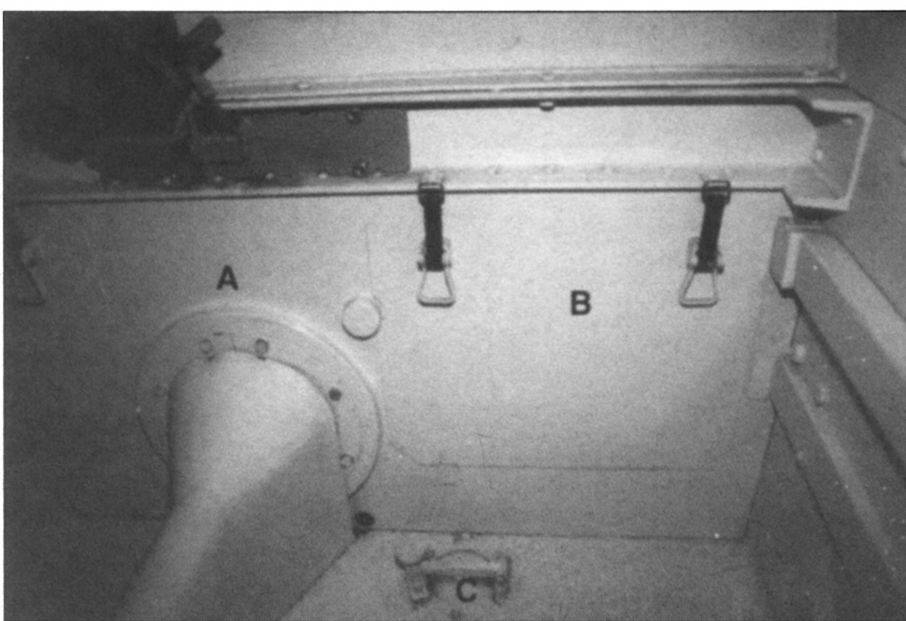
А. Левая часть задней стенки боевого отделения. В. Люк в двигательное отделение. Правый и левый люк имеют разные размеры. Люки оснащались двумя диагональными ребрами жесткости. Третье ребро жесткости шло по краю люка.
