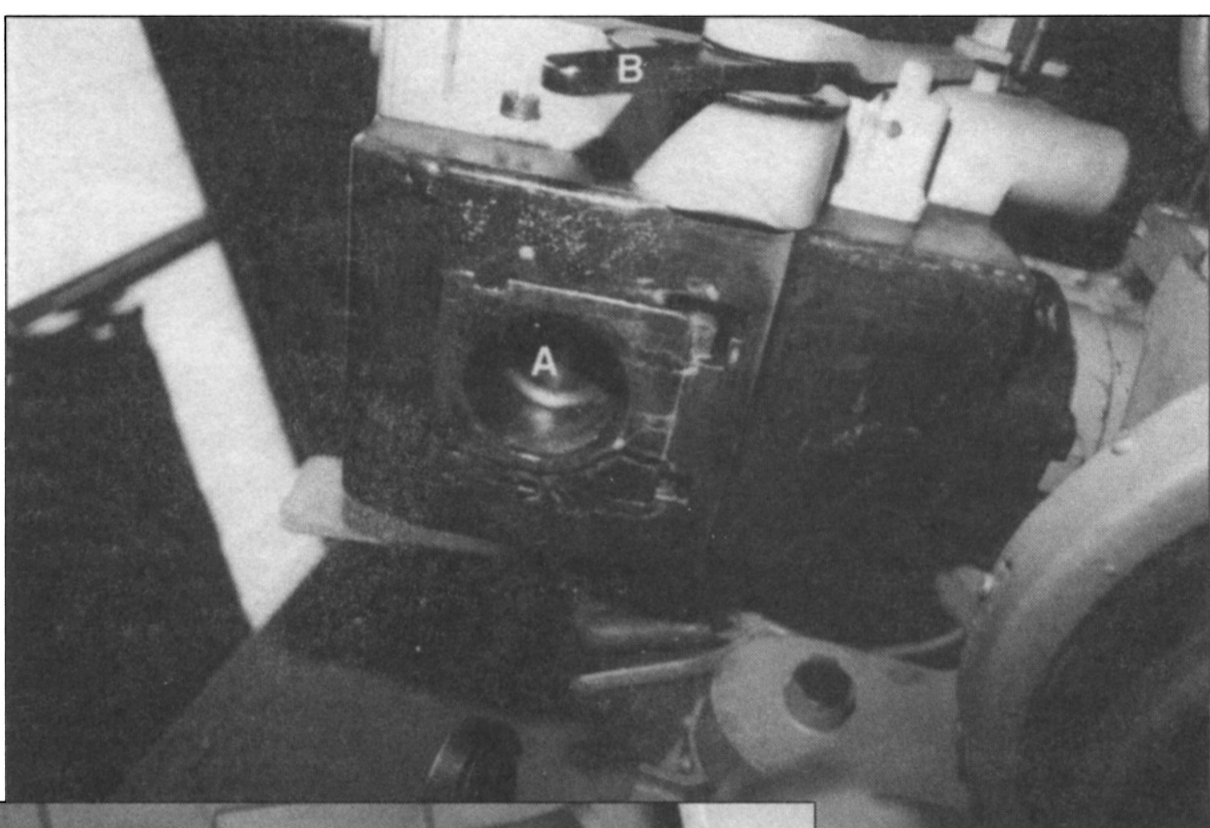
А. Полуавтоматический замок. В. Рукоятка замка.
