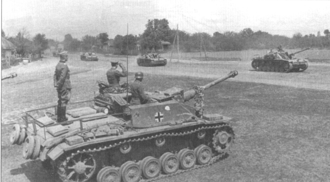
Sturmgeschütz Ausf.G выпуска января 1943 г. (№ шасси находится в диапазоне от 91769 до 91865). Обратите внимание на откидные предкрылки. Ограждение моторного отделения наварено в полевых мастерских.
