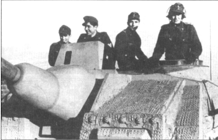
Циммерит, нанесенный на заводе фирмы Алкетт имел «вафельную» текстуру.
