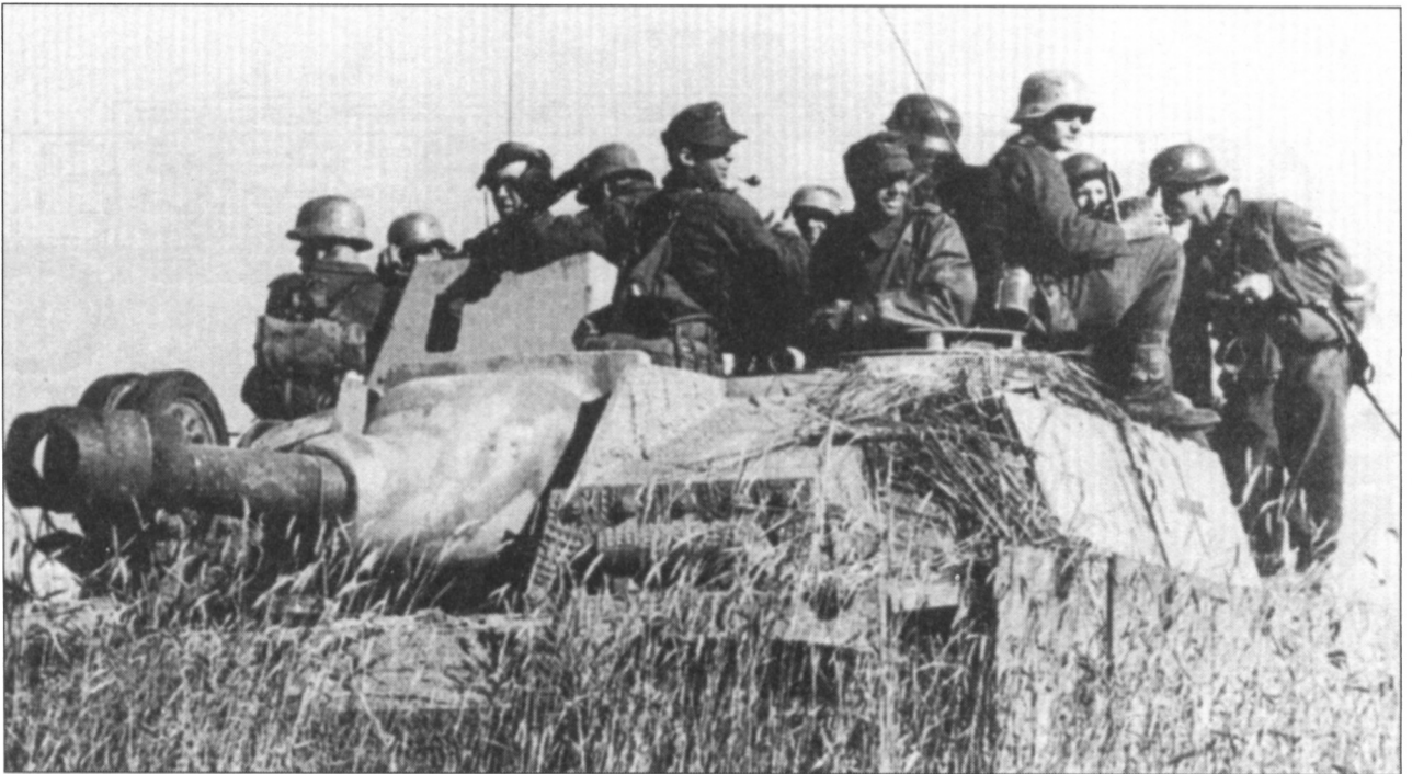
Sturmhaubitze Ausf.G, обратите внимание на маску типа «свиное рыло» и дульный тормоз с боковыми фланцами.
