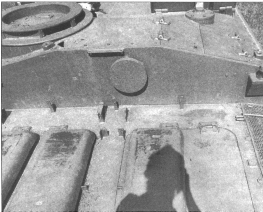
На снимках неплохо видны гнезда «Pilze» под опоры 20-тонного крана-балки. Изготовленная фирмой MIAG (№ шасси 96722) в мае 1944 г. машина была морем переправлена в Финляндию.
