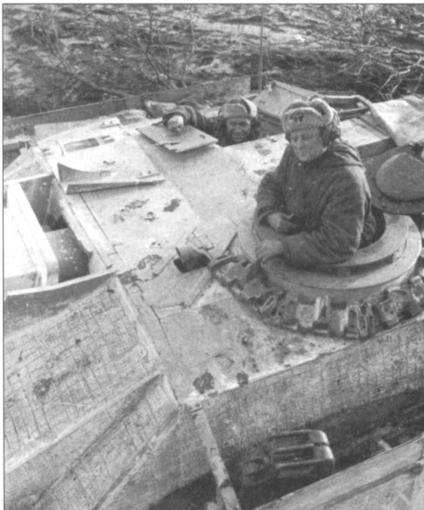
Штурмовое орудие с нанесенным на броню антимагнитным покрытием циммерит. Обратите внимание - для дополнительной защиты вокруг командирской башенки уложены гусеничные траки.
