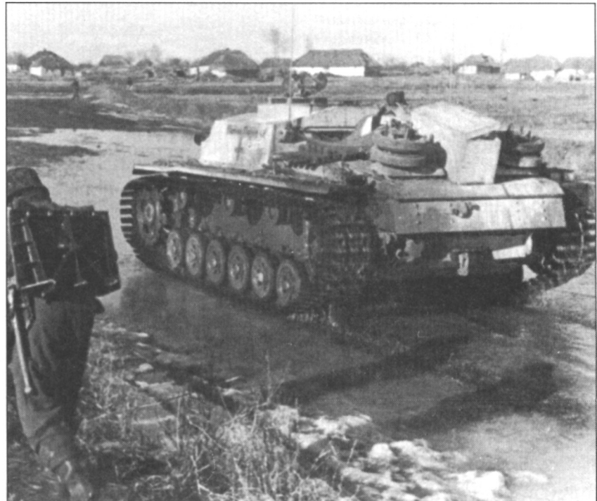
Оснащенная гусеницами с зимними траками машина Sturmgeschütz Ausf.G выпуска декабря 1942. Штурмовое орудие принадлежит 2-му батальону штурмовой артиллерии СС дивизии «Дас Рейх».
