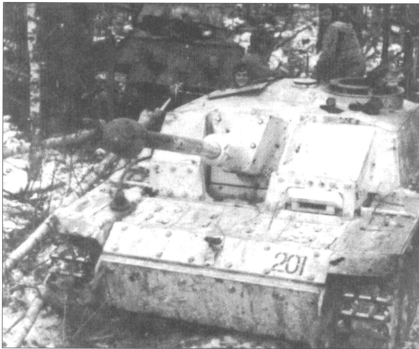
Sturmgeschütz Ausf.G выпуска декабря 1942 г. Рубка оригинальной конструкции, прицел пушки не защищен. В задней части крыши башни, по центру, виден бронеклапан вентилятора.
