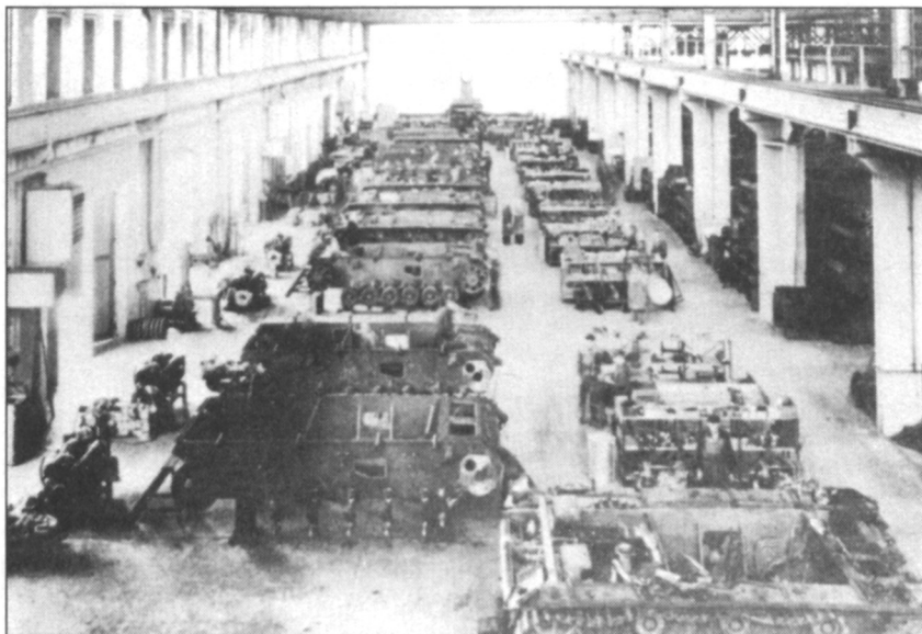
Сборочный цех завода № 40 фирмы Даймлер-Бенц. Линия выпуска шасси танков PzKpfw III, снимок сделан в июне 1940 г.
