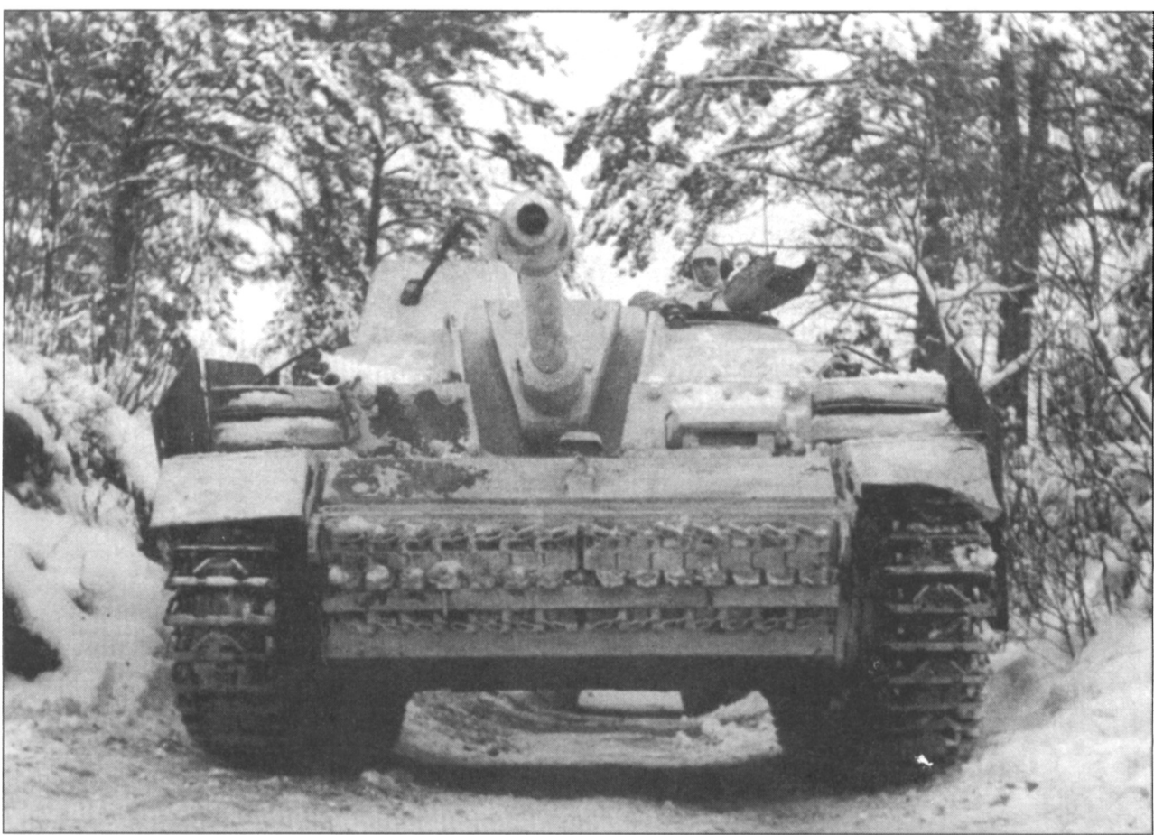
Штурмовое орудие, изготовленное на базе шасси танка PzKpfw III Ausf.M, зима 1943-44 г.г. Машина оснащена траками с антипробуксовочными накладками - они крепятся через один трак и имеют форму незавершенных шевронов.
