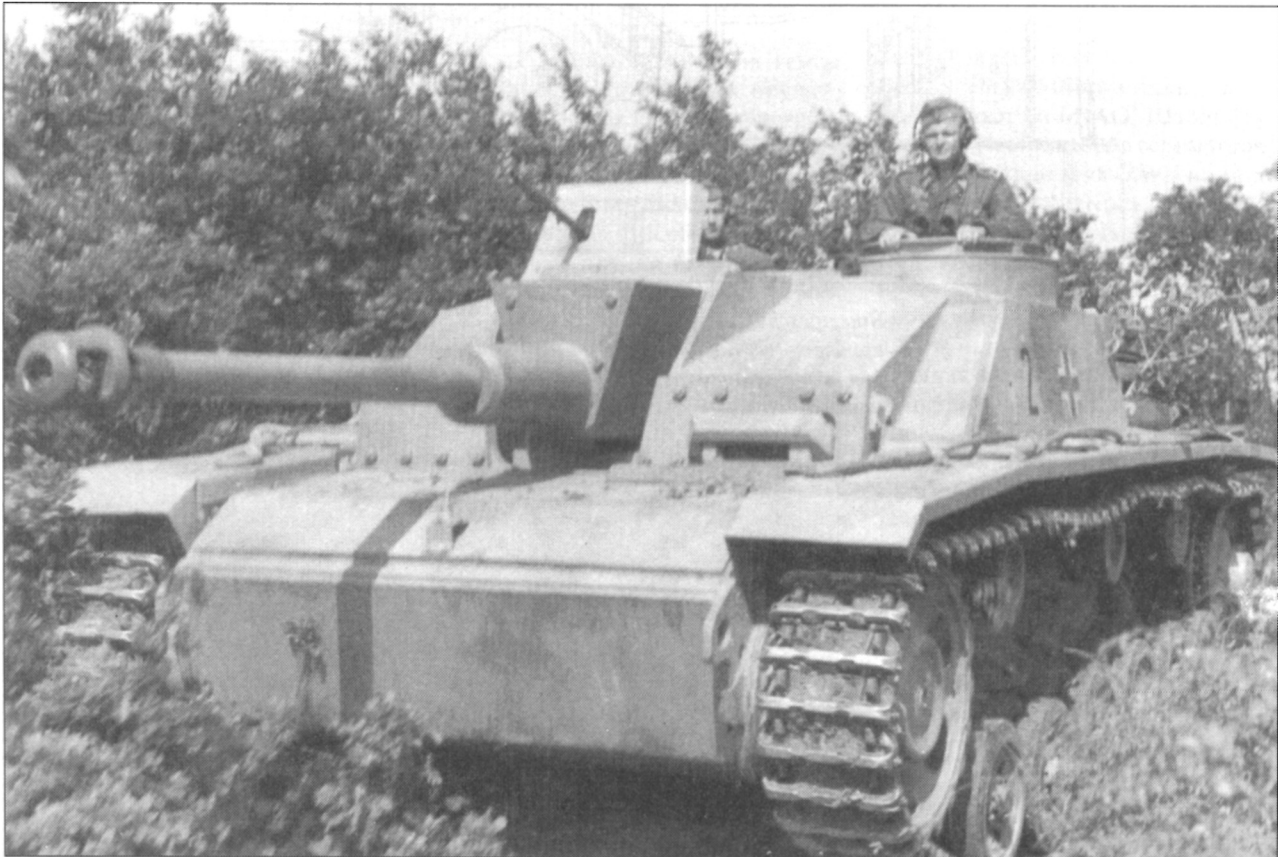
Sturmgeschütz Ausf.G, машина изготовлена на шасси танка PzKpfw III, поставленное фирмой M.A.N. У механика-водителя отсутствует перископический наблюдательный прибор KFF.
