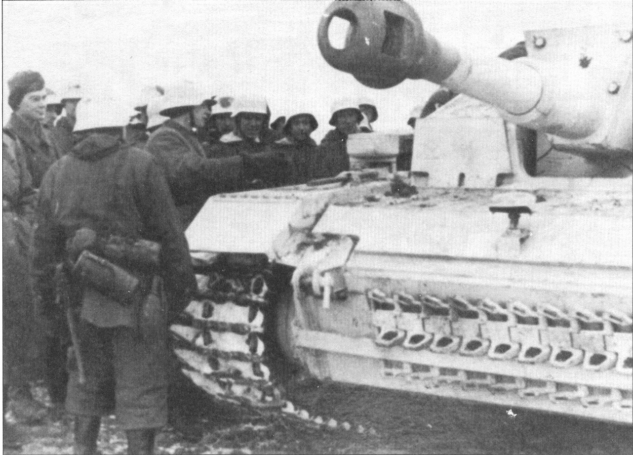
Sturmhaubitze, изготовленная фирмой Алкетт в октябре 1942 г., гаубица смонтирована на базе машины Sturmgeschutz III Ausf.F, обратите внимание на накладную броню корпуса.
