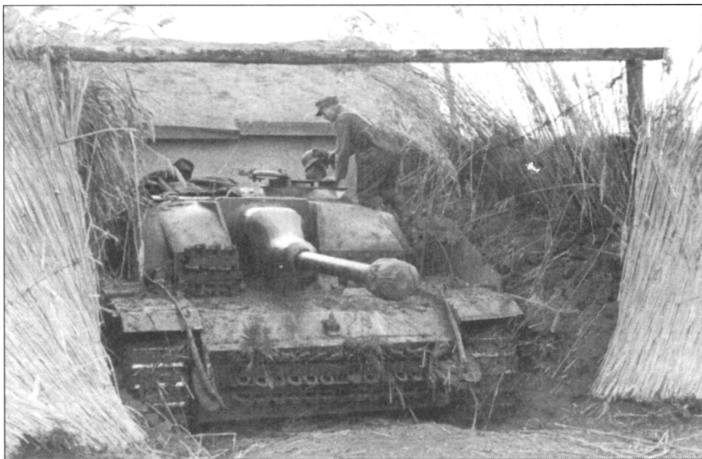
Sturmggeschütz Ausf. G выпуска конца 1943 г., машина изготовлена фирмой Алкетт. Обратите внимание на оружейную маску типа «свиное рыло» и залитые бетоном наклонные бронелисты над местом механика-водителя и справа от пушки.
