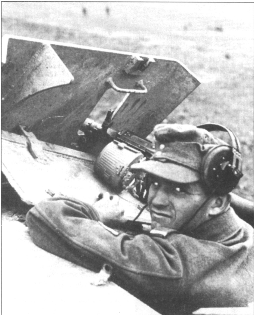
Пулеметная установка на крыше штурмового орудия, усовершенствованные щитки начали монтировать на машины, начиная с осени 1943 г.
