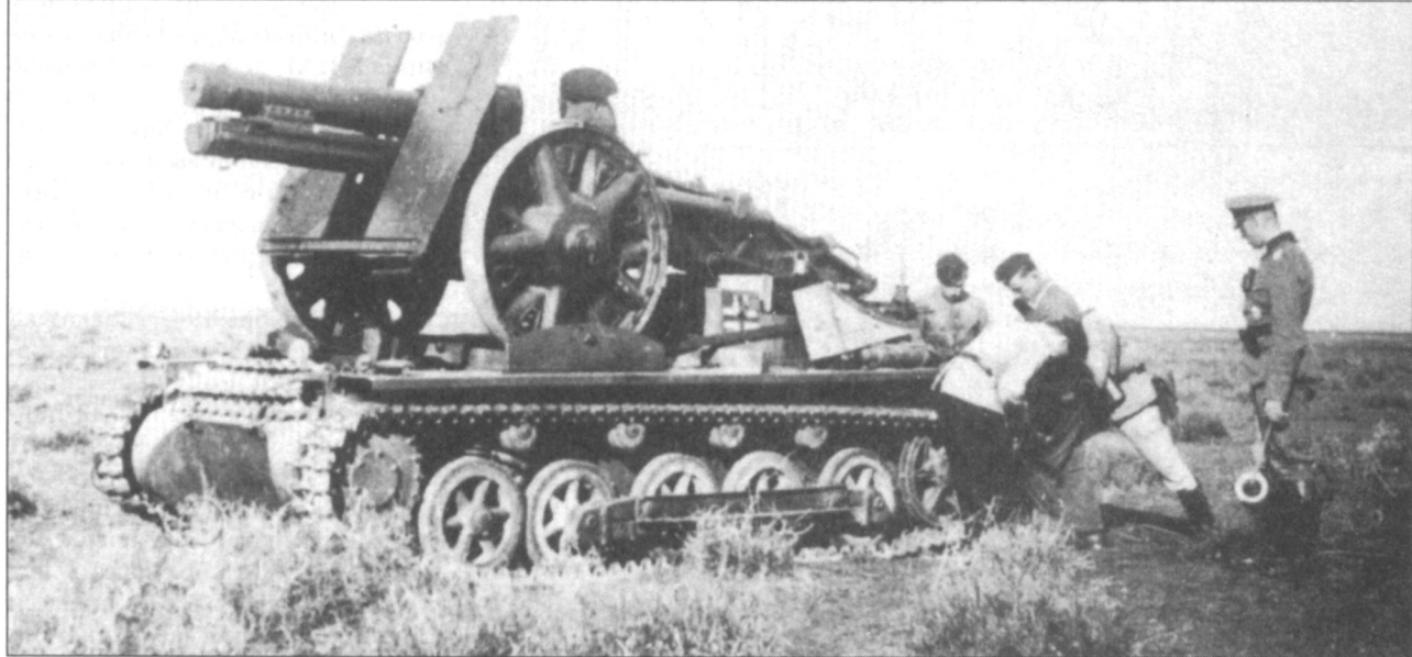
Установка 150-мм пушки sIG33 на шасси танка PzKpfw I Ausf. B, броня рубки демонтирована.
