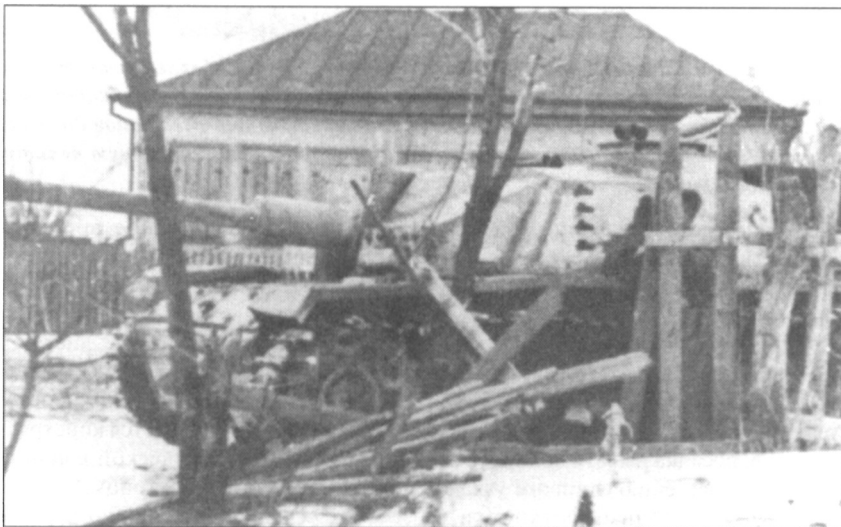
Sturmgeschütz Ausf.G. Приглядевшись можно заметить боковой смотровой прибор механика-водителя. На рубке нанесены победные марки в виде профилей танков Т-34.
