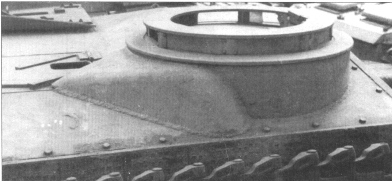
Стальной дефлектор, наваренный перед фронтальной частью командирской башенки.
