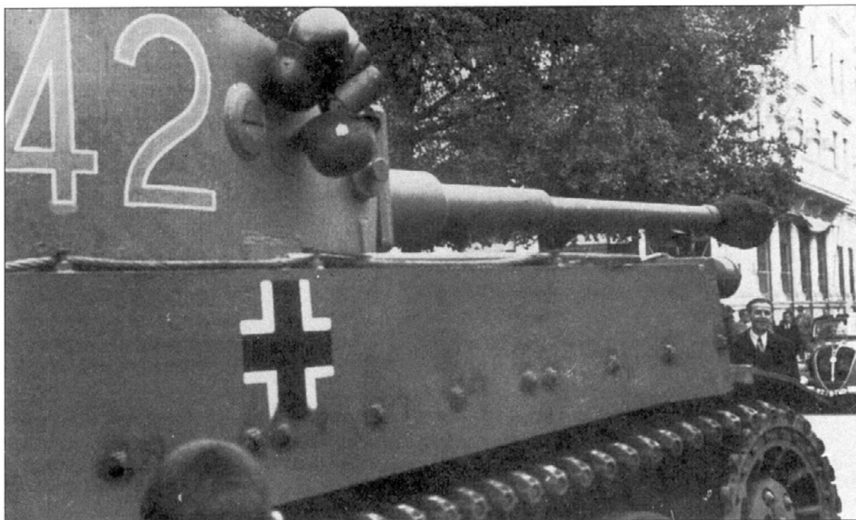
«Тигр» раннего выпуска в транспортном варианте - отсутствует «юбка» по бортам корпуса, узкие транспортные гусеницы вместо боевых, передние крылья - изогнутые узкие. Танк предназначен к отправке в Северную Африку и окрашен в темно-желтый цвет.
