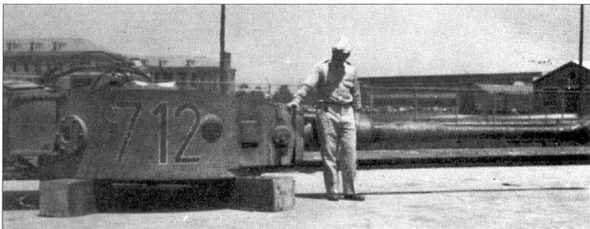
Башня «Тигра» нуль-серии - пушечный порт вместо эвакуационного люка
