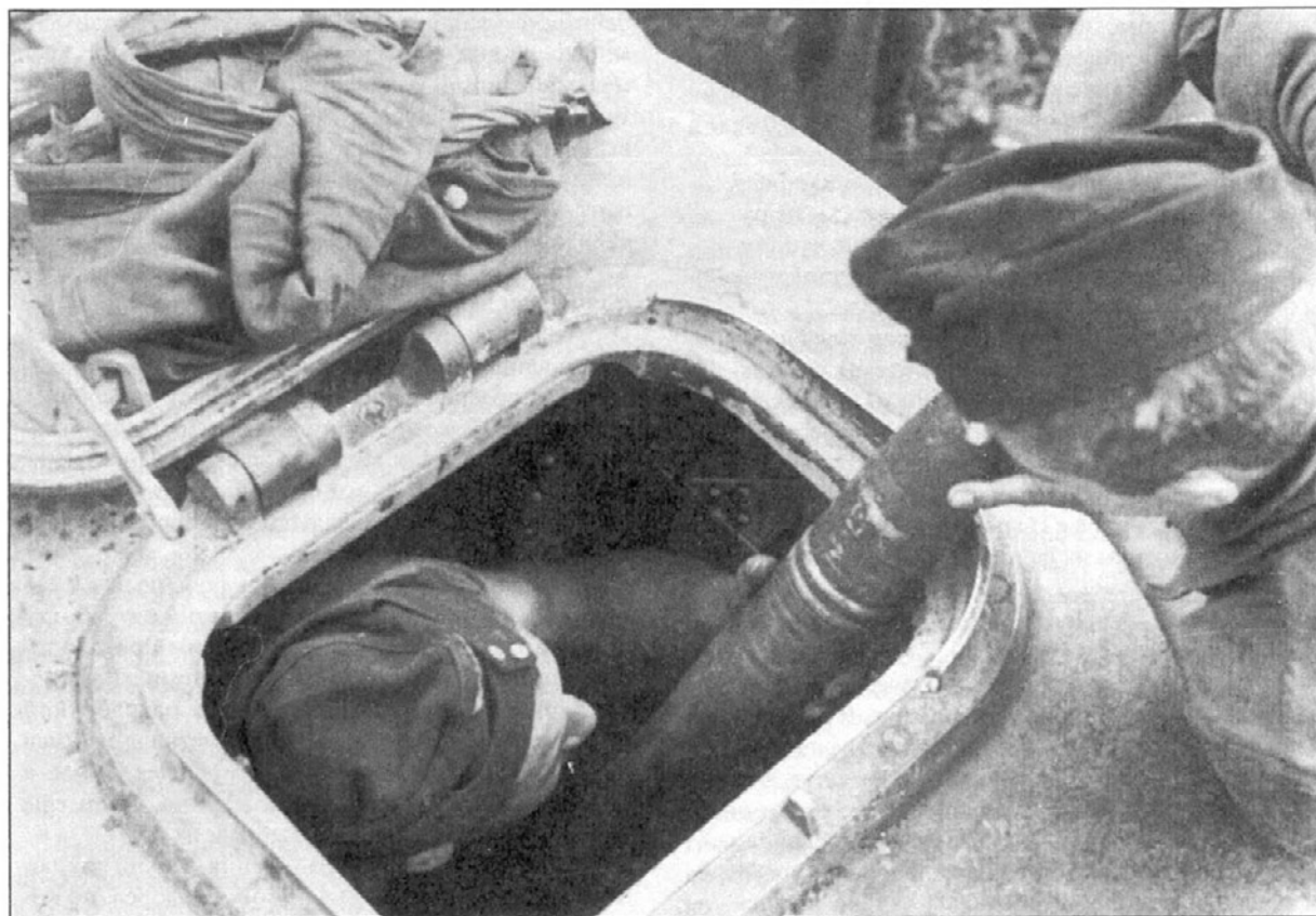
Погрузка боеприпасов в танк через люк заряжающего
