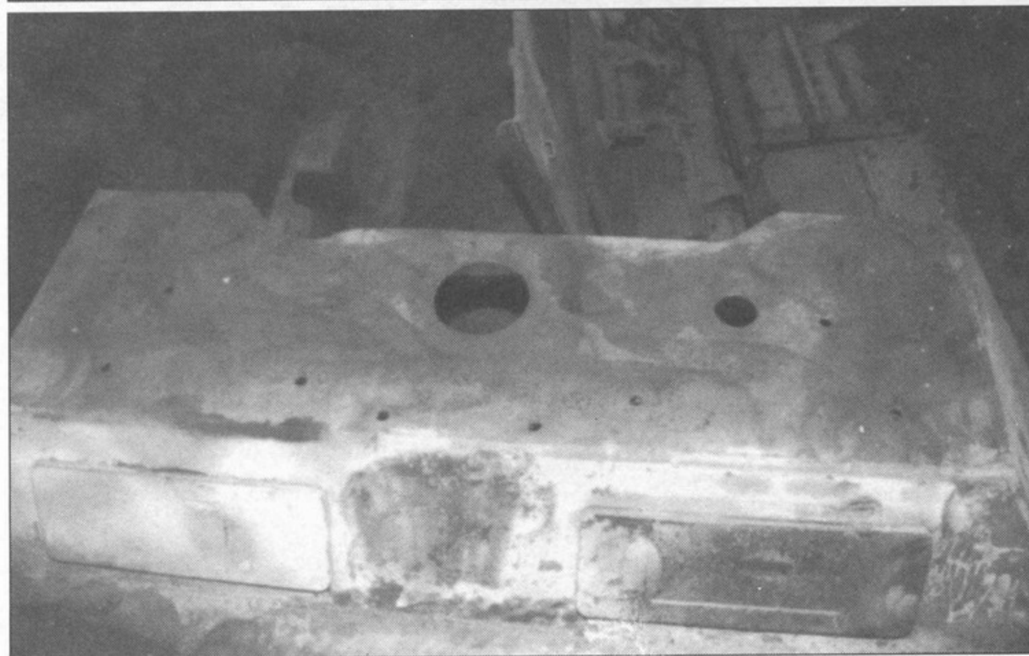
Лобовая броня на месте крепления пушки. Отверстие правого смотрового прибора наглухо заварено заглушкой. Упрощенный смотровой прибор механика-водителя напоминает тот, что стоял на машинах Ausf. A.
