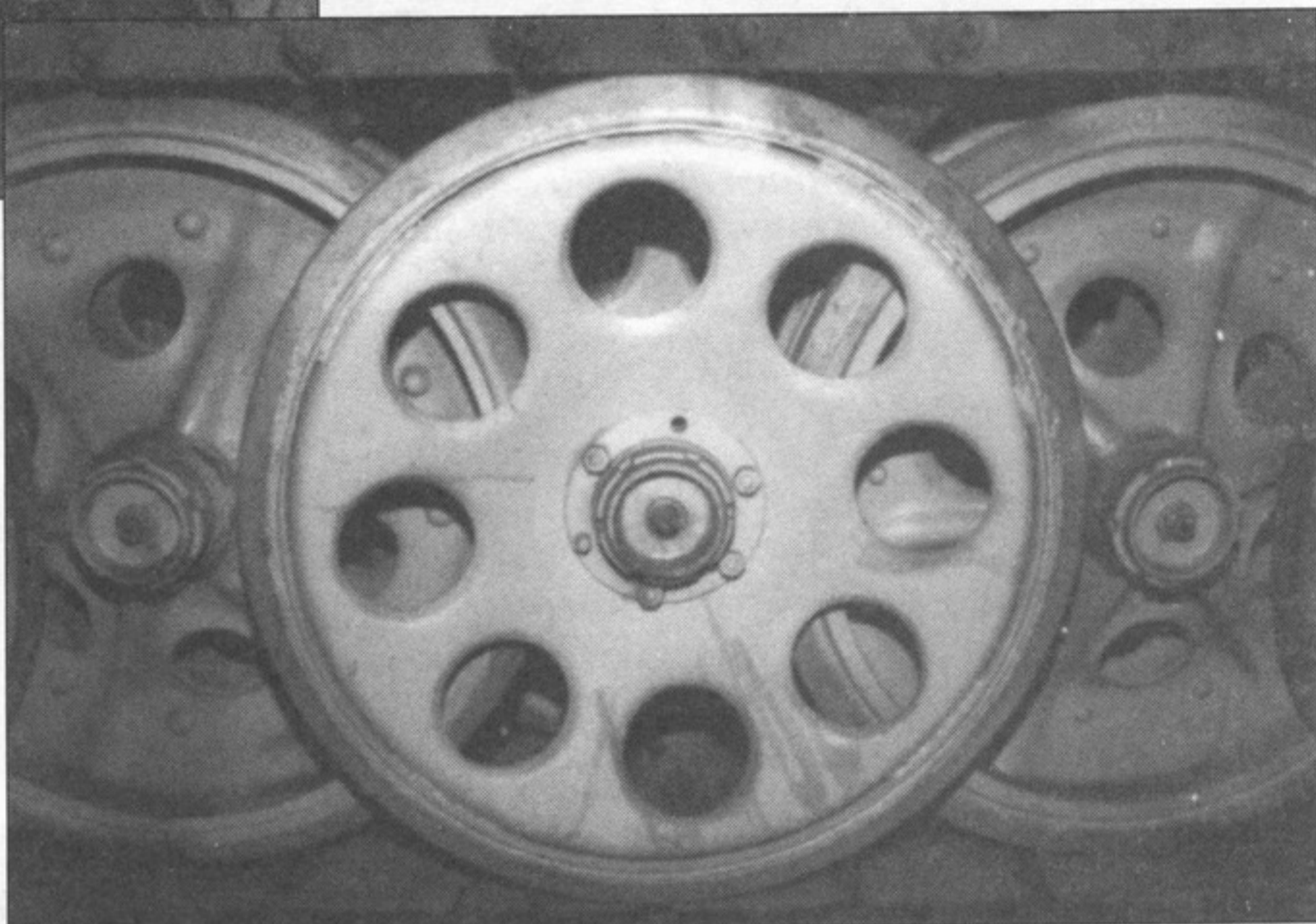
Опорные катки крупным планом. На каждом борту было три внешних и три внутренних сдвоенных катка. Конструкция внутренних и внешних катков различалась, и те и другие имели резиновый бандаж.
