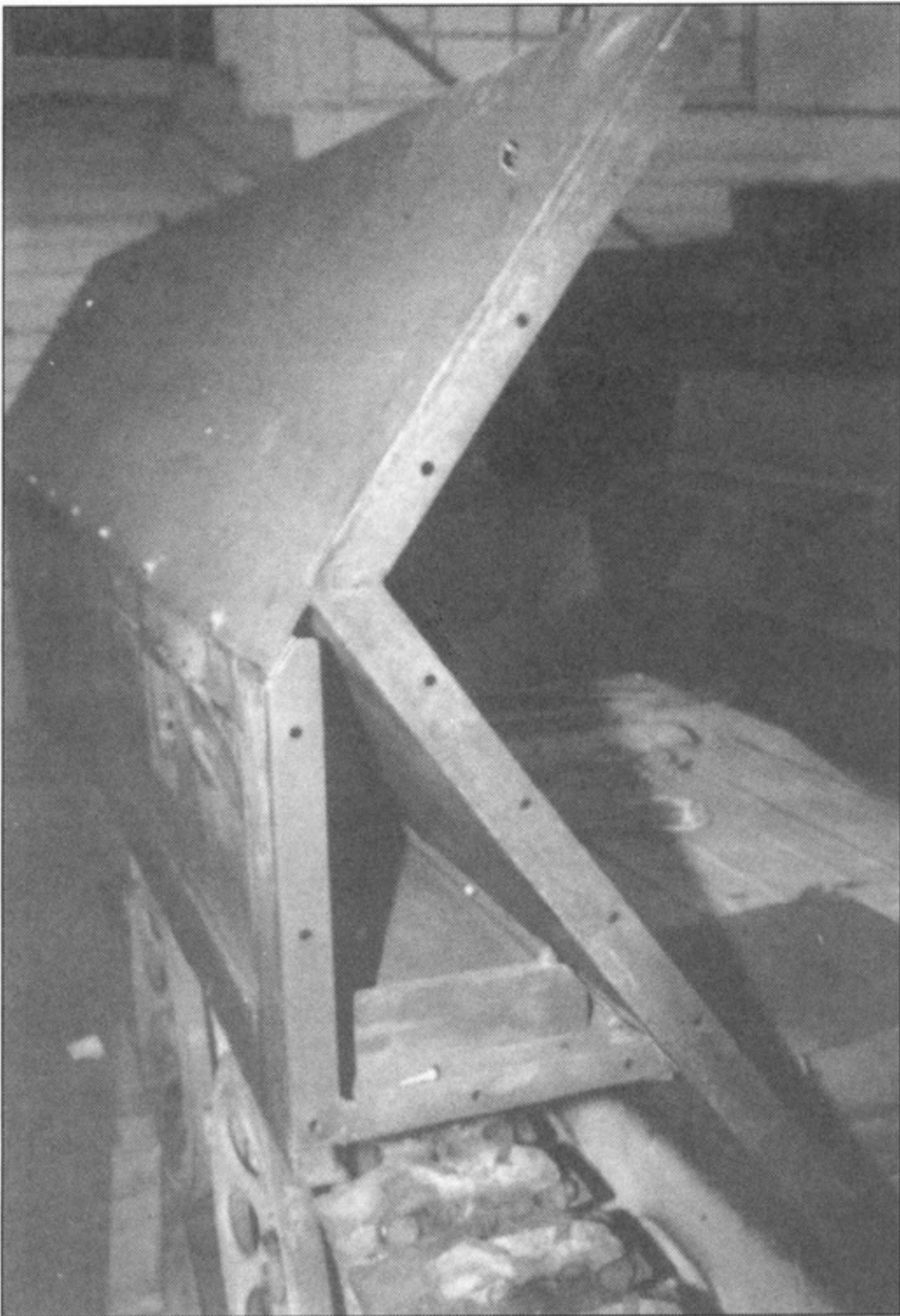
Кузов боевого отделения соединялся с кузовом поста управления болтами.
