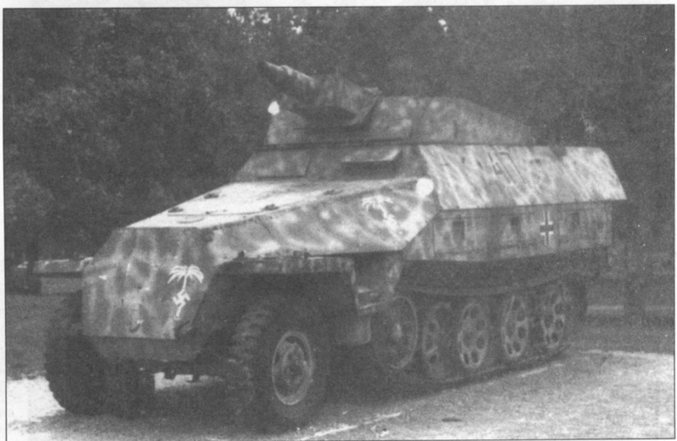
Вид слева и спереди. Машина находится в хорошем состоянии, лишь передние колеса (шины и диски) восстановлены американцами.
