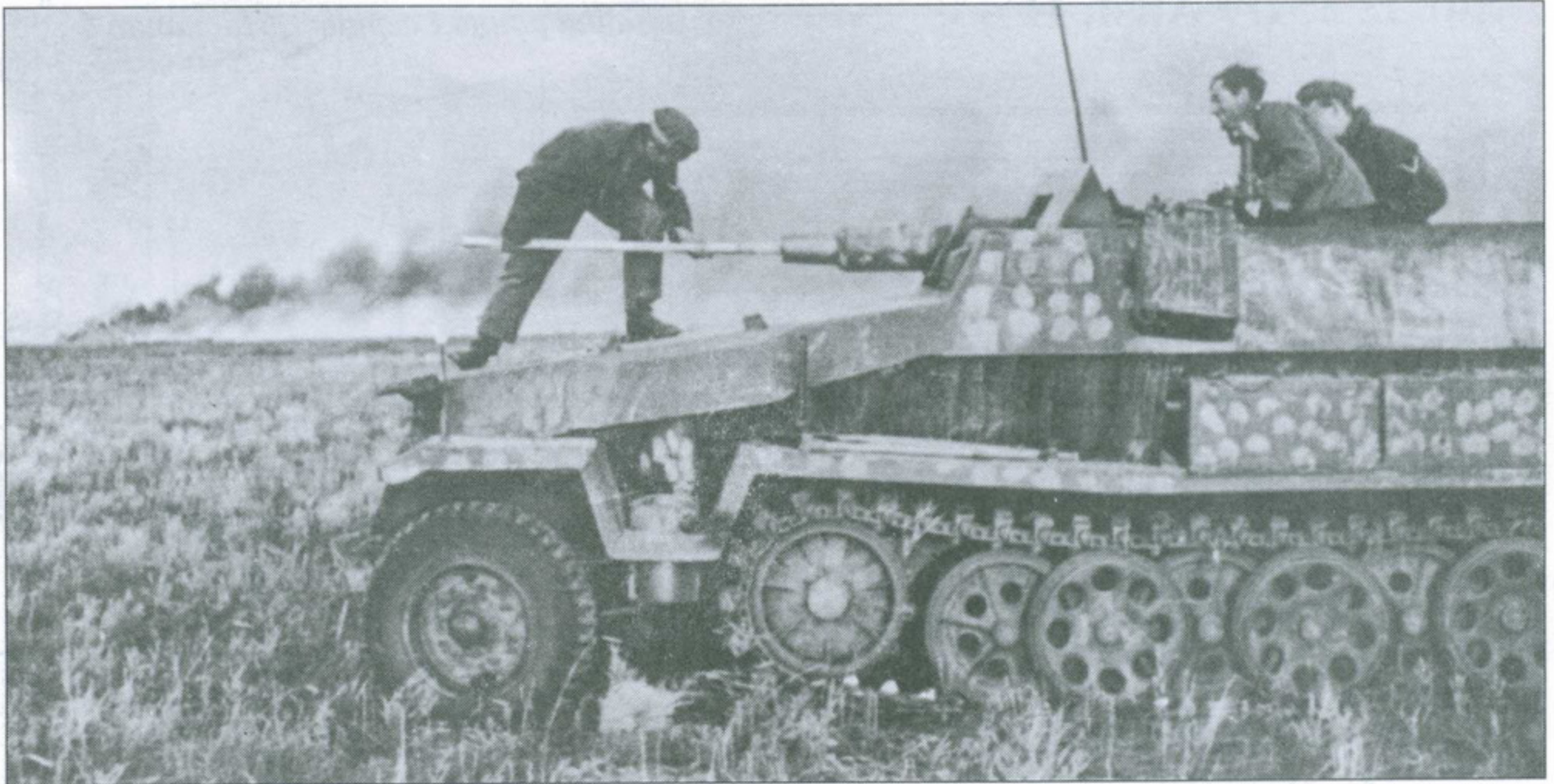
Один из членов экипажа чистит ствол у SdKfz 251/9 Ausf. C. Обратите внимание на импровизированный камуфляж машины - желтые пятна на сером фоне.
