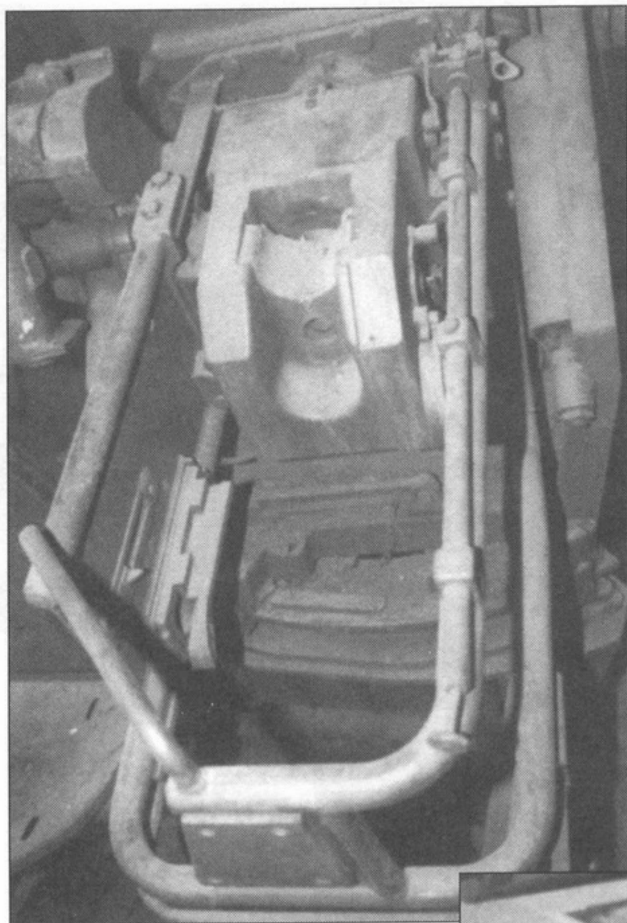
Орудийная люлька, вид сзади. Отчетливо видна кнопка электрического спуска.
