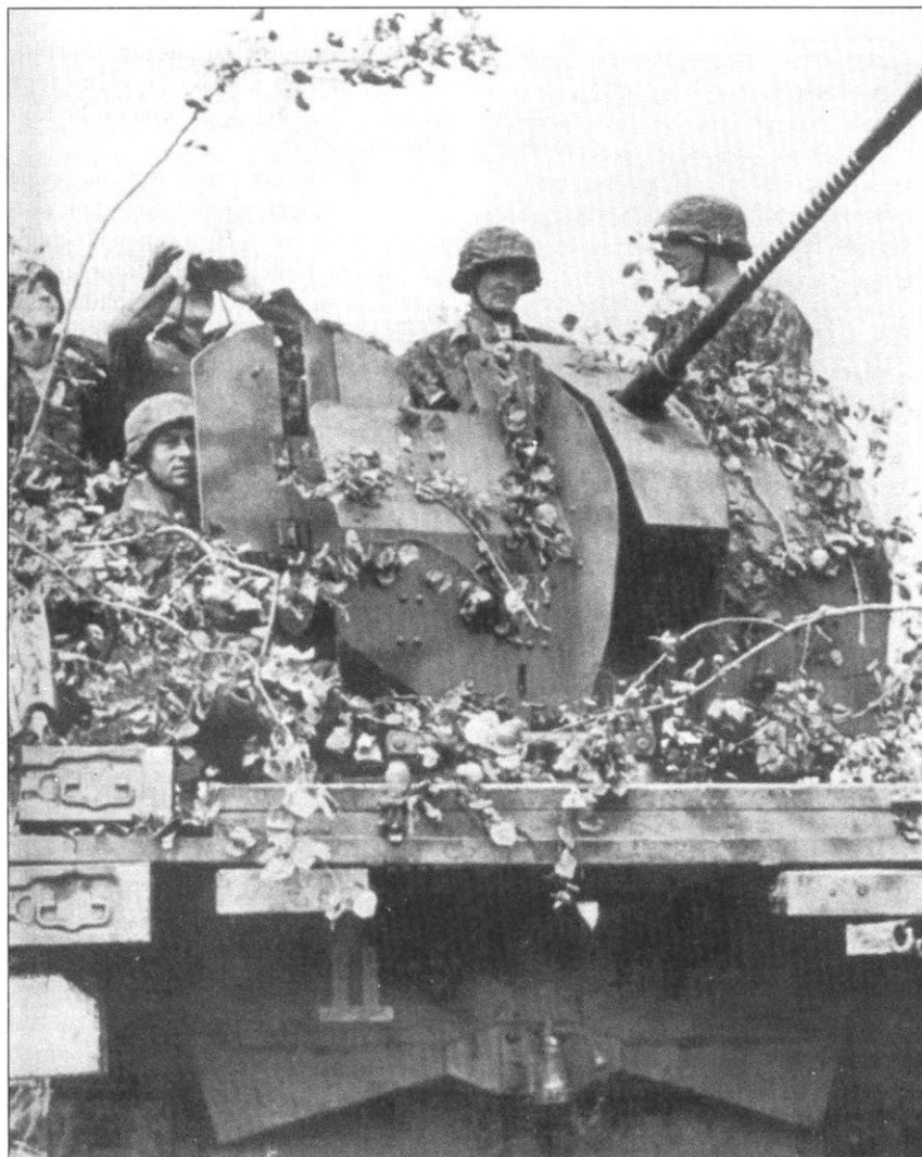
Вид сзади на полугусеничную зенитную самоходную установку SdKfz 10, вооруженную 20-мм зенитной пушкой. На стволе пушки 16 отметок о победах. Внизу на корпусе машины видна тактическая эмблема дивизии «Das Reich».
