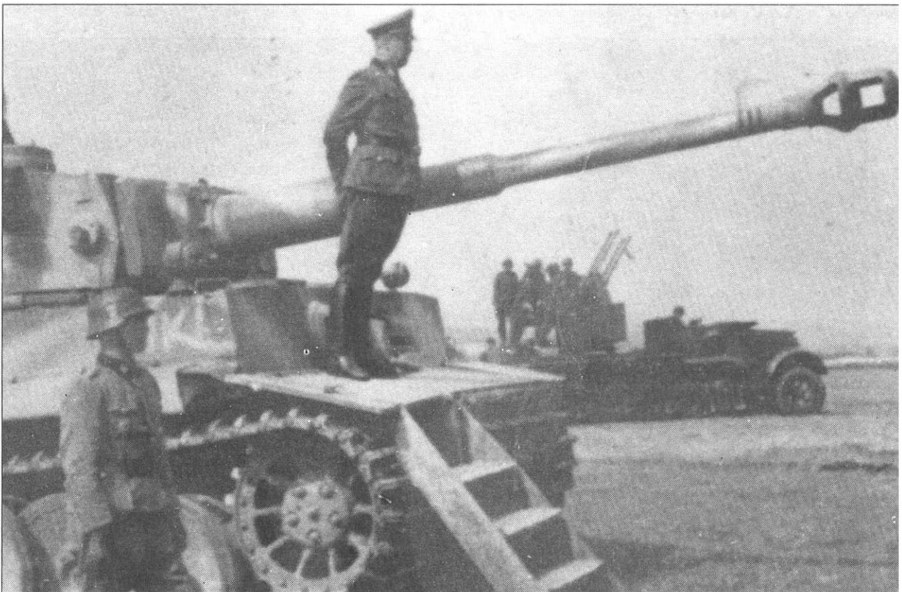
Экипаж танка «Тигр» дивизии «Дас Рейх» на церемонии вручения Рыцарских крестов за сражение под Курском. Несмотря на превосходную конструкцию, экипажи «Тигров» имели целую гамму проблем, прежде всего связанных с ходовой частью. Перекрывающиеся опорные катки часто смерзались из-за налипшей между ними грязи, их также клинили камни. Обратите внимание - на заднем плане видная счетверенная 20-мм зенитная установка Flakvierling-38 на базе полугусеничного броневедомола SdKfz.
