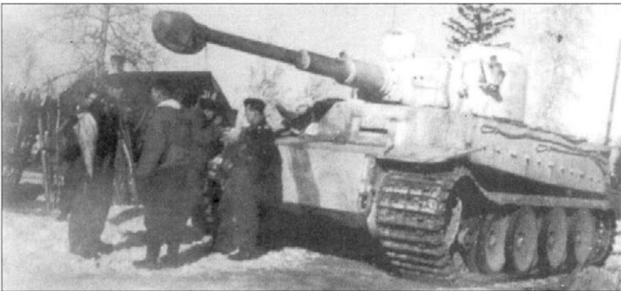
Танк «Тигр» в типичной белой зимней окраске, зима 1942-43 г.г. Хорошо видны болты в борту корпуса, предназначенные для фиксации секций крыла; такие крепления появились на танках «средних» серий.
