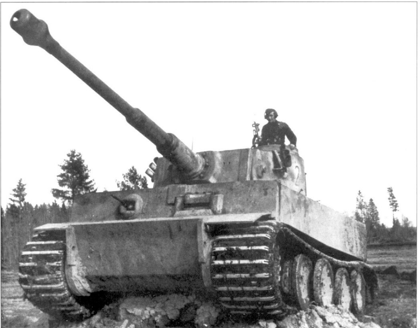
«Тигр» угрожающе выглядит даже на фотографии. На снимке - машина с бортовым номером «2», это - танк из первой производственной серии. Снимок сделан весной 1943 г. Обратите внимание на отсутствие фиксаторов секций крыльев в бортах корпуса.
