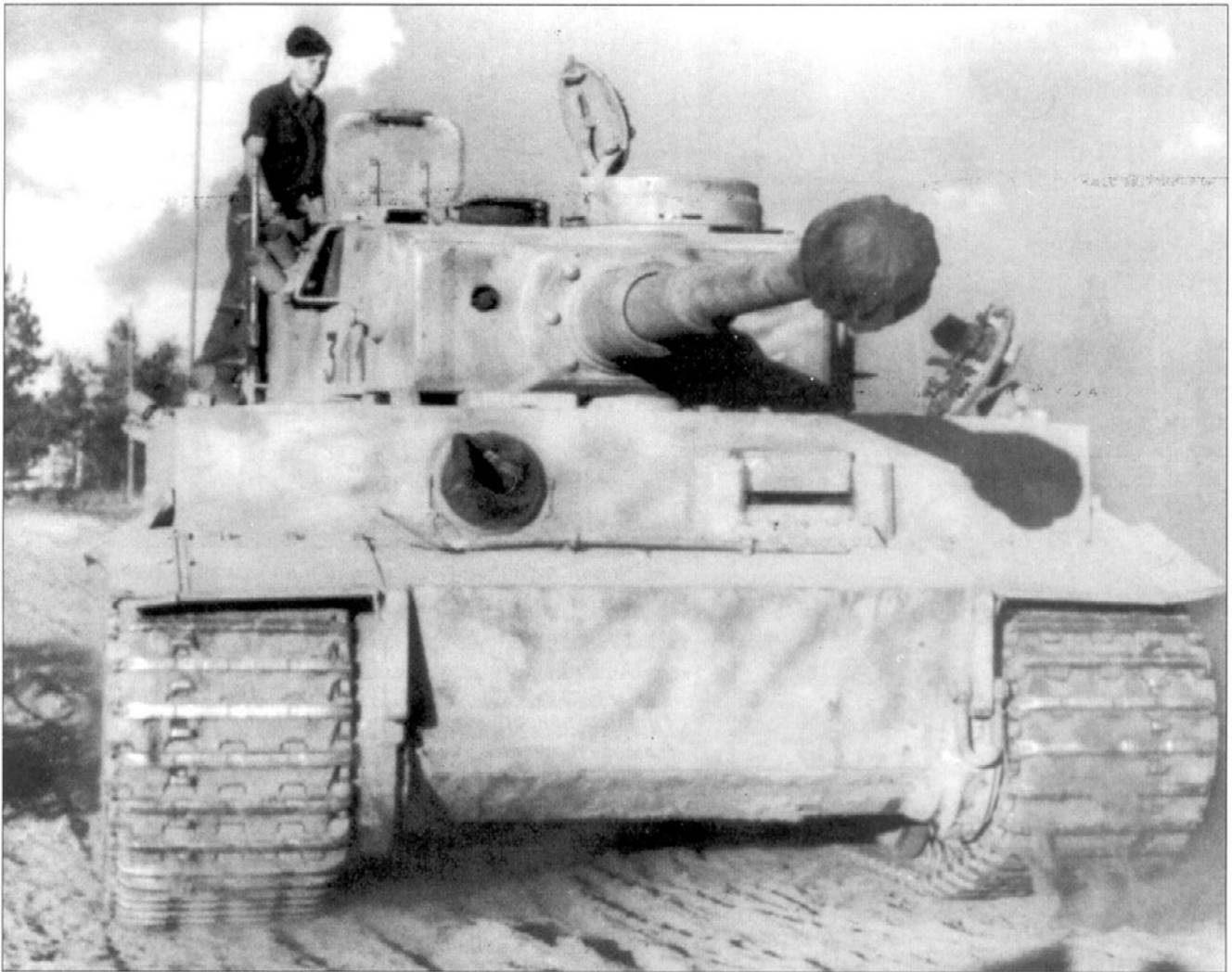
Танк «Тигр» с бортовым номером «311», вид спереди. При очень большом желании с трудом можно разобрать изображение мамонта на лобовом бронелисте корпуса слева от курсового пулемета. Полосатый разрушающий камуфляж был характерен для машин 3-й роты.
