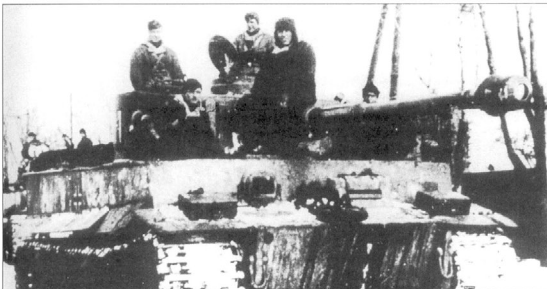
«Тигр I» с тактическим номером «111», январь 1943 г. На наклонном лобовом бронелисте корпуса закреплены два ящика с инструментами.
