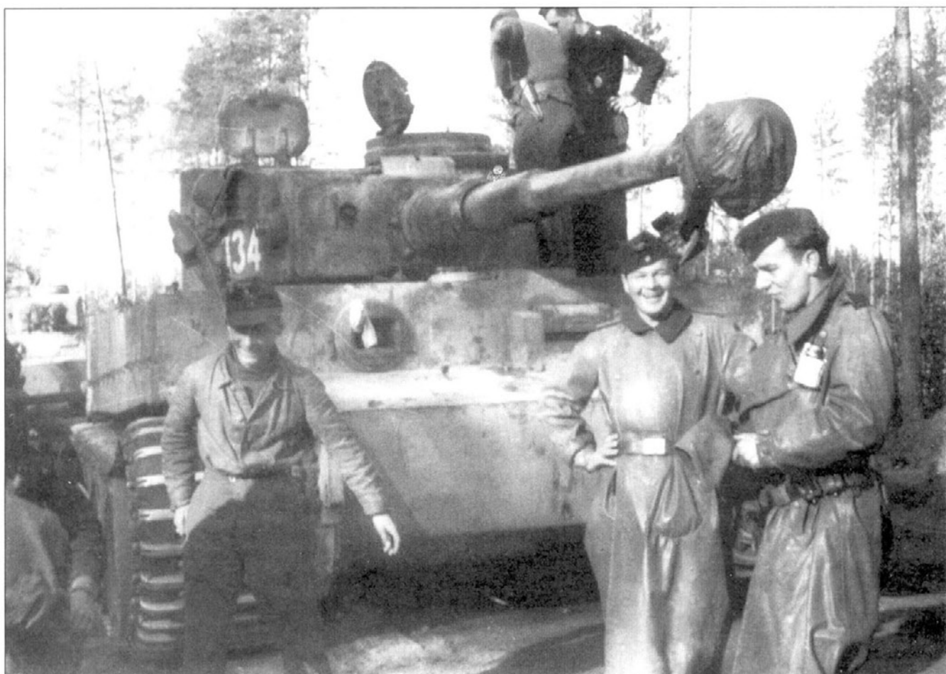
«Тигр» с бортовым номером «134» также с полным правом можно считать ветераном Восточного фронта, это машина одной из первых производственных серий, поскольку на ней отсутствуют бортовые крылья.
