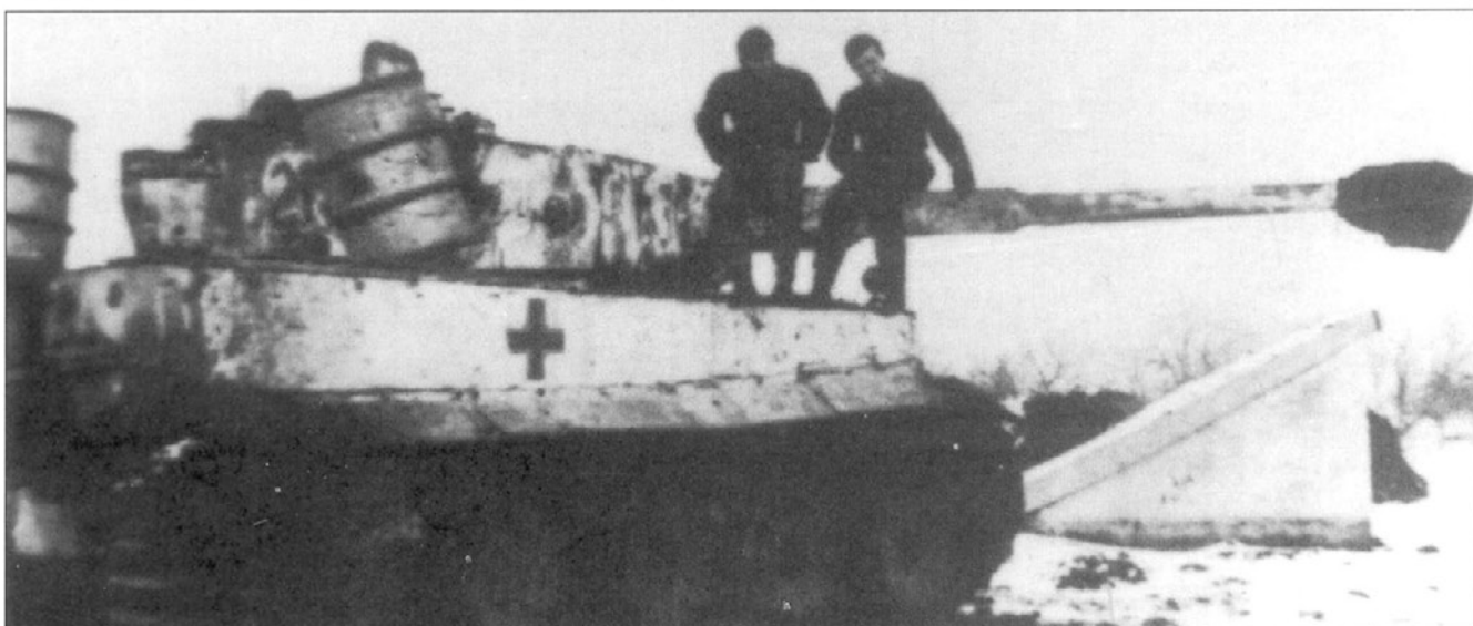
«Тигр» с бортовым номером «212» из 2-й роты 503-го тяжелого танкового батальона. Обратите внимание на укрепленные на крыше моторного отделения две 200-литровые бочки с горючем. Батальон включал в этот период две танковые роты, на вооружении которых помимо «Тигров» находились танки Pz.Kpfw III и Pz.Kpfw IV.
