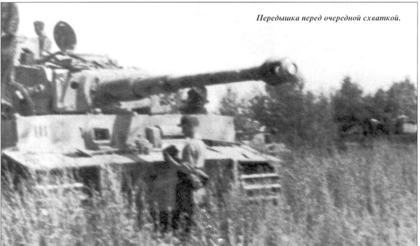
При перевозке танков «Тигр» по железной дороге боевые гусеницы приходилось менять на более узкие транспортные (лежат перед танком). Обратите внимание на три вертикальные полосы на лобовом бронелисте корпуса справа - эмблема дивизии СС «Мертвая голова».
