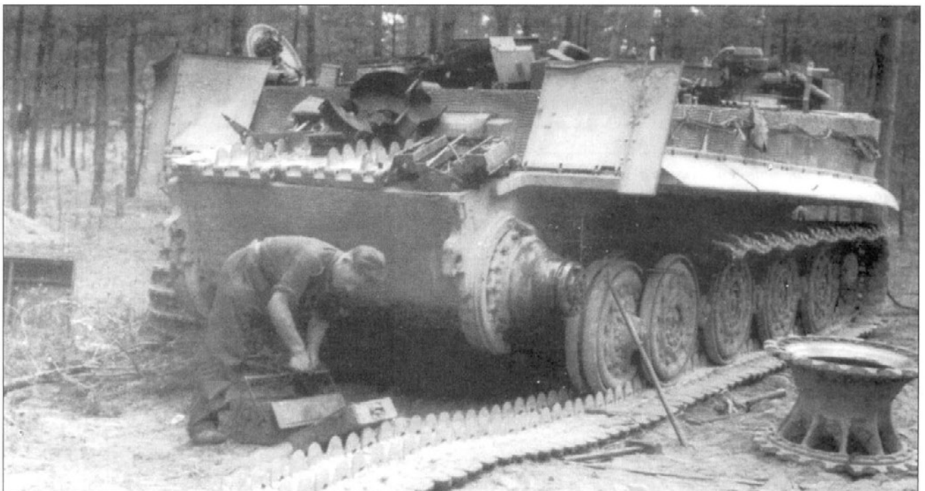
Установка башни на «Тигр». Обратите внимание на приваренную к вертикальному лобовому бронелисту корпусу подкову на счастье. Танк принадлежит s.Pz-Abt.505.
