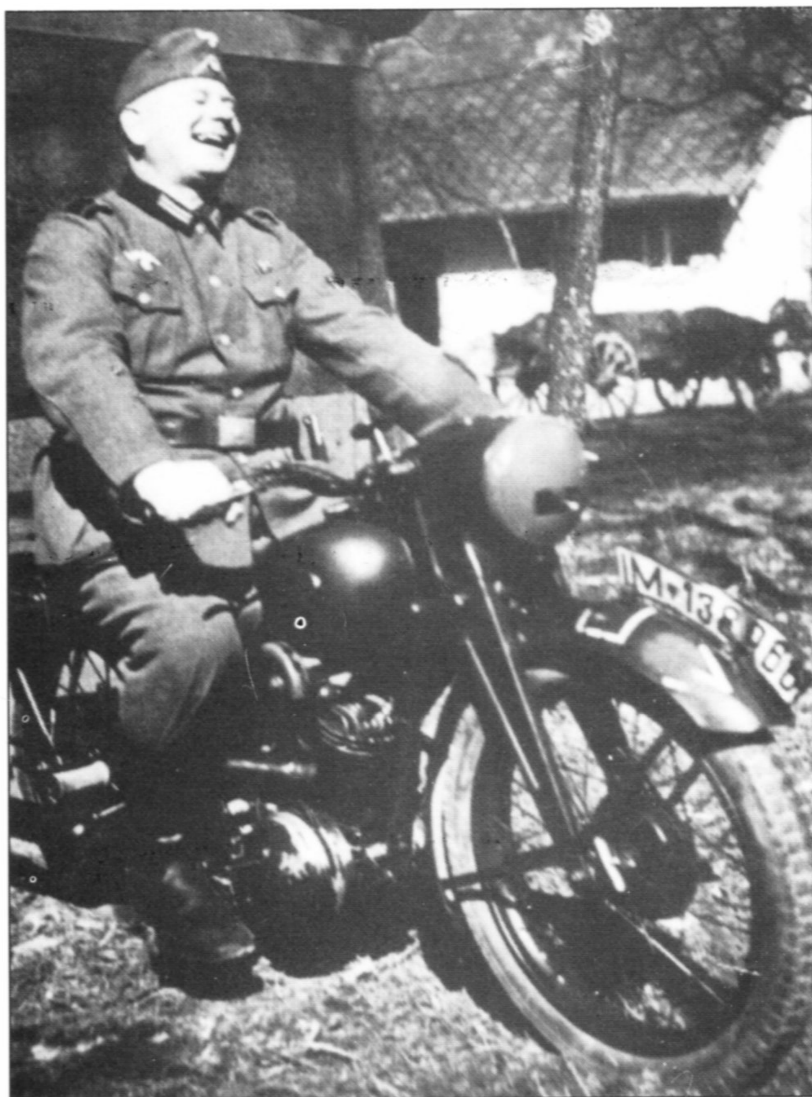
Веселый солдат сидит на реквизированном Ardie с 125-кубовым двигателем. Гражданский регистрационный номер (серия «IM» относится к Саксонии). На переднем крыле белой краской нанесены буквы «WH», чтобы обозначить принадлежность мотоцикла к вермахту. Выхлопная труба, выходящая из задней части цилиндра, - обычная черта мотоциклов этой марки.
