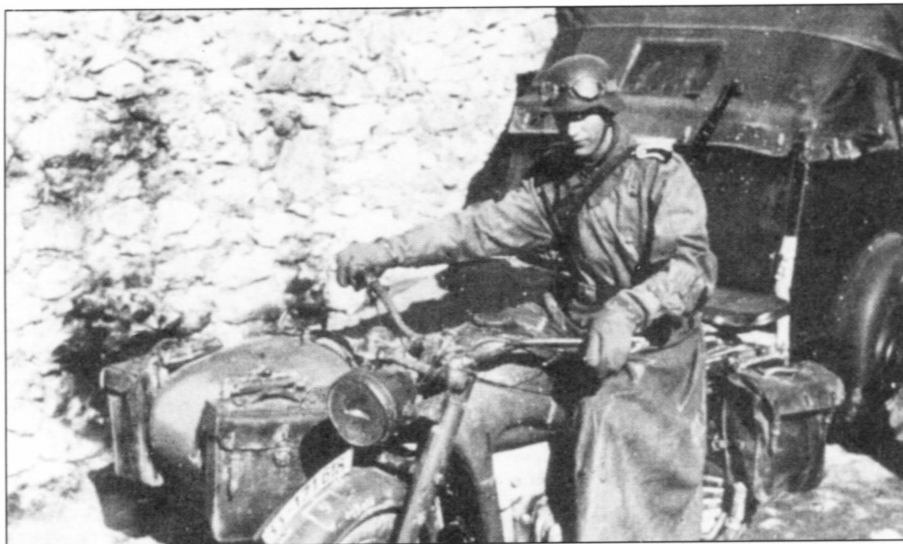
Zuendapp KS750, видны многие детали мотоцикла, в том числе три седельные сумки.
