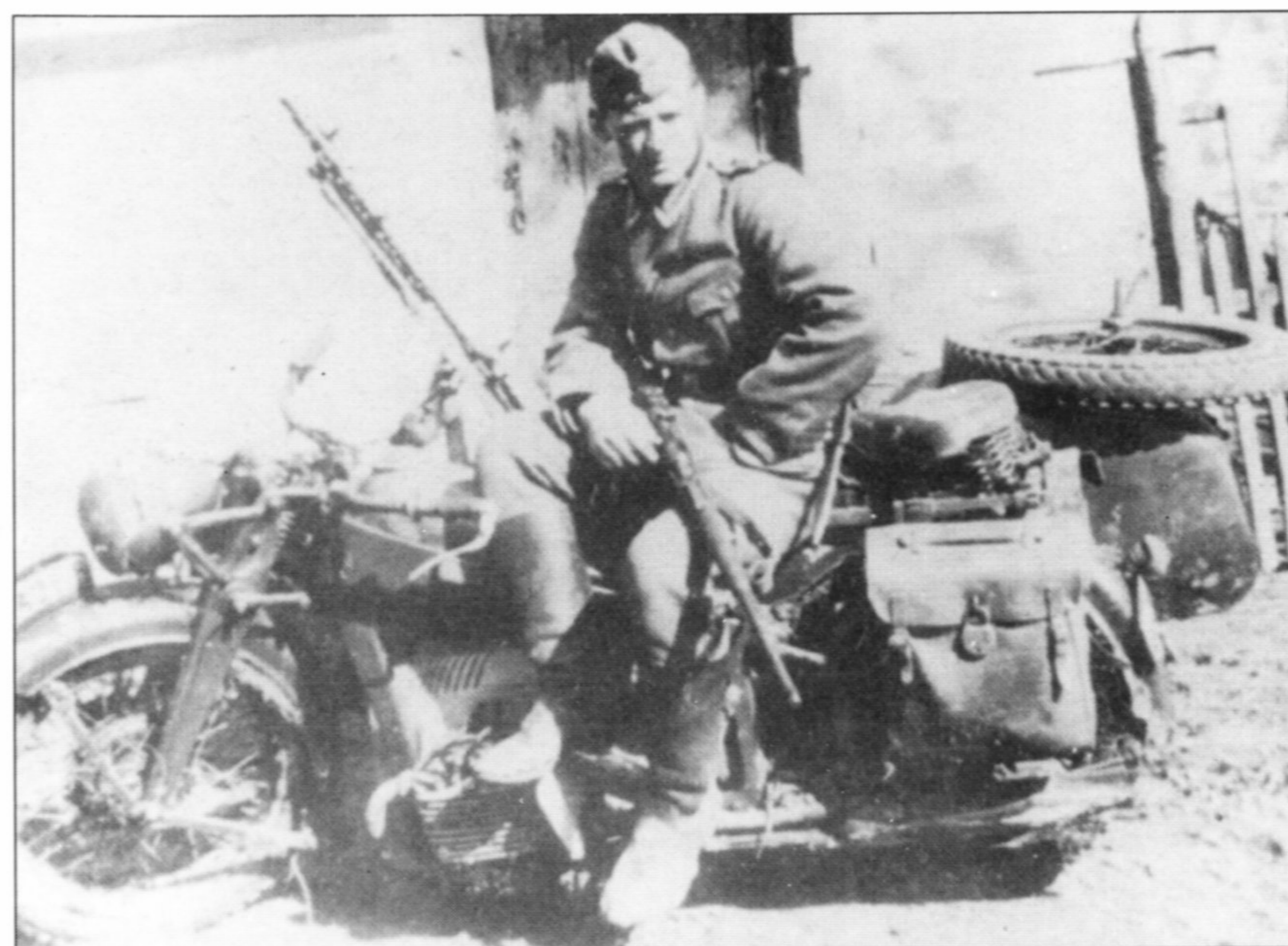
На раскисших дорогах мотоциклы с коляской безнадежно вязли в грязи, как этот BMW R 75 из штаба пехотной бригады. Привод на колесо коляски помогал мало.
