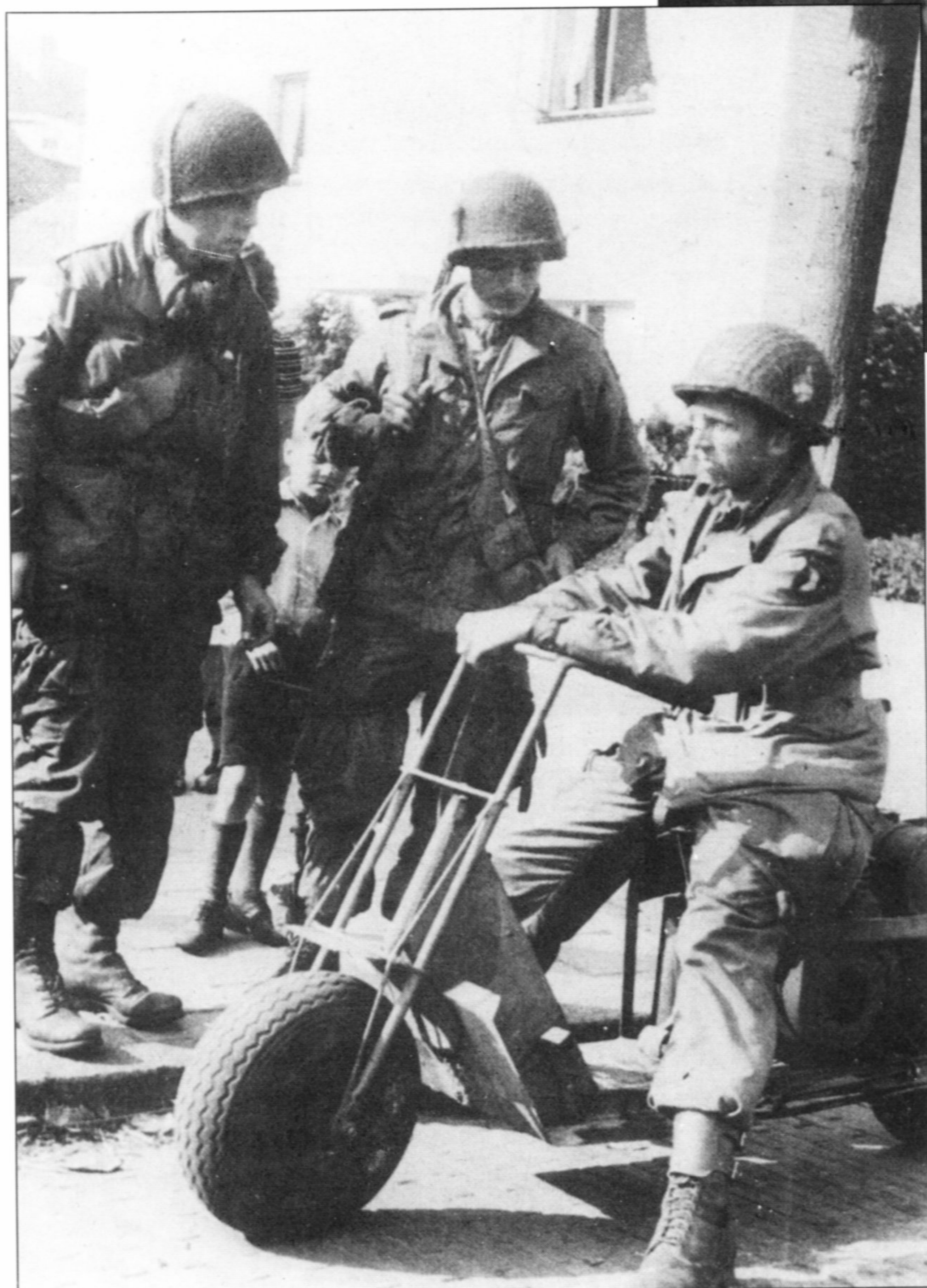
Мотороллер Cushman оснащался одноцилиндровым четырехтактным 244-кубовым двигателем. Машина имела грубую и примитивную конструкцию, но обеспечивала парашютистам высокую мобильность после приземления.
