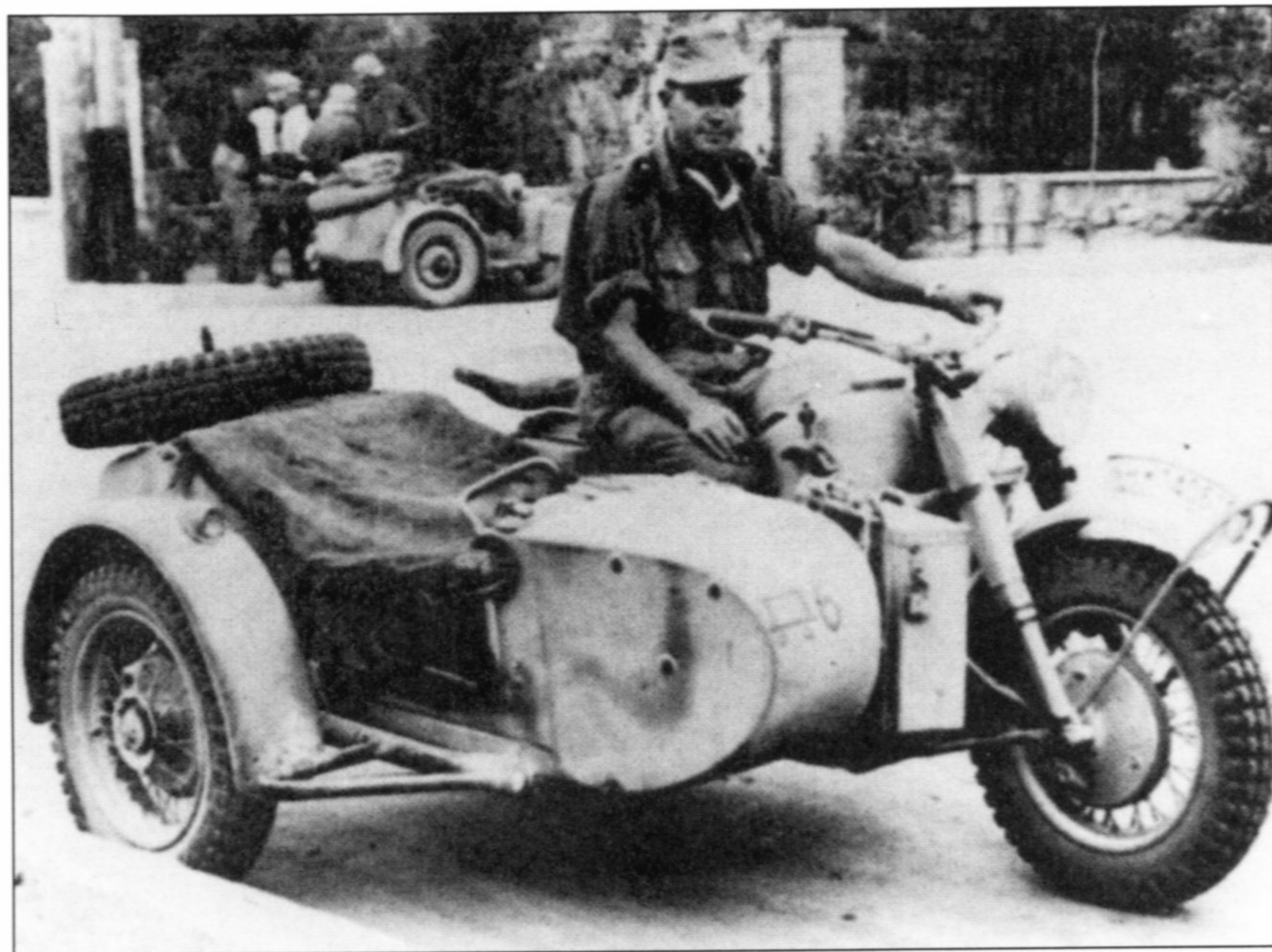
BMW R 75 позднего выпуска. Мотоцикл окрашен в темно-желтый цвет, переднее крыло узкое. Над бензобаком виден усиленный тропический фильтр. Бортовая ручка коляски отломана.
