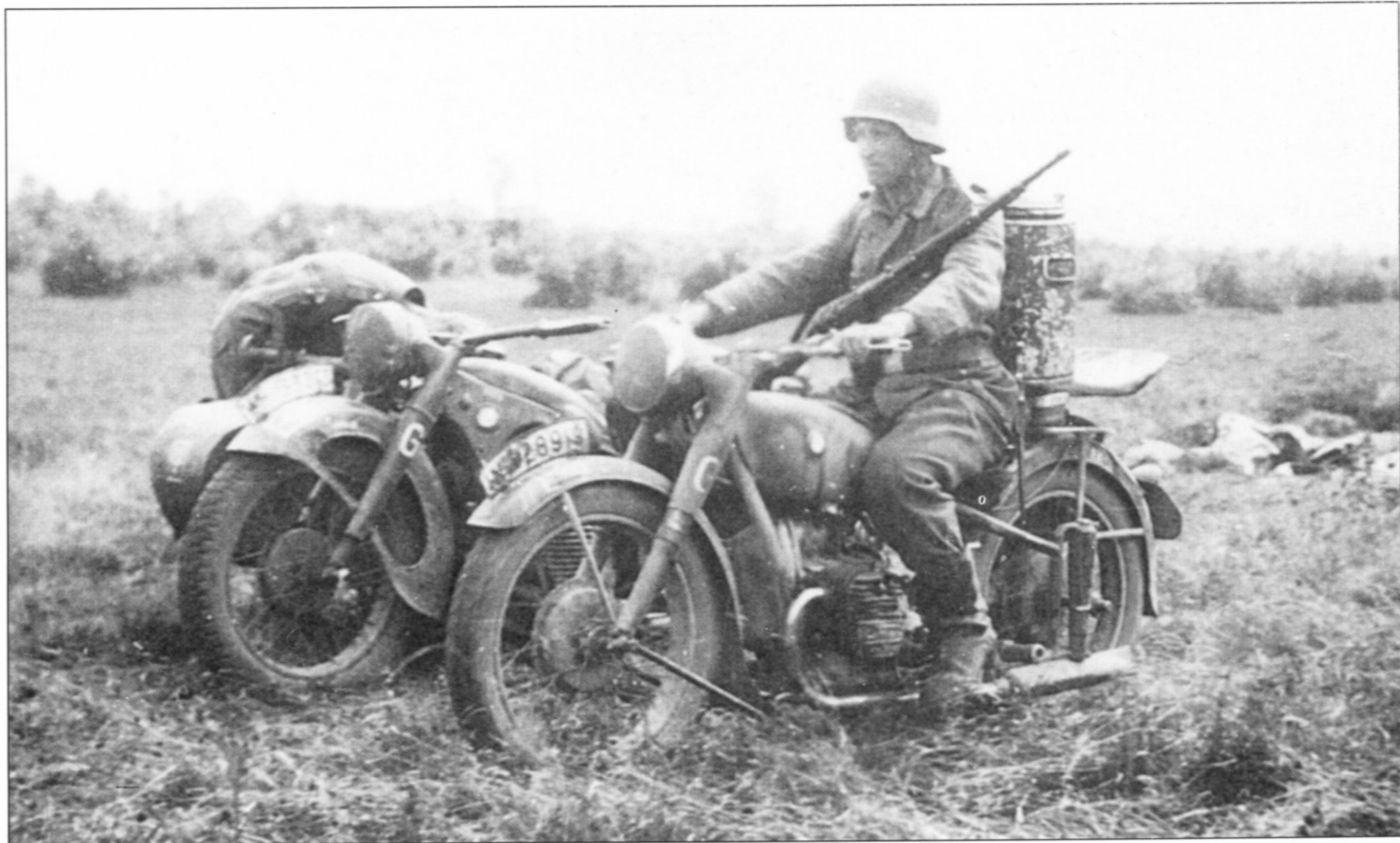
Развозчики продовольствия из танковой группы «Guderian». Справа водитель на BMW R 61 несет за спиной термосы с горячей едой. За ним BMW R 12. Видно широкое переднее крыло мотоцикла.
