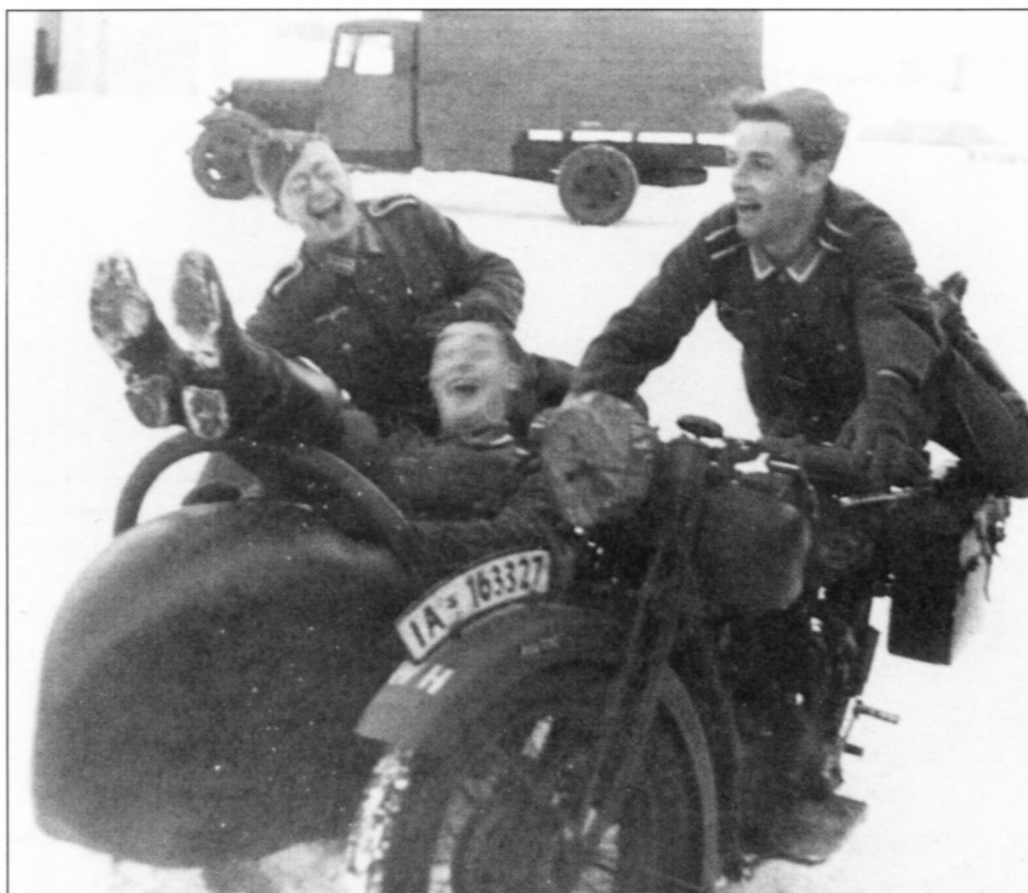
Веселые унтер-офицеры катаются на реквизированном мотоцикле NSU 501/601T с коляской («IA» - район Берлина). Фара закрыта импровизированным светомаскировочным чехлом.
