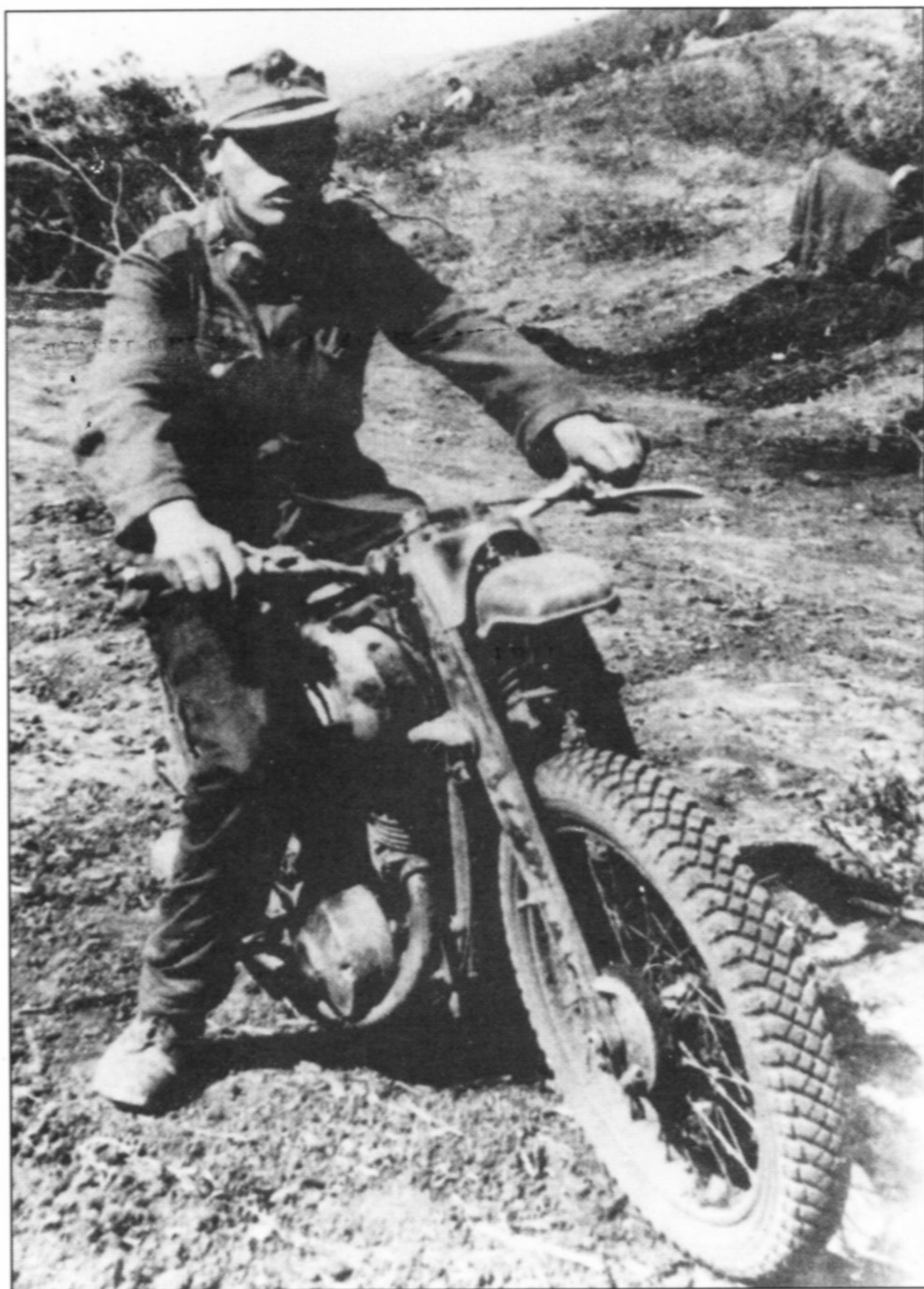
На переднем колесе этого DKW NZ350 виден новый внедорожный протектор. Крыло и фара повреждены в ходе боевых действий. Двухцветная окраска бензобака говорит о том, что это реквизиционная машина.
