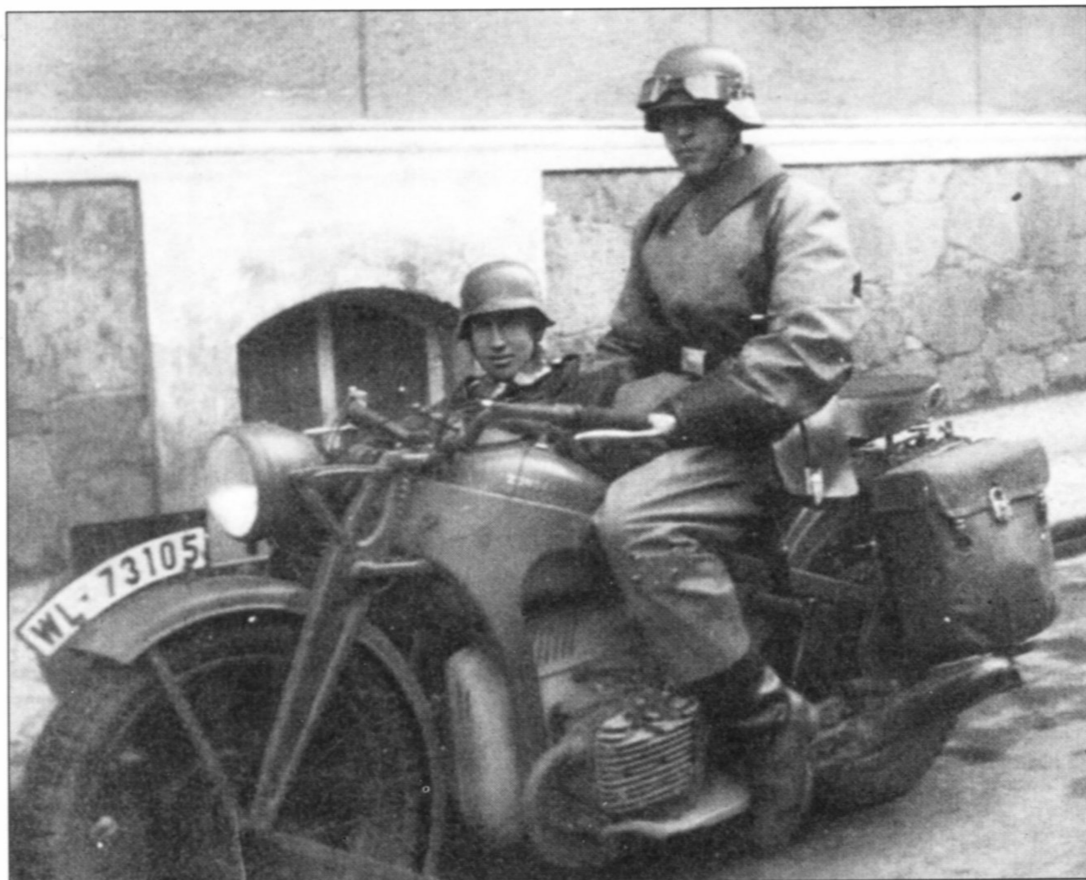
Тяжелый Zündapp K800W с тропическими кожаными седельными сумками. Мотоциклы этого типа почти всегда оснащались коляской. Однако шины мотоцикла оказались слишком узкими для бездорожья.
