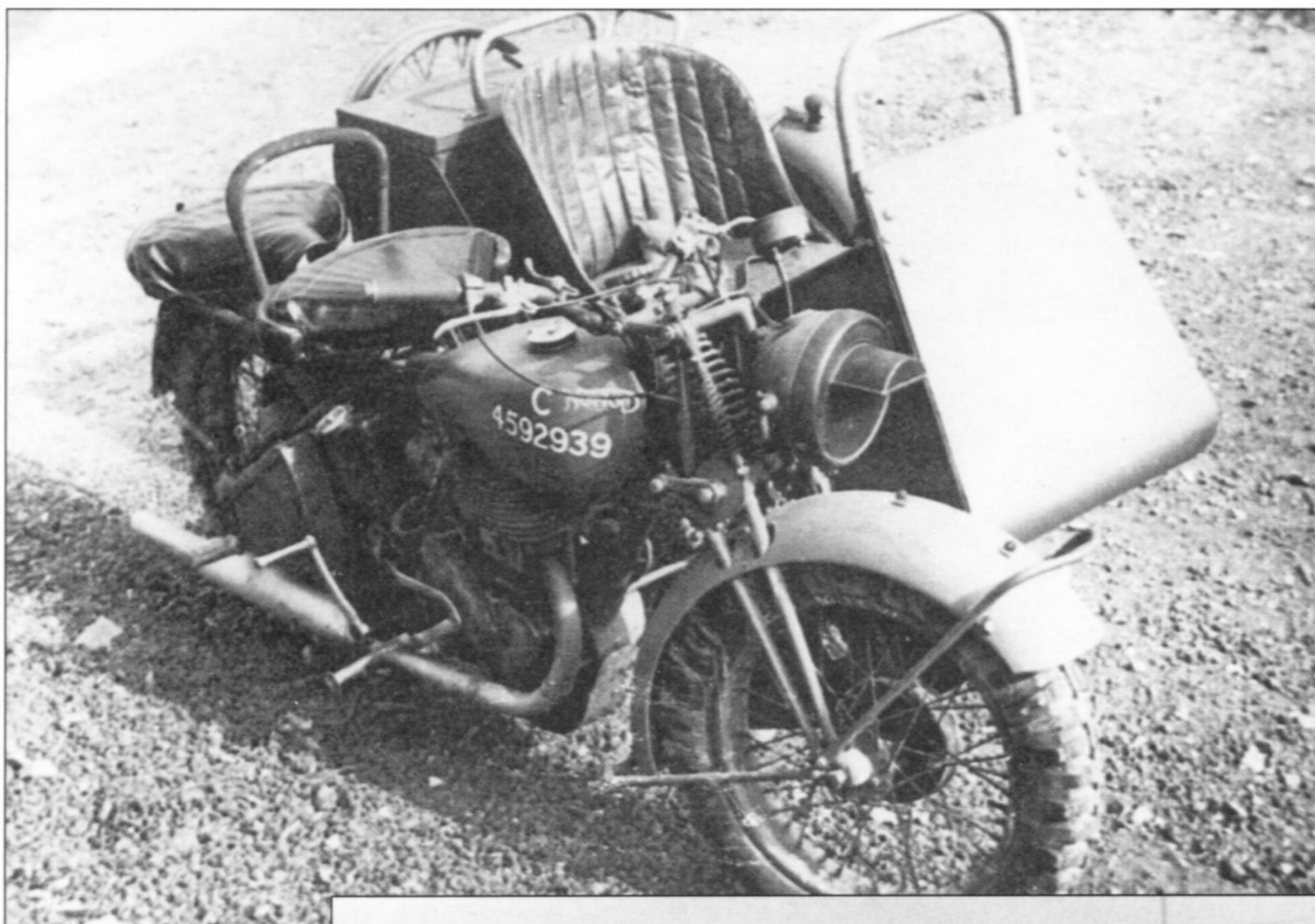
Английский Big Four, созданный на базе Norton'a. Машина использовалась для разведки. Привод колеса коляски можно было включить или выключить одним движением руки.
