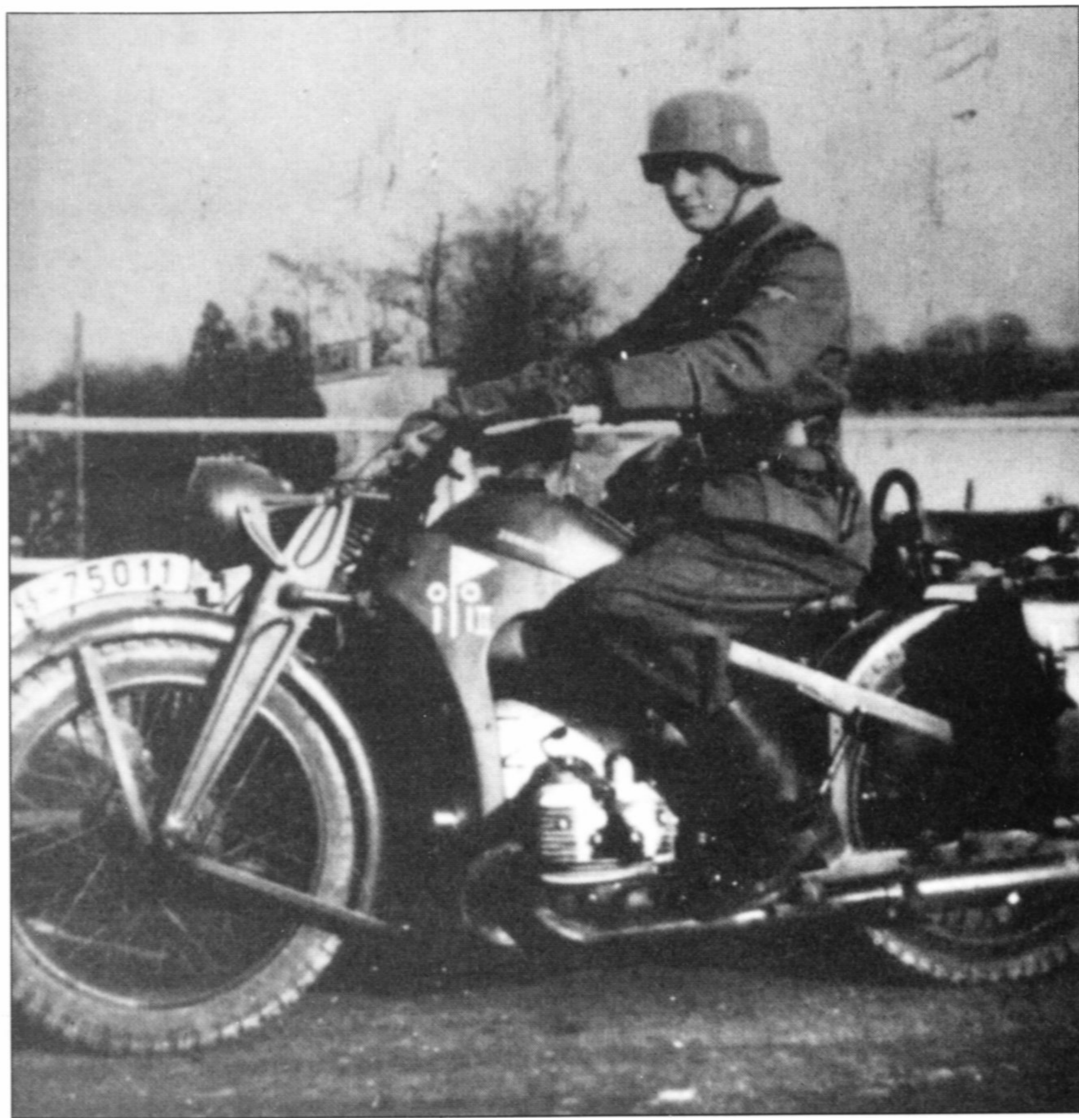
Курьер из II. дивизиона артиллерийского полка дивизии LSSAH на Zündapp KS600W. Мотоциклы серии «600» начали поступать в войска в 1937 году. Это была еще не идеальная модель. От гражданского варианта армейский мотоцикл отличала серая окраска, светомаскировка на фаре и седельные сумки.
