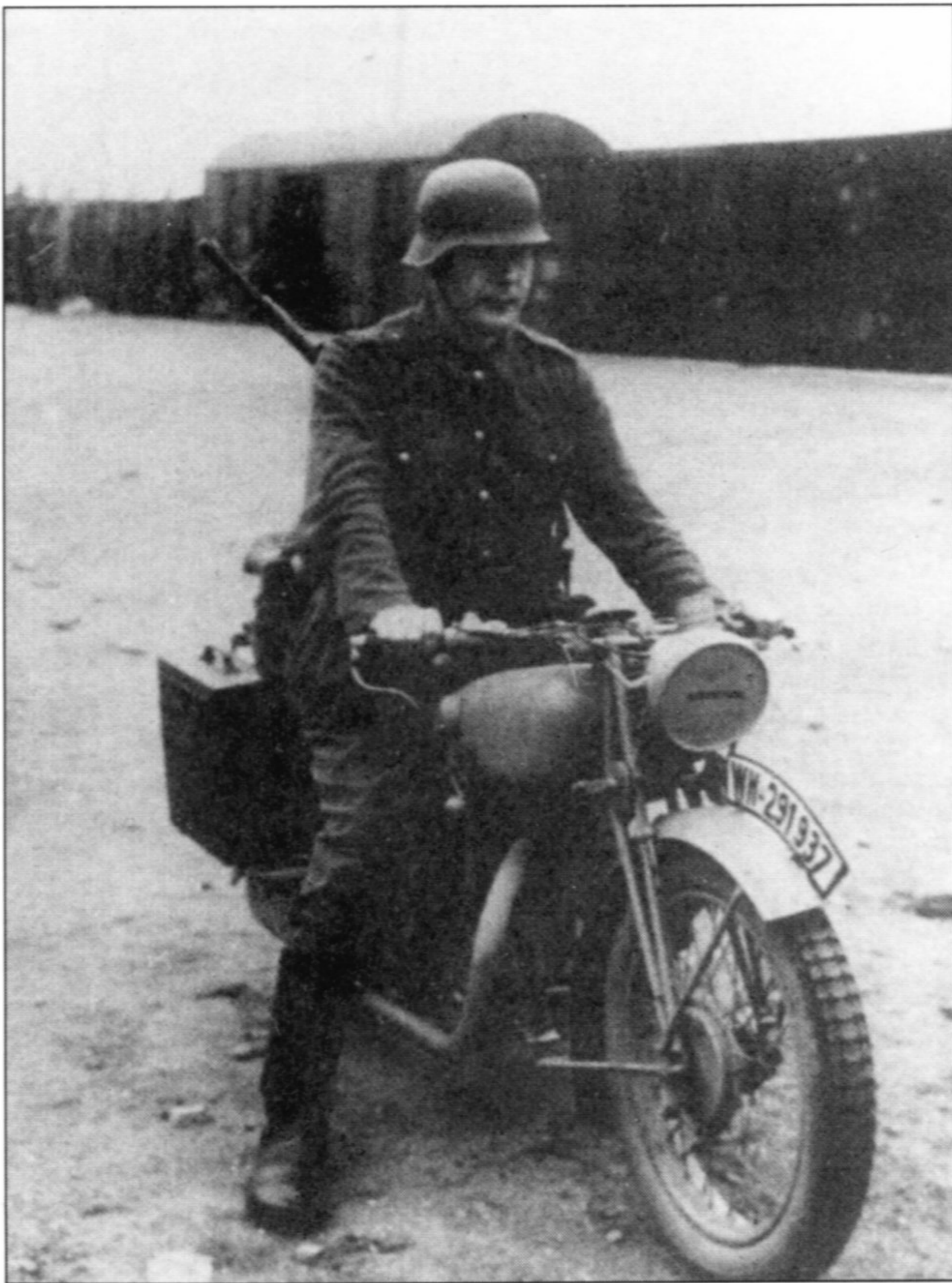
Курьер на NSU 501OSL, 1936 года выпуска. Это армейский вариант мотоцикла, что видно по фаре.
