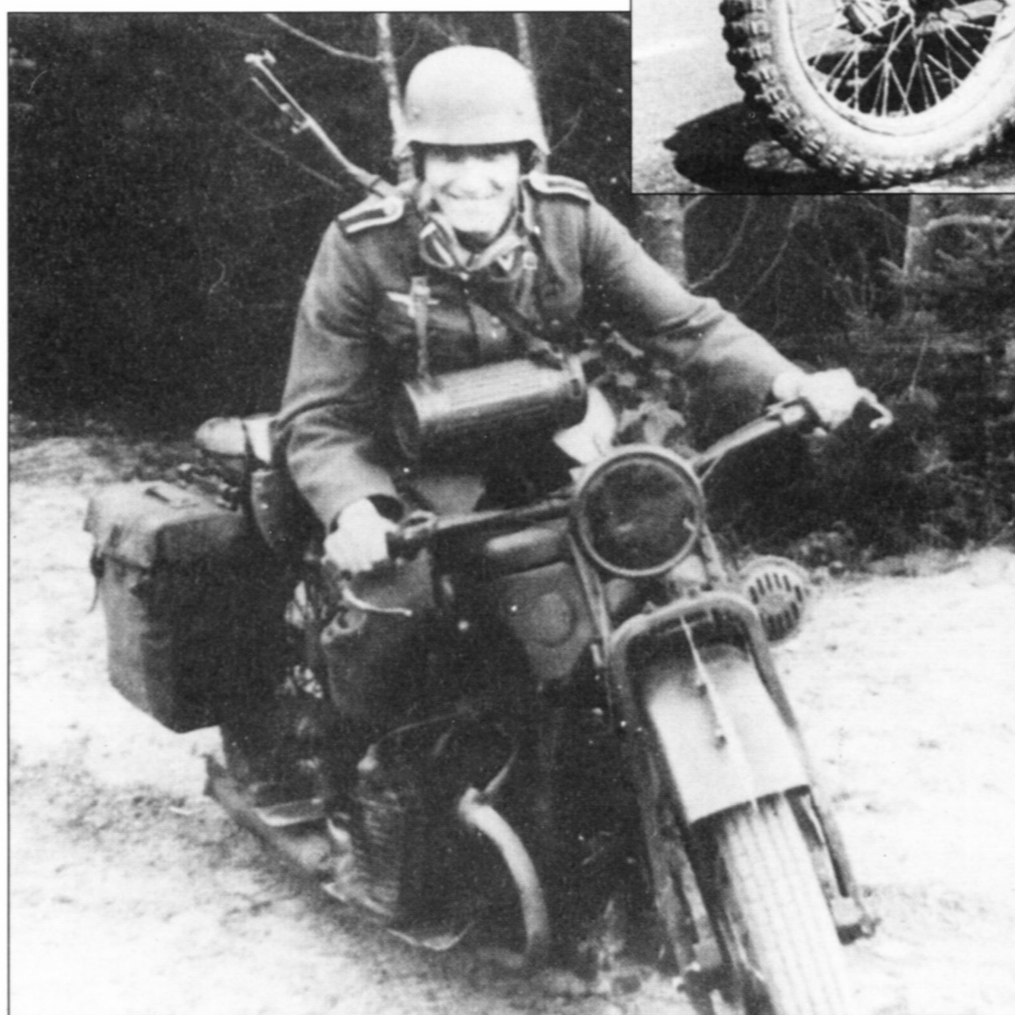
Унтер-офицер на реквизированном BMW R11. Обратите внимание на звуковой сигнал на левом боку. У армейской модификации мотоцикла эта деталь отсутствовала.
