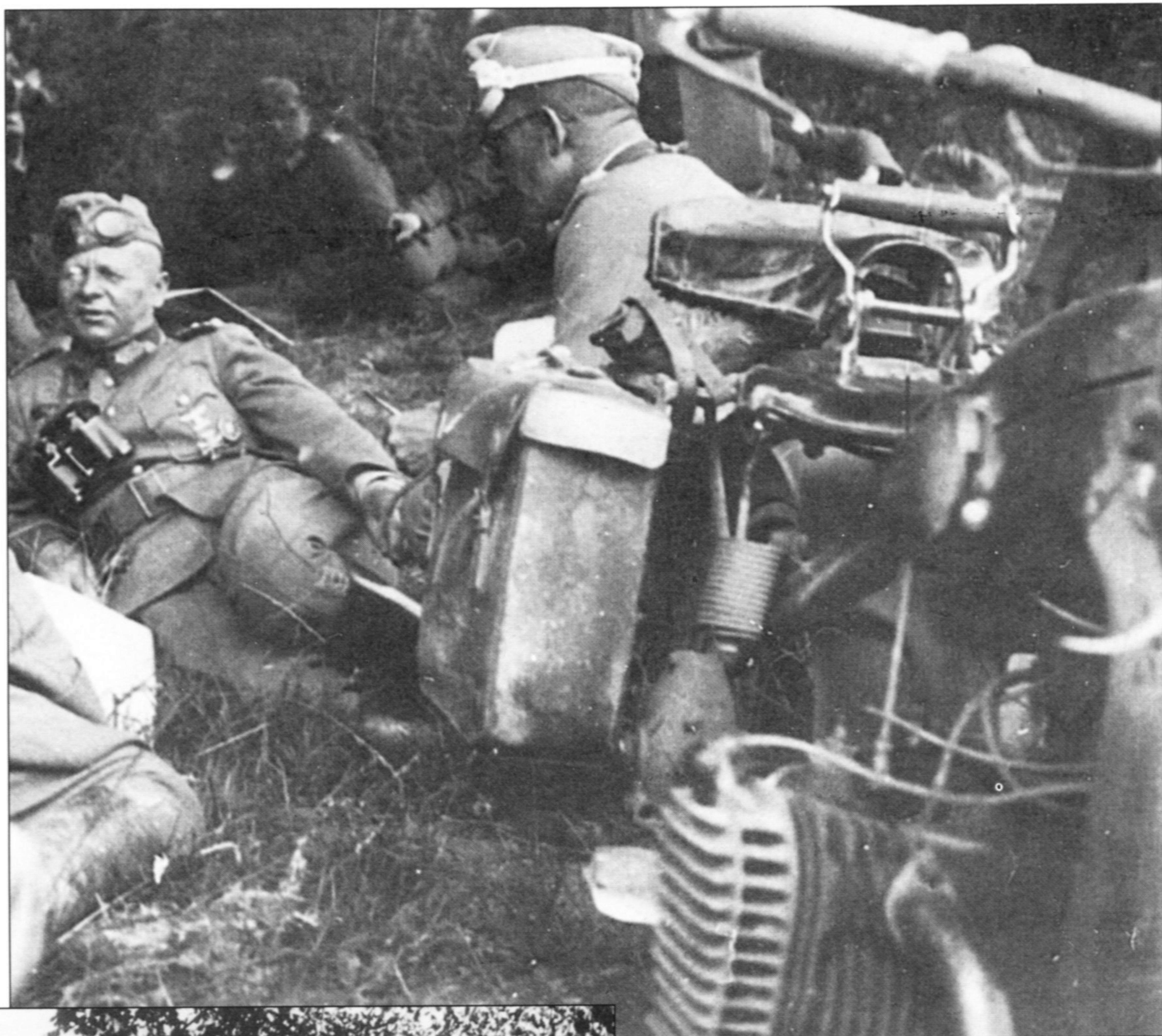
BMW R 12 крупным планом. Видны правый цилиндр, седло, часть правой подножки и пружина подвески водительского седла.
