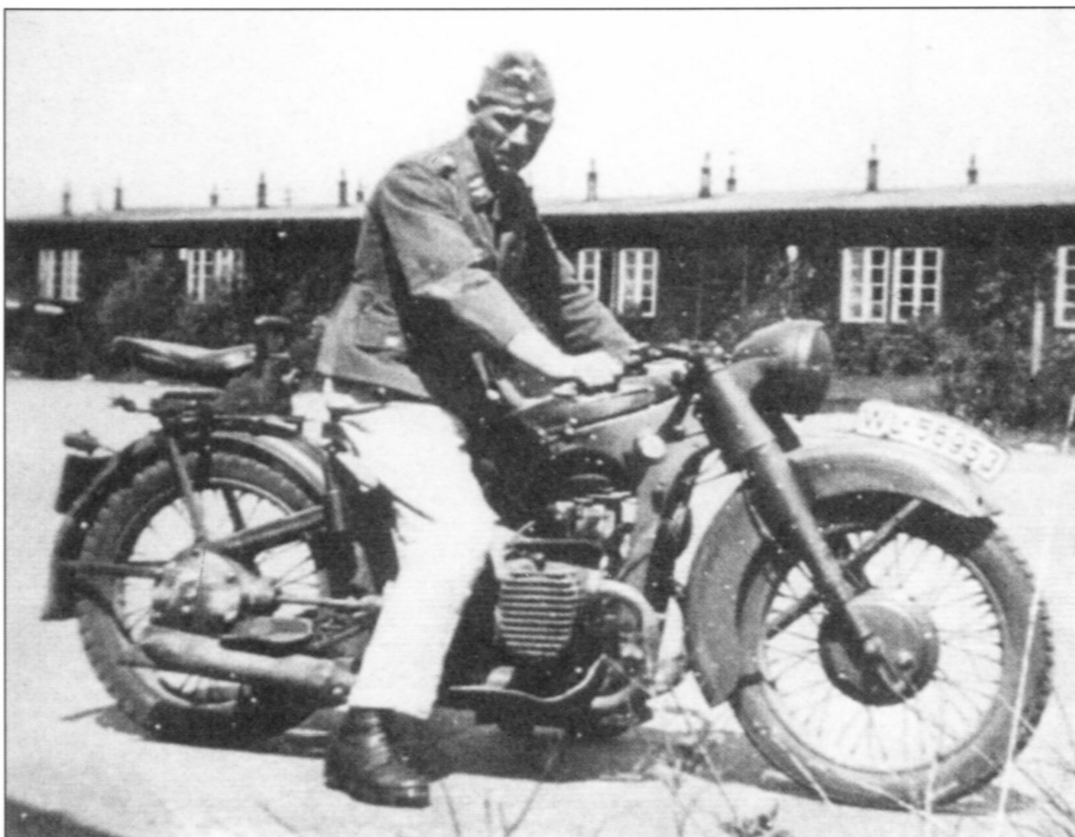
BMW R 35 легко узнать. Он заменил BMW R4 и оснащался телескопической вилкой. В период с 1937 по 1940 год было выпущено более 1500 машин этого типа. Большинство из них были закуплены вермахтом.
