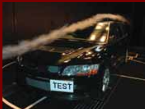
実車風洞試験設備での入念なチェックによりフロントアンダースポイラーとリヤウィングの共着でフルに空力性能を発揮するよう設計
