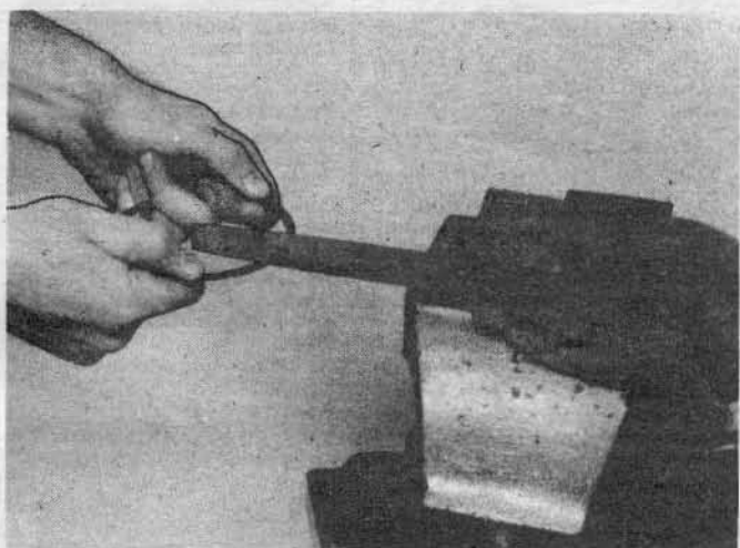
Рис. 21.5 Исправление малого зазора. Применяйте напильник с односторонней насечкой.
