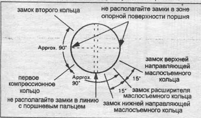
Рис. 24.5 Положение замков колец на поршне
