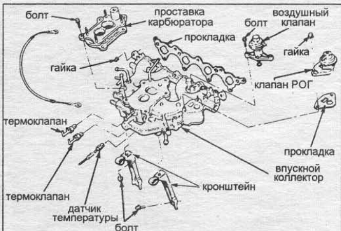
Рис. 5.5 Сборка типичного впускного коллектора (карбюраторные модели).
