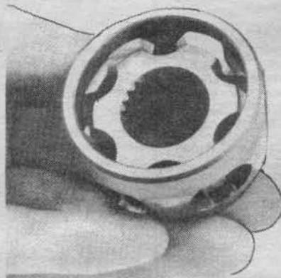
Рис. 9.10а Поверните внутреннее кольцо до совпадения зубьев с отверстиями в сепараторе...
