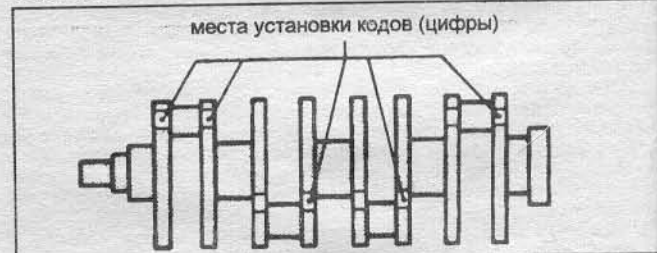
Рис. 19.11 Коды размеров коренных шеек коленвала.
