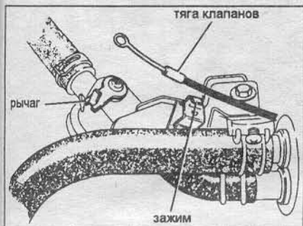
Рис. 12.5в Тяга управления краником отопителя расположена около хомутов шлангов.
