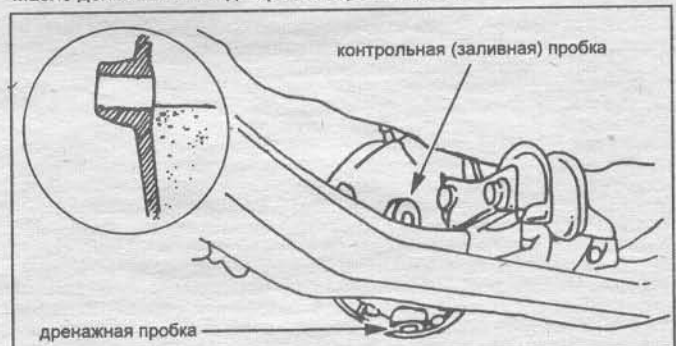
Рис. 23.2 Расположение пробок заднего дифференциала.
