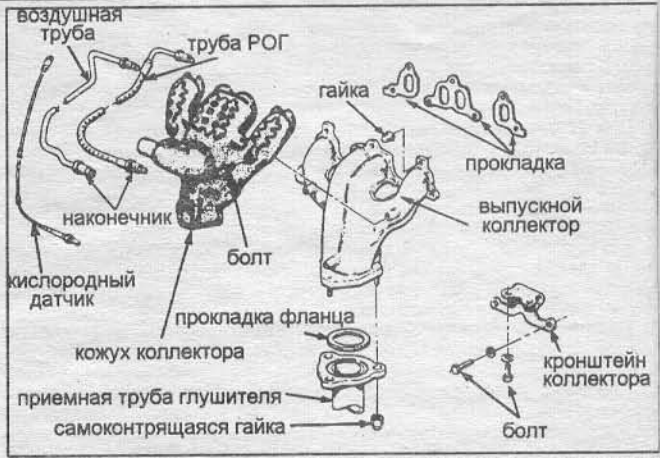
Рис. 6.3а Сборка типичного выпускного коллектора (карбюраторные двигатели).
