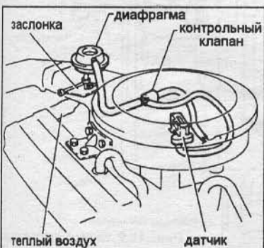
Рис. 11.1 Схема системы контроля за температурой воздуха на впуске.
