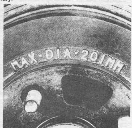
Рис. 5.5 Маркировка максимального внутреннего диаметра барабана.
