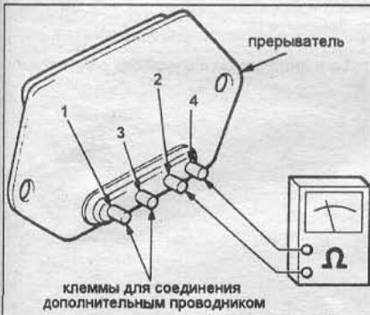
Рис. 8.8. Для проверки прерывателя TOYO DENSO измерьте напряжение между клеммами синей (1), (4) и "массой" и между клеммой черной (2) и "массой". Затем закоротите клеммы синюю (2), (1) и зеленую (3) и проверьте проходимость тока в обоих направлениях между черной (2) и синей (1), (4) клеммами.
