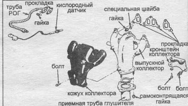
Рис. 6.3б Сборка типичного выпускного коллектора (двигатели с впрыском бензина).
