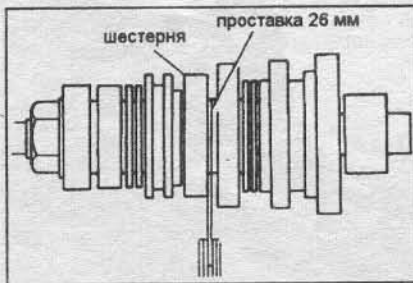
Рис. 6.68в Измерение осевого зазора шестерни 3-й передачи.
