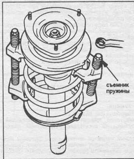
Рис. 3.4 Установка съемника на пружину стойки.
