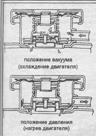
Рис. 1.3 Пробка радиатора.
