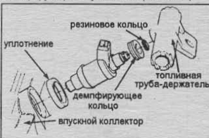
Рис. 15.13 Сборка многоточечной схемы впрыска.
