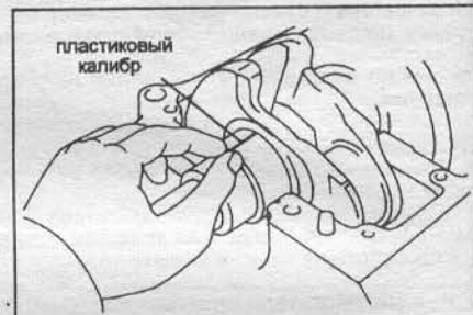
Рис. 22.11 Положение пластикового калибра на шейке для измерения зазора.
