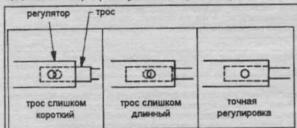
Рис. 4.12 Регулировка длины троса переключения.
