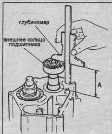
Рис. 6.117 Измерение высоты расположения подшипника (размер А равен высоте задней крышки).
