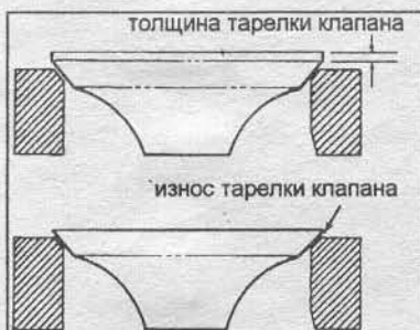
Рис. 9.15 Толщина тарелки клапана должна быть не меньше чем приведено в спецификации. В противном случае клапан необходимо заменить.
