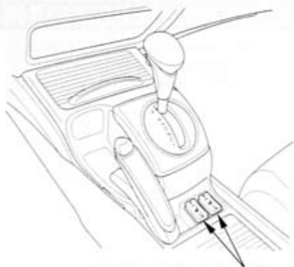
КНОПКИ ВЫКЛЮЧАТЕЛЕЙ ЭЛЕКТРОПОДОГРЕВА СИДЕНИЙ
