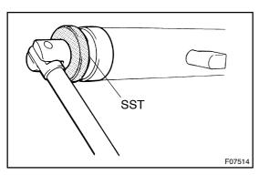
(d) Using SST, torque the cylinder end stopper.
