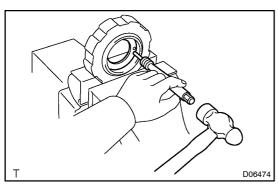
(d) Using a pin punch and hammer, remove the front side retainer.
