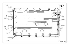
(d) Install the oil pan with the 19 bolts.
