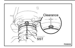
(d) Using SST, adjust the clearance of the clamp. SST 09240-00020 (09242-00080)
