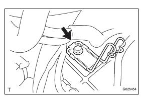
(d) Remove the bolt and transmission control cable bracket No.2.
