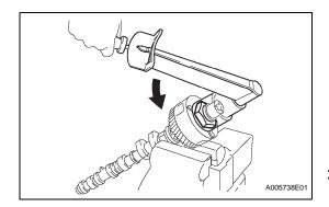
(d) Using snap ring pliers, install the snap ring.
