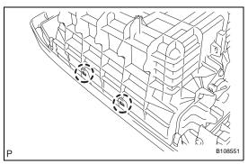
(d) Disengage the 2 claws and remove the console box sub-assembly upper.
