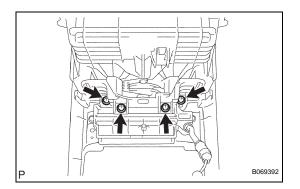
(d) Install the 4 screws and the console box sub-assembly upper.
