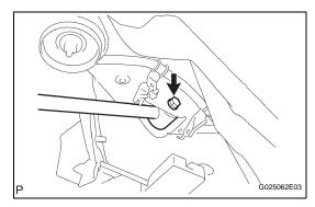
(b) Fully tighten the bolt.
