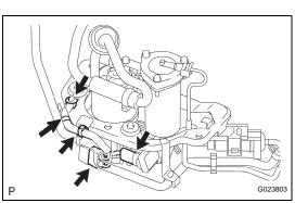
(d) Install the 3 clamps and the 2 connectors.
