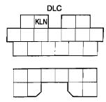
COMPONENT SIDE CONNECTOR (VIEW FROM TERMINAL SIDE)
