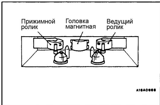
**С-7 Неисправность автоматической обратной перемотки**
