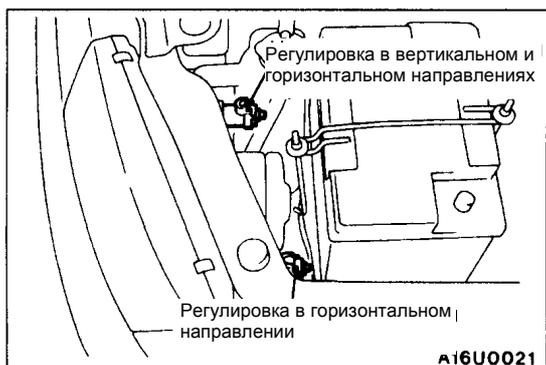
4. Чтобы отрегулировать положение фар поочередно заворачивайте регулировочные винты.
