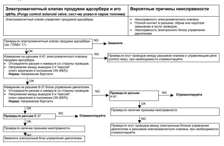
Замените электронный блок управления двигателем.
