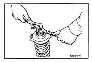
Удерживая ключом шток амортизатора, отверните самоконтрящуюся гайку.
